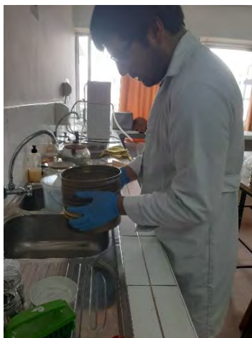
Tamizado en húmedo de muestra de suelo rizosférico en batería de tamices
