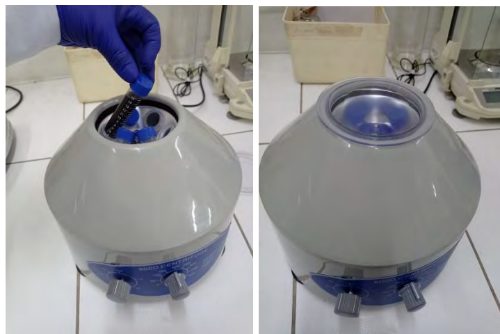
Centrifugación de las muestras aforadas con sacarosa al 70% a 15 ml
