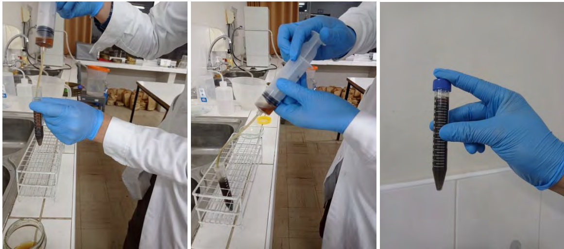
Adición de solución de sacarosa al 70% al sedimento
