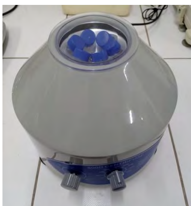
Centrifugación de las muestras aforadas con agua destilada a 15 ml
