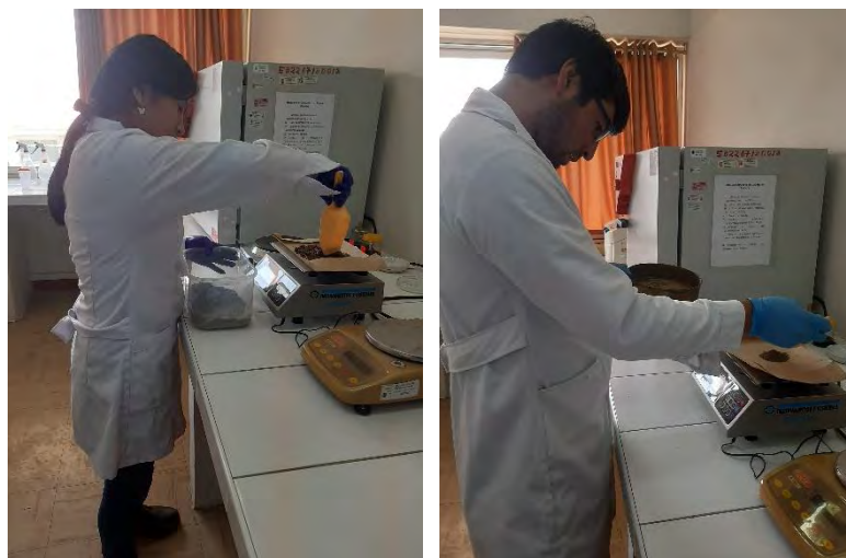
Pesaje de muestra tamizado en seco a 2 mm
