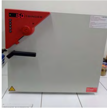
Muestra de suelo secado en estufa para determinar humedad
