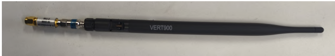
Figura 11 Antena VERT900 y atenuadores.
