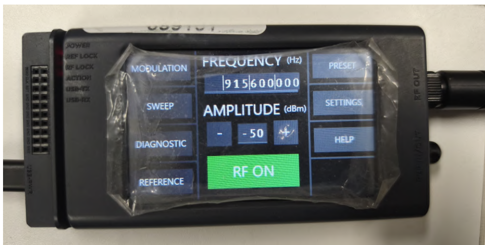
Figura 29 Generador ERASynth Micro configurado para producir interferencia CW co-canal a 915.6 MHz.
