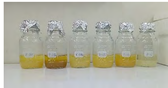
Separación de MPs por flotación en solución salina hipersaturada
