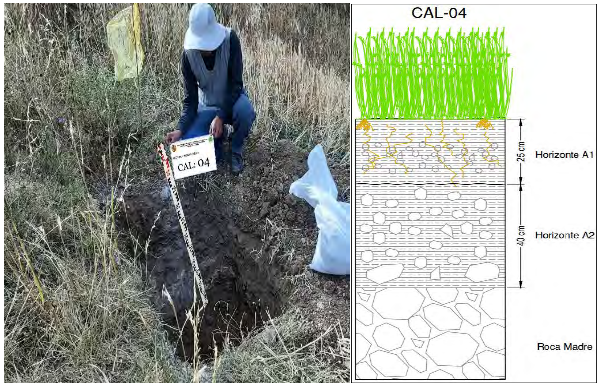
Fotografía 5 Muestreo, descripción y perfil de la Calicata C-04
