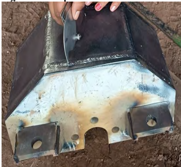
Figura 105. Soporte de Rueda fabricado de acuerdo a plano MC-PT-106.
