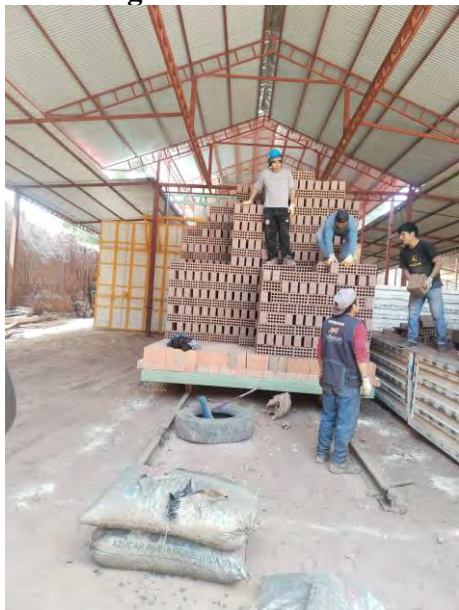
Figura 159. Carguío de ladrillo en la Plataforma sobre rieles.
