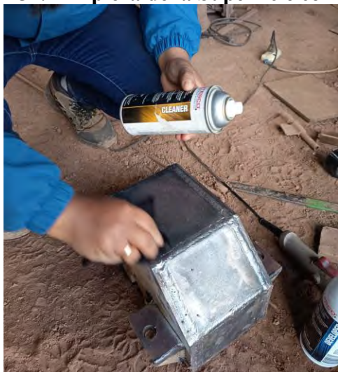
Figura 151. Limpieza de la Superficie con Cleaner.
