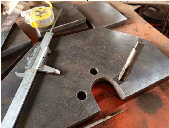
Figura 128. Enroscado de la plancha con Macho de roscar de 1/2"-13UNC
