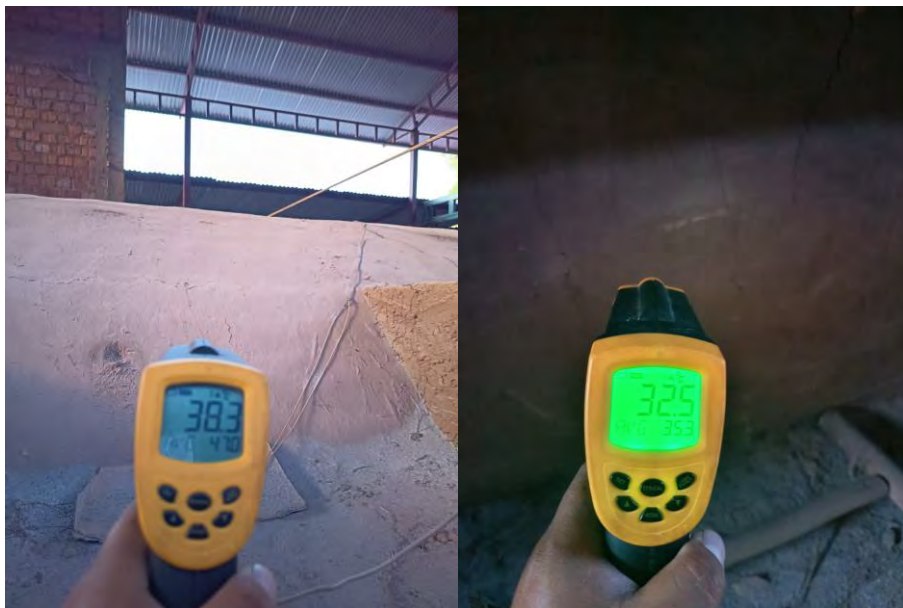
Figura 17. Temperatura de pared exterior
