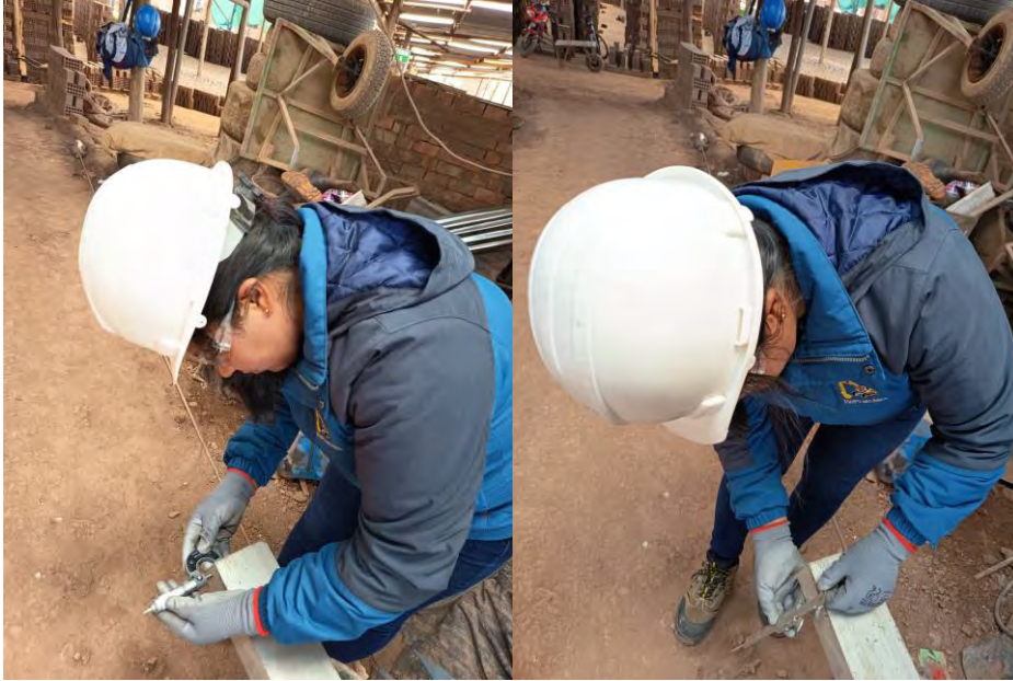
Figura 141. Control dimensional de canal U, con micrómetro y vernier.
