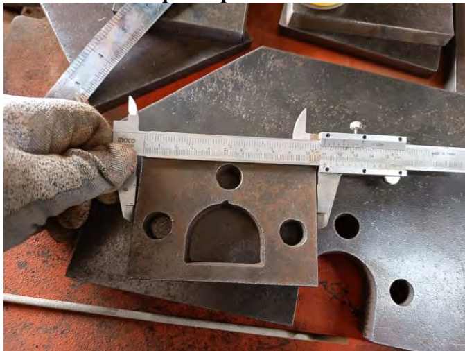
Figura 134. Placa de Tope después de corte en Plasma.
