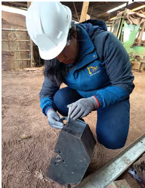
Figura 144. Control dimensional de espesores de planchas.
