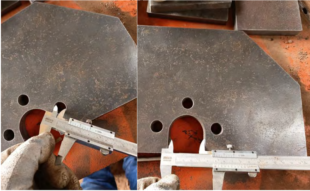
Figura 142. Control dimensional de agujeros con vernier.
