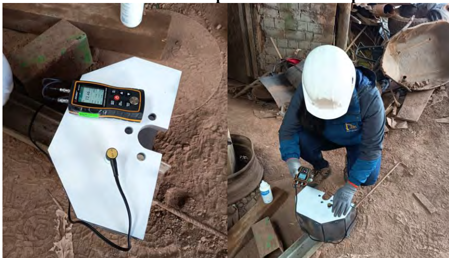
Figura 145. Control con medidor de espesor de materiales por ultrasonido.
