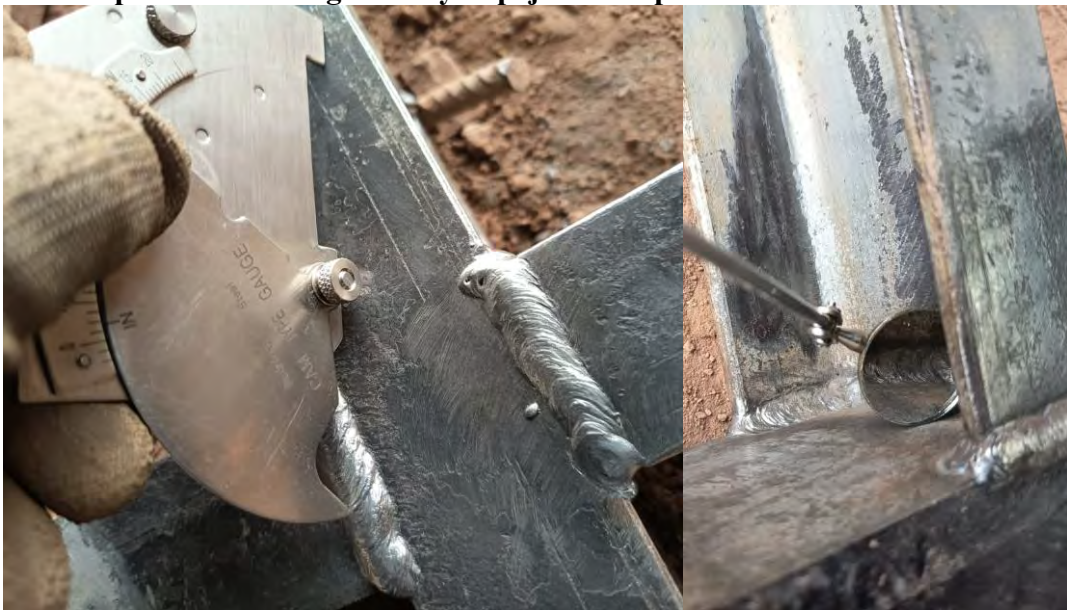
Figura 148. Inspección con Brigdecam y Espejo telescópico.
