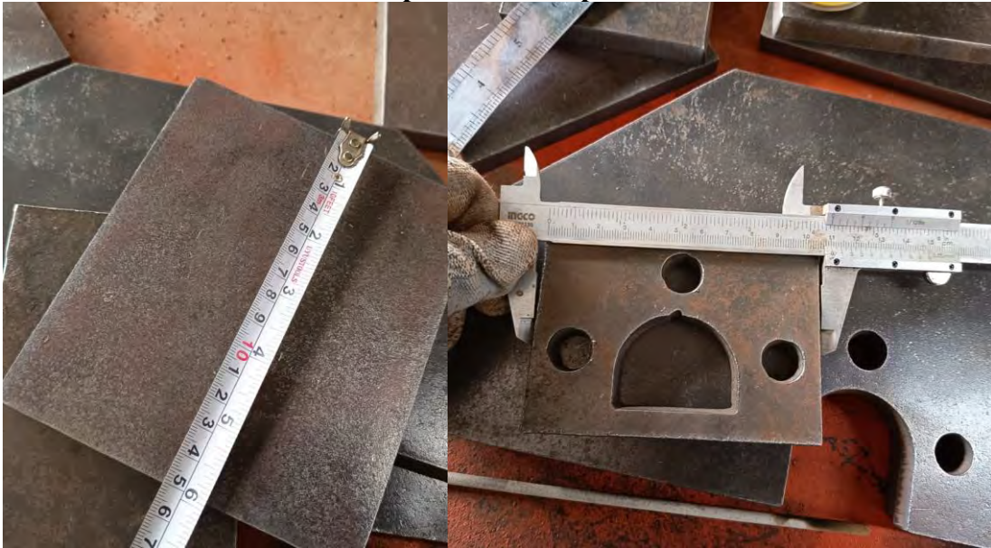
Figura 143. Control dimensional de las panchas del soporte de rueda.
