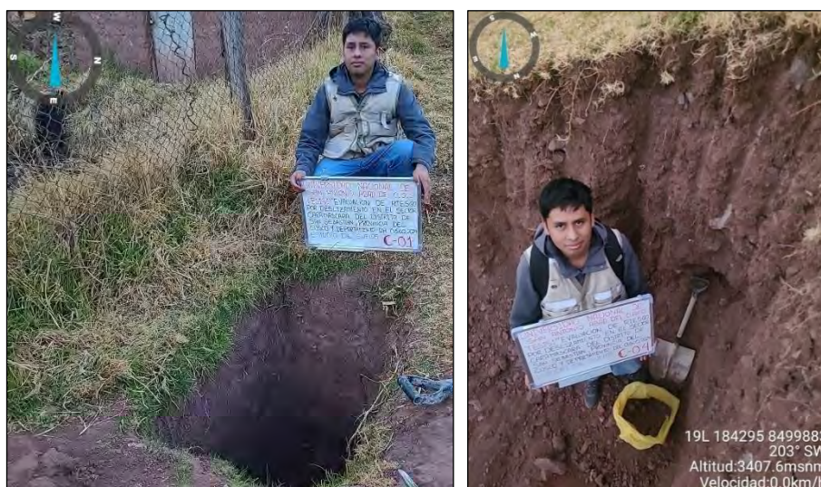
Figura 58: Extracción de muestras de suelo en calicatas y cortes de ladera
