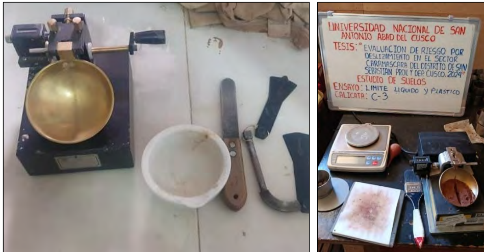
Figura 60: Cuchara de Casagrande y ensayo de limite liquido
