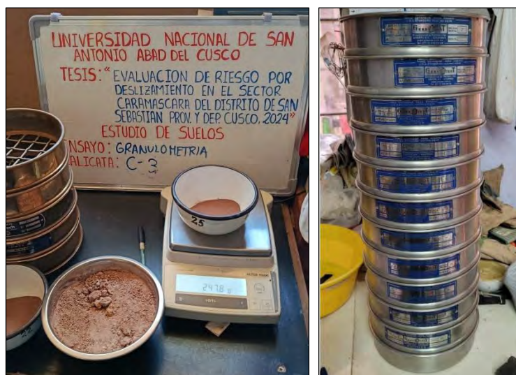
Figura 62: Serie de tamices para el ensayo de granulometría
