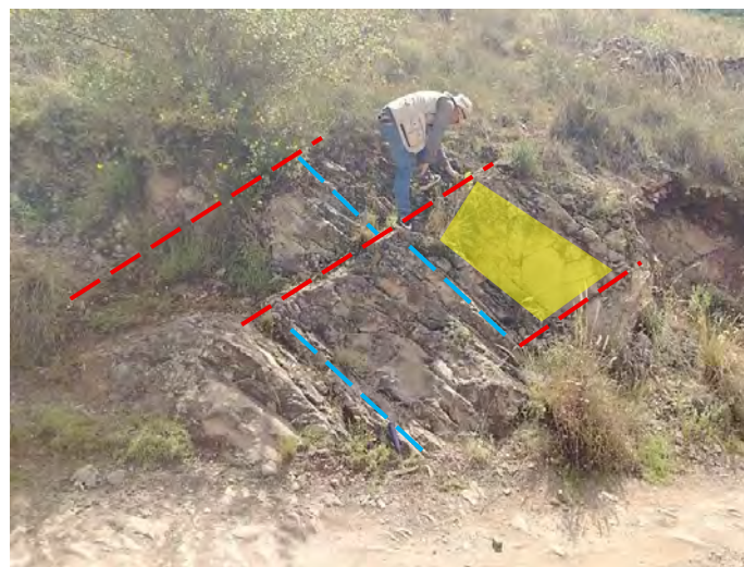
Figura 54: Familias de discontinuidades en el punto 4, se observan los planos de la familia 1 (rojo), familia 2 (azul) y familia 3 (amarillo)
