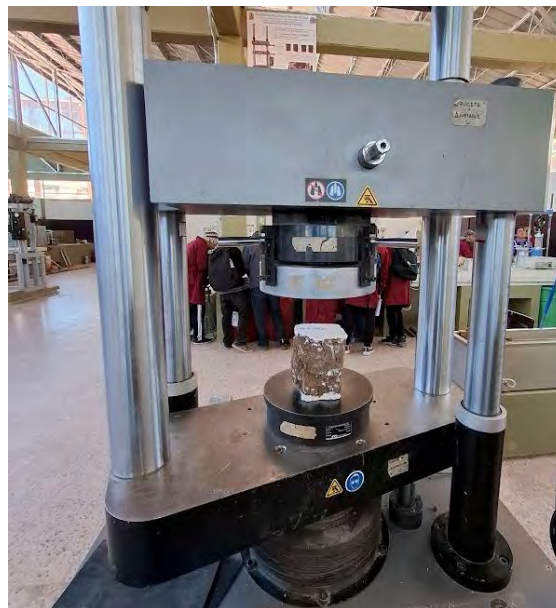
Fotografía 22 Rotura de bloques de adobe para obtención de la resistencia a compresión del bloque de adobe original.
