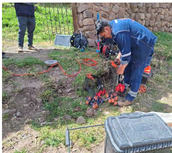
Fotografía 23 Preparación para el ensayo de MASW 1 D
