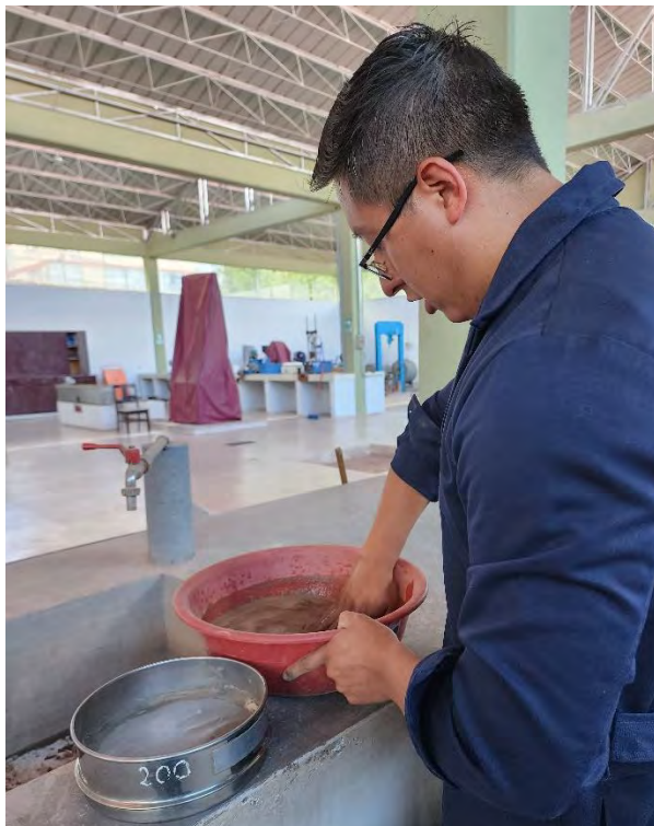
Fotografía 3 Lavado de la muestra para granulometría mecánica.
