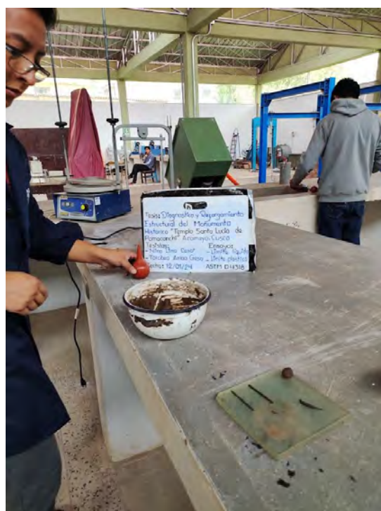
Fotografía 11 Preparación del material para la obtención del límite plástico.
