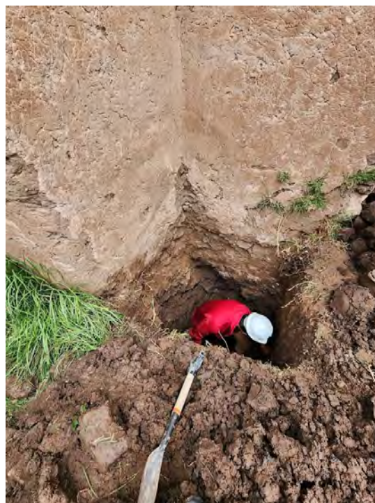
Fotografía 12 Calicata de prospección para extracción de muestras.
