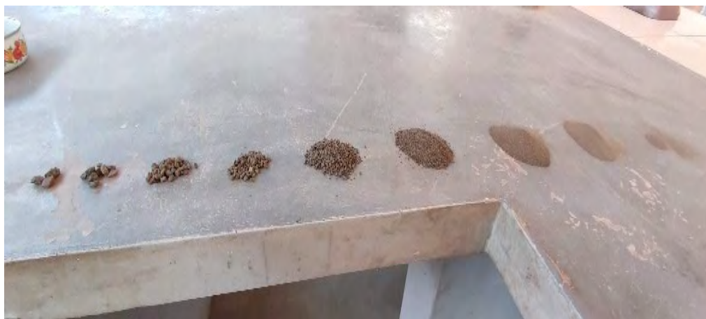
Fotografía 6 Muestra de mortero extraído del Templo de Santa Lucía de Pomacanchi.
