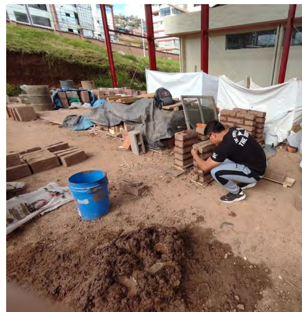
Fotografía 16 Construcción y medidas de pilas de adobe para la obtención de resistencia a compresión de la mampostería.
