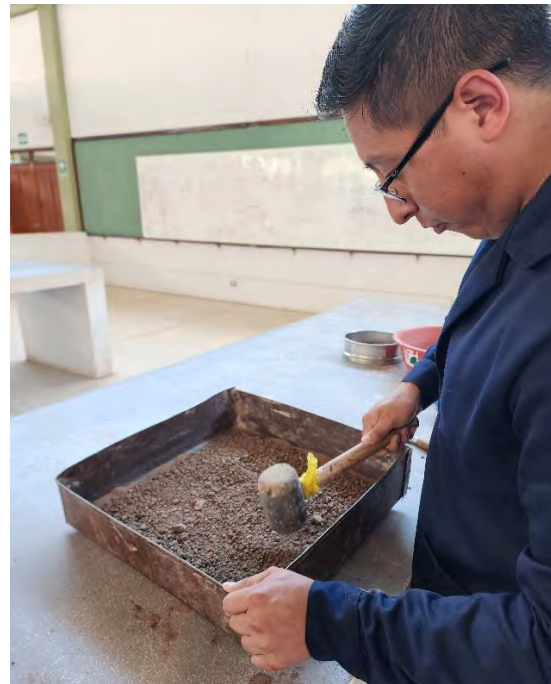
Fotografía 2 Pulverización de la muestra de adobe.
