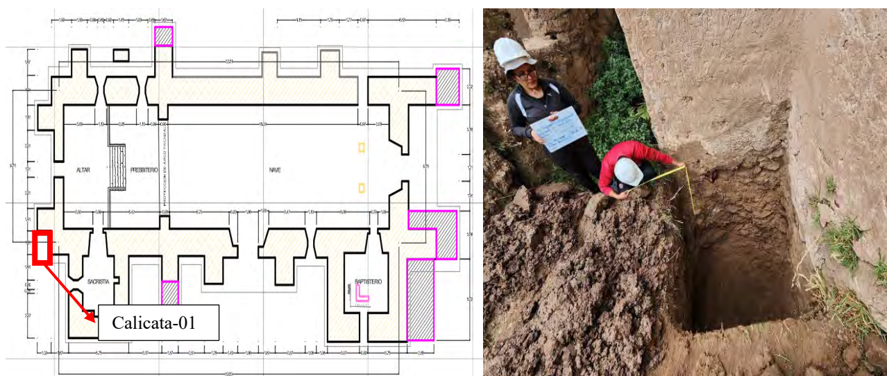
Figura 7: Calicata de prospección C-01
