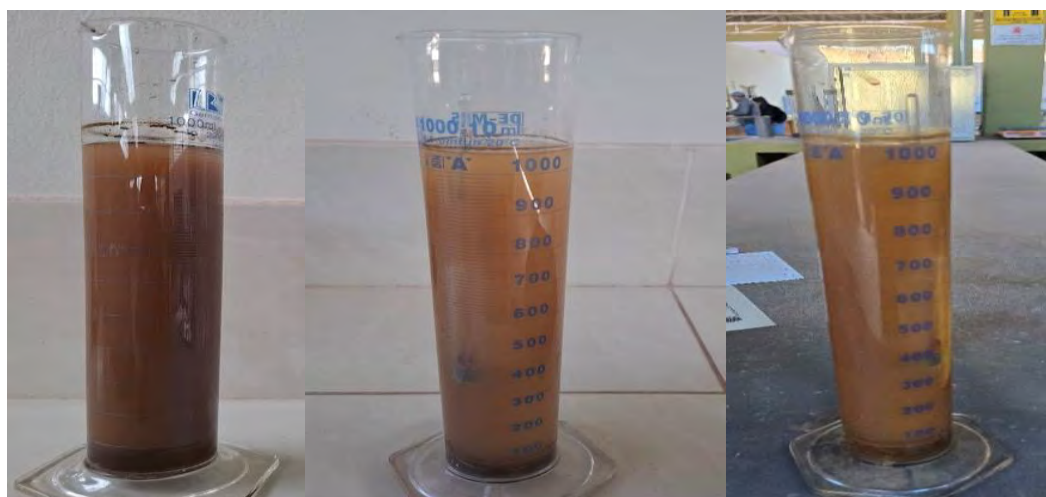
Fotografía 8 Prueba de Hidrómetro del adobe, mortero y suelo.
