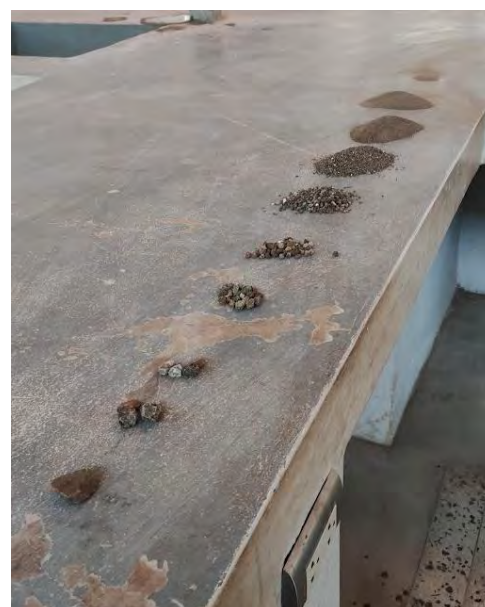
Fotografía 7 Material retenido en la malla de la muestra de mortero.
