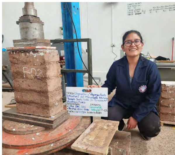
Fotografía 21 Rotura de pilas de adobe.
