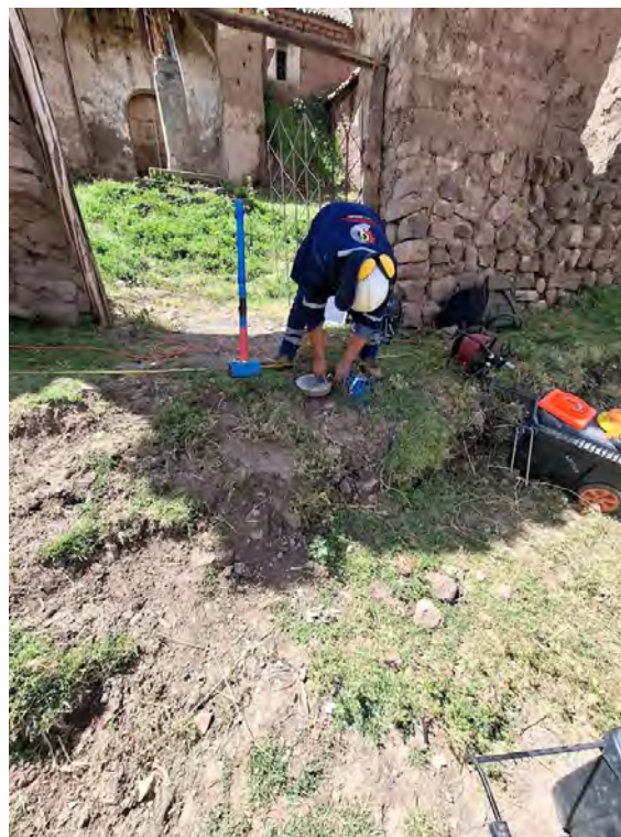
Fotografía 24 Ensayo MASW 1D en Templo Santa Lucía de Pomacanchi
