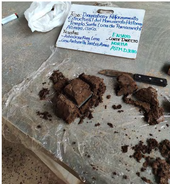
Fotografía 13 Preparación de muestra para el ensayo de corte directo.
