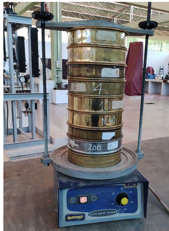
Fotografía 4 Tamizado mecánico para la obtención de la curva granulométrica.
