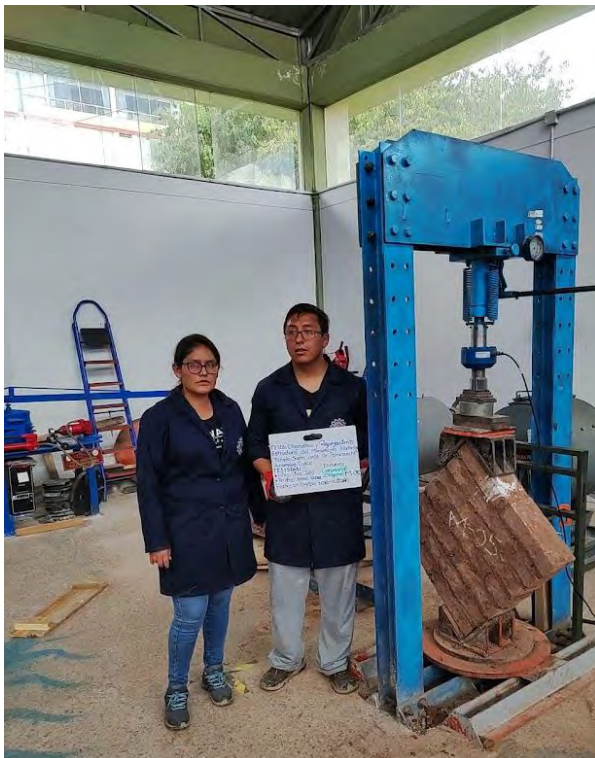
Fotografía 19 Rotura de muretes de adobe.
