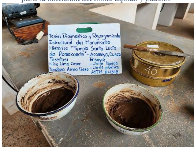
Fotografía 9 Material de adobe y mortero preparado para la obtención del límite líquido y plástico
