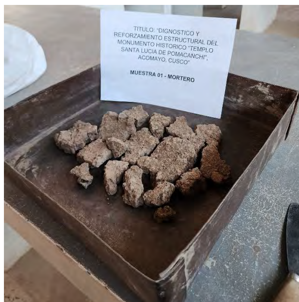
Fotografía 6 Muestra de mortero extraído del Templo de Santa Lucía de Pomacanchi.
