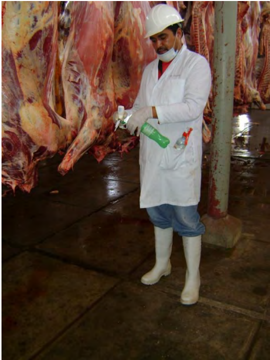
Figura 15 Medición del pH con el potenciómetro digital en canal de la raza criollo.
