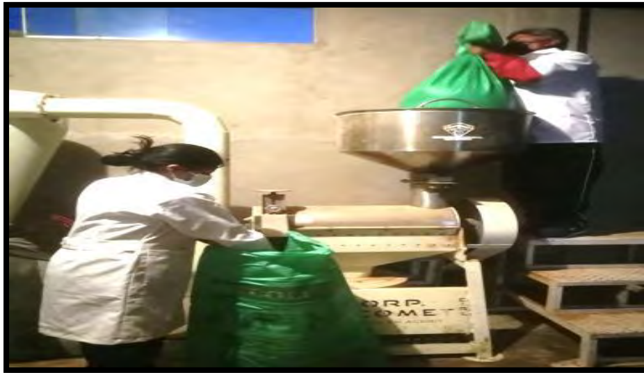
Fotografía 5. Escarificado en Proceso Seco
