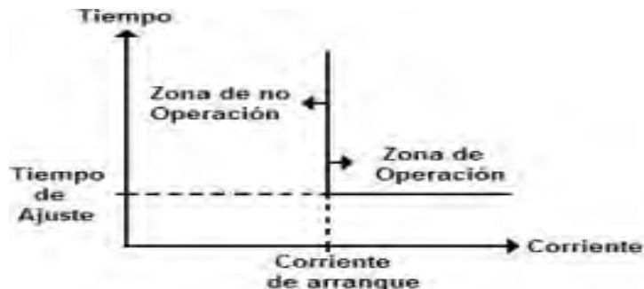
Figura 2.19. Relé de sobrecorriente definida y tiempo definido.
