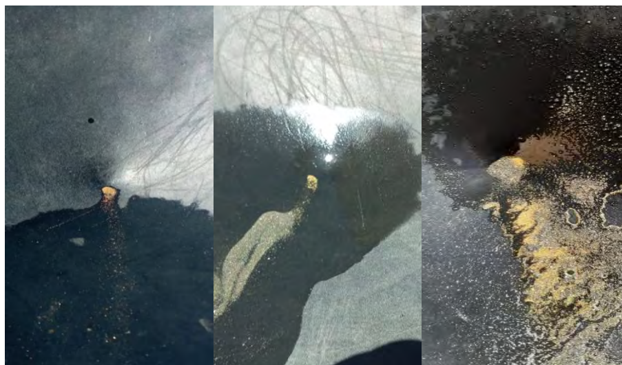
Figura 10 Muestra concentrada (concentración gravimétrica)
