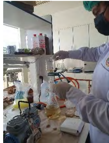
Fotografía N° 14. Filtración al vacío y obtención de los discos de filtración con la muestra a sembrar.
