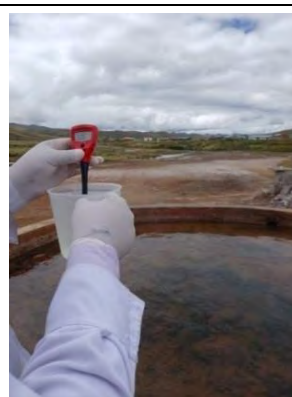
Fotografía N°7: Medición de las propiedades fisicoquímicas: pH metro.
