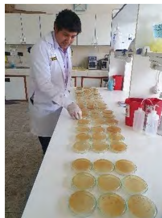
Fotografía N° 10. Verificación de que no existan burbujas en las placas de Petri después de la distribución de los medios de cultivo.
