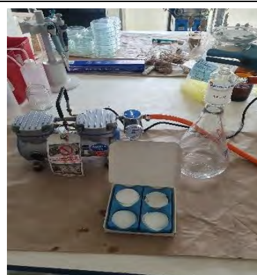
Fotografía N° 12. Equipo de filtración al vacío listo para utilizar.
