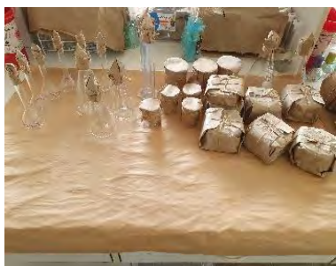
Fotografía N° 1. Uso de papel Kraft para esterilizar material de análisis microbiológico.
