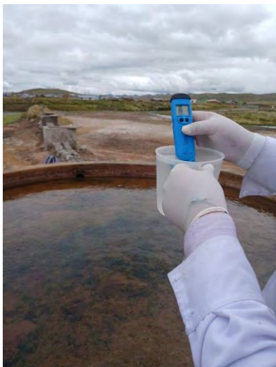
Fotografía N°8: Medición de las propiedades fisicoquímicas: conductímetro.
