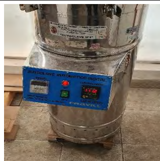
Fotografía N° 2. Todos los materiales son sometidos en autoclave a 121 °C.
