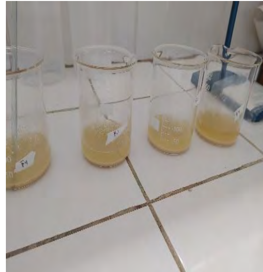
IMAGEN N° 32: AGITAR CADA 10 MIN POR 3 HORAS CON ALCOHOL 50% NEUTRALIZADO LA MUESTRA CADA MUESTRA POR 3 REPETICIONES
