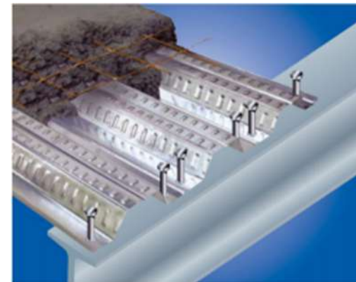
Figura 142 Losa con chapa colaborante de acero. Tomado de: Crisafulli. 2018. Diseño sismorresistente de construcciones de acero
