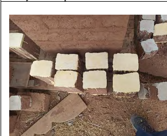
Ensayo de compresion de unidades de adobe
