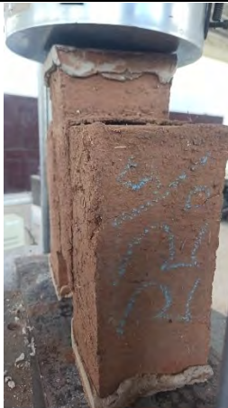
Esfuerzo de adherencia de los ladrillos cerámicos y el mortero de las juntas.
