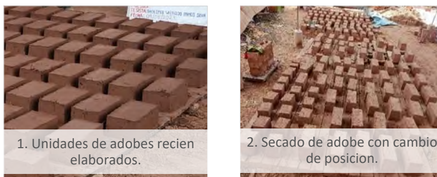
Figura 37 Secado de muestras de adobe
