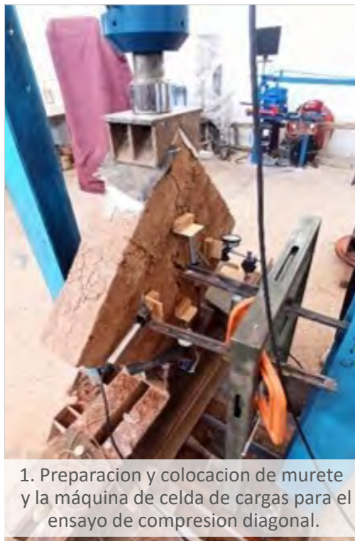
Figura 60 Instrumentación del ensayo de resistencia a Compresión Diagonal en muretes
