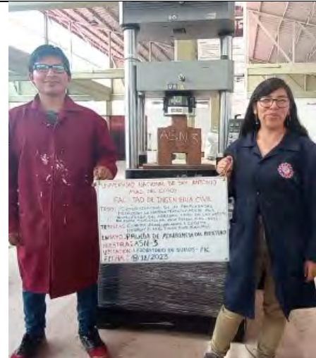
Esfuerzo de adherencia de los ladrillos cerámicos y el mortero de las juntas.
