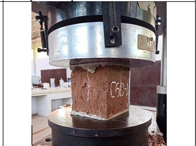
Ensayo de compresion de unidades de adobe
