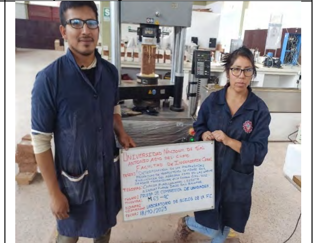
Ensayo de compresion de unidades de adobe
