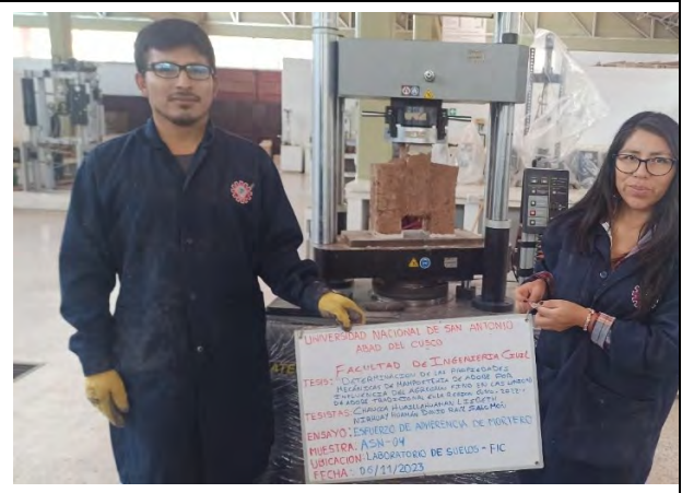
Esfuerzo de adherencia de los ladrillos cerámicos y el mortero de las juntas.
