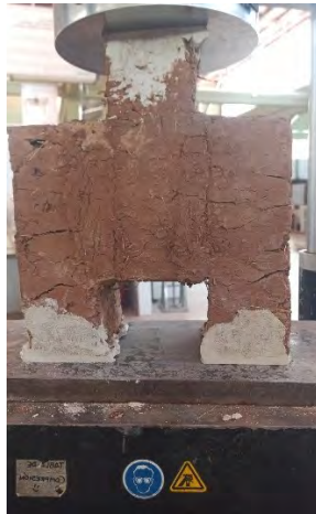
Esfuerzo de adherencia de los ladrillos cerámicos y el mortero de las juntas.
