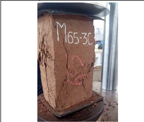
Ensayo de compresion de unidades de adobe
