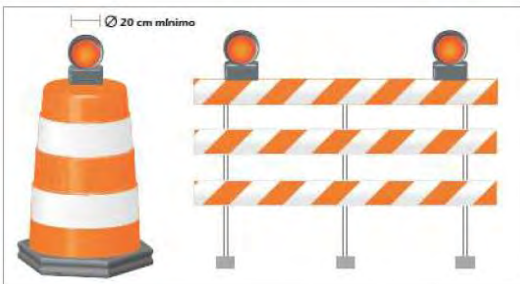
Figura N°64: Barrera reforzada con dispositivos luminosos
