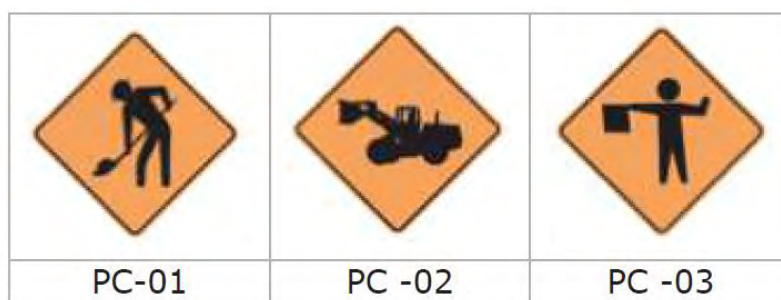
Figura N°57: Señales de prevención en Zona de Trabajo
