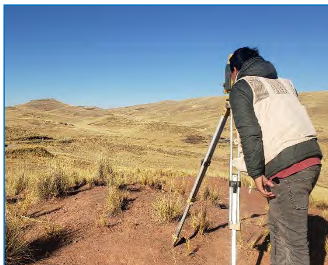
Imagen 07: instalación de la estación total
