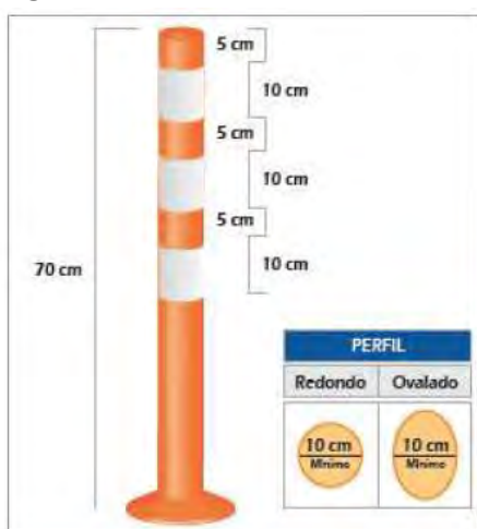
Figura N°59: Dimensiones de delineadores
