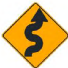
Figura N°50: Señal de camino sinuoso a la derecha (P-5-1)
