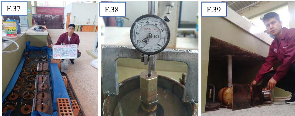
*Fotografía F.22: Penetración de muestras con el equipo de CBR*
