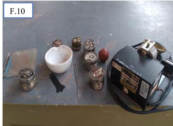
**Fotografía F.11:** Procedimientos del ensayo de límite líquido de las calicatas C-1, C-2, C-3, C-4 y C-5
