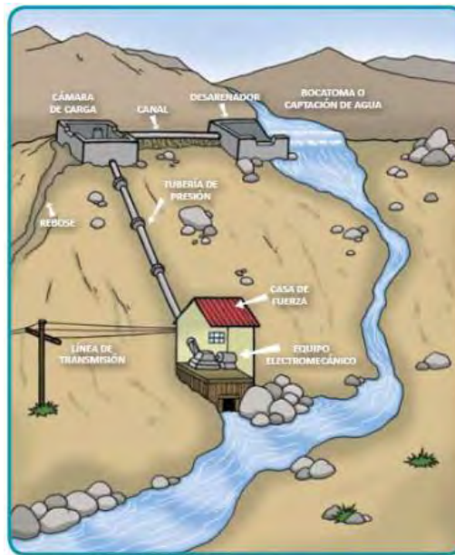
Figura 4.22 Componentes de un sistema micro hidroeléctrico de pasada
