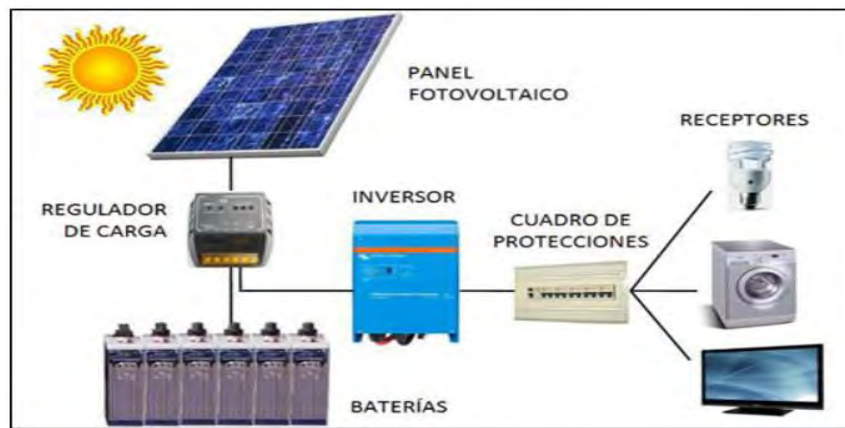
Figura 4.11 Componentes de un sistema solar fotovoltaico
