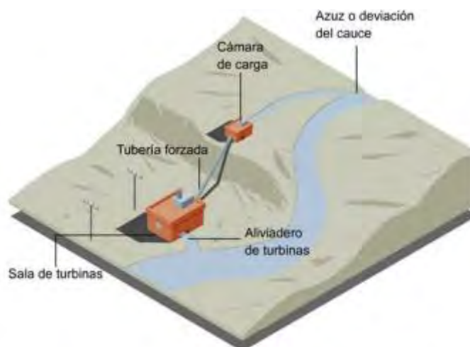
Figura 4.19 Sistema micro hidroeléctrico de pasada
