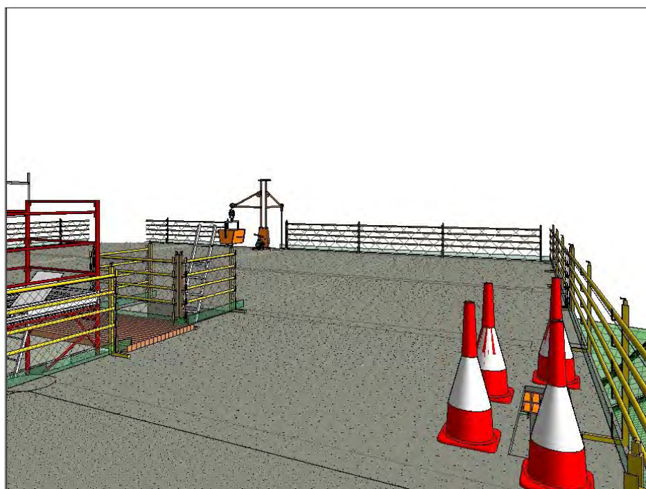
Imagen 85. Conos de Seguridad y Winche de Isaje.
