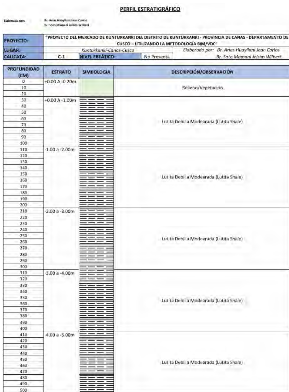
Gráfico 14. Perfil Estratigráfico Calicata 1.
