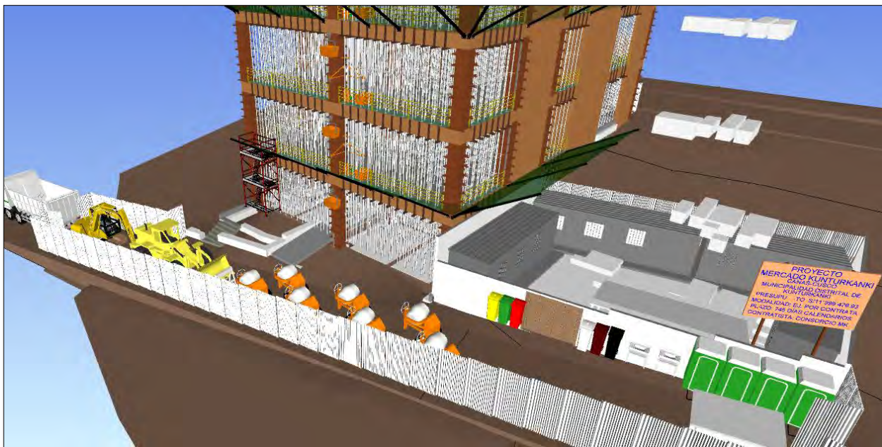
Imagen 86. Modelado de Componentes Iniciales de Obra VDC.
