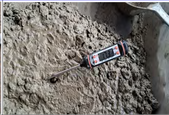
Figura 8 Medición de la temperatura del concreto con sustitución parcial de la arena (20%).
