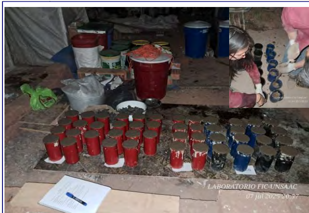
Figura 7 Compactación de la mezcla en los moldes. Ubicación de los moldes sobre una superficie rígida y sin vibraciones.
