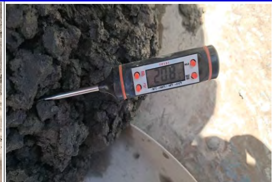
Figura 14 Medición de la temperatura del concreto con adición (5%).
