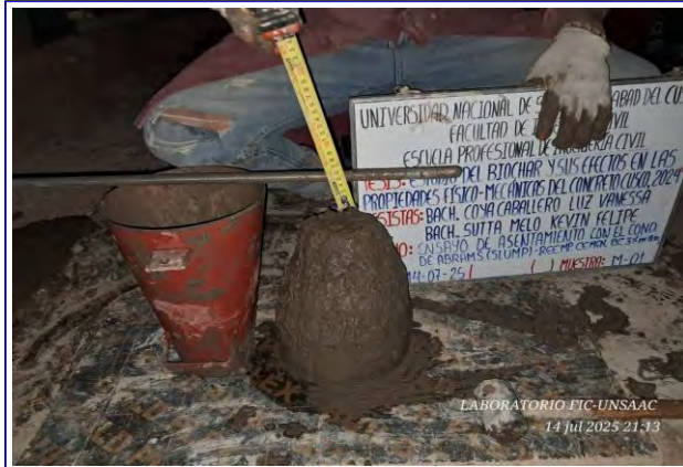
Figura 7 Medición del slump del concreto con sustitución parcial del cemento (3%).
