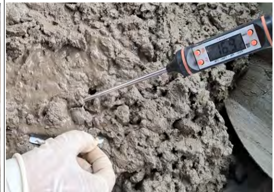
Figura 12 Medición de la temperatura del concreto con adición (1%).
