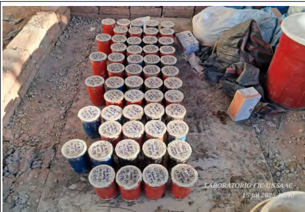
Figura 8 Especímenes de concreto cilíndricos de 4" x 8".
