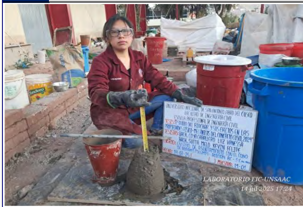
Figura 9 Medición del slump del concreto con adición (3%).
