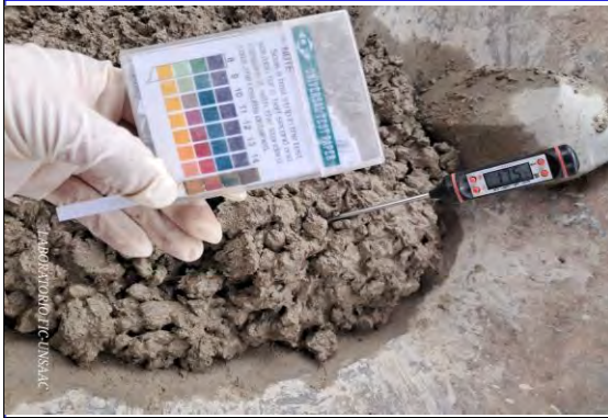
Figura 7 Medición de la temperatura del concreto con sustitución parcial de la arena (15%).
