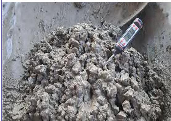
Figura 9 Medición de la temperatura del concreto con sustitución parcial del cemento (1%).
