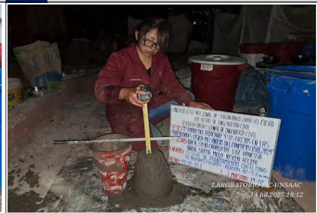
Figura 10 Medición del slump del concreto con adición (5%).
