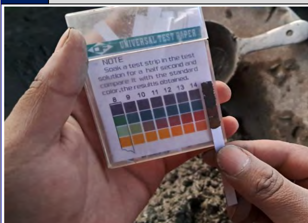
Figura 9 Medición del pH del concreto con sustitución parcial del cemento (3%).
