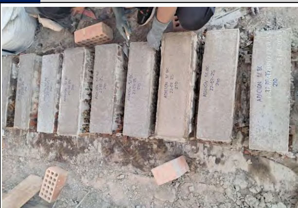
Figura 10 Vigas de concreto de 15x15x60 cm.
