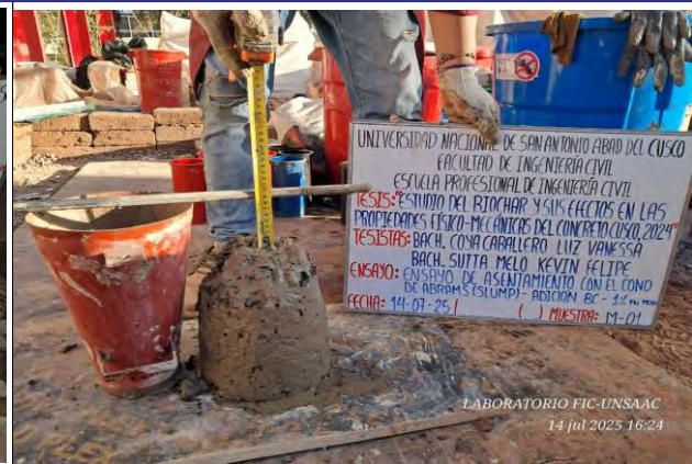
Figura 8 Medición del slump del concreto con adición (1%).
