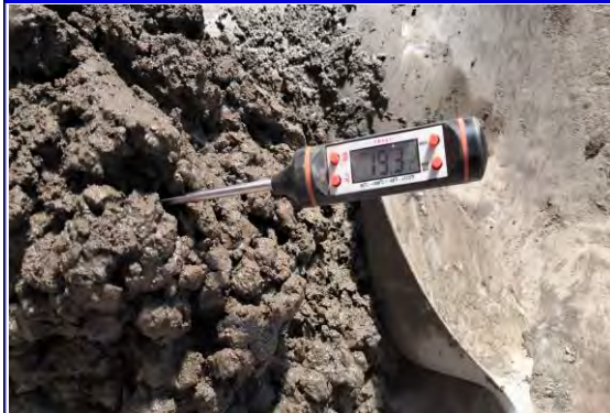
Figura 13 Medición de la temperatura del concreto con adición (3%).
