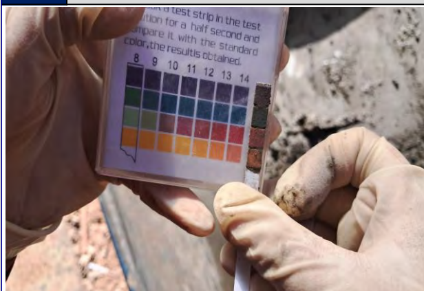
Figura 11 Medición del pH del concreto con adición (3%).
