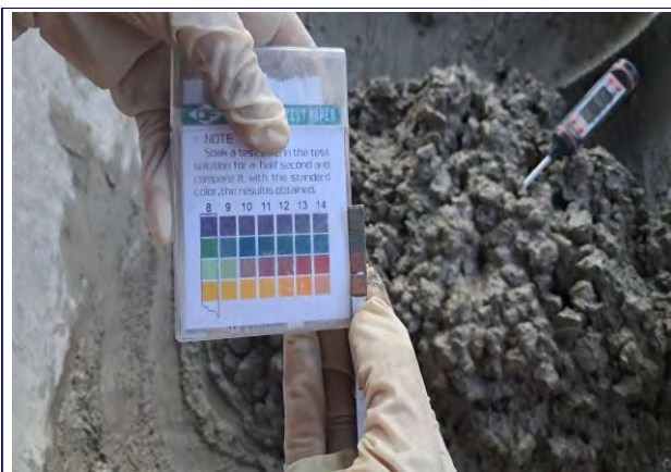
Figura 7 Medición del pH del concreto con sustitución parcial del cemento (1%).
