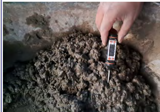
Figura 11 Medición de la temperatura del concreto con sustitución parcial del cemento (3%).
