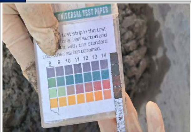
Figura 12 Medición del pH del concreto con adición (5%).
