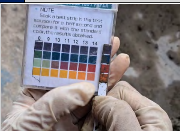
Figura 10 Medición del pH del concreto con adición (1%).
