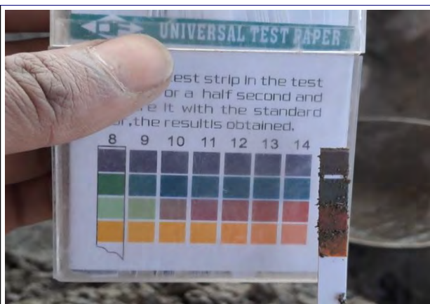
Figura 8 Medición del pH del concreto con sustitución parcial del cemento (2%).
