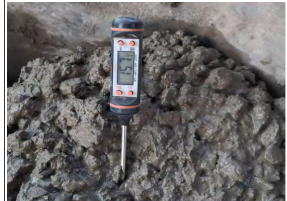
Figura 10 Medición de la temperatura del concreto con sustitución parcial del cemento (2%).
