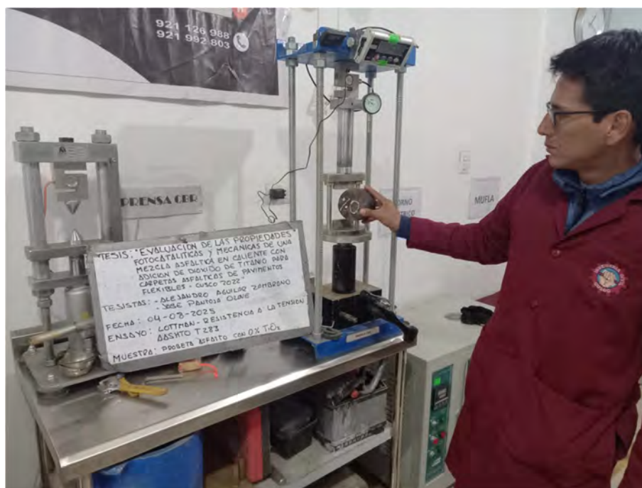
FIGURA NRO. 34: Ensayo para resistencia a la tensión usando cabezal LOTTMAN muestra en condición seca
