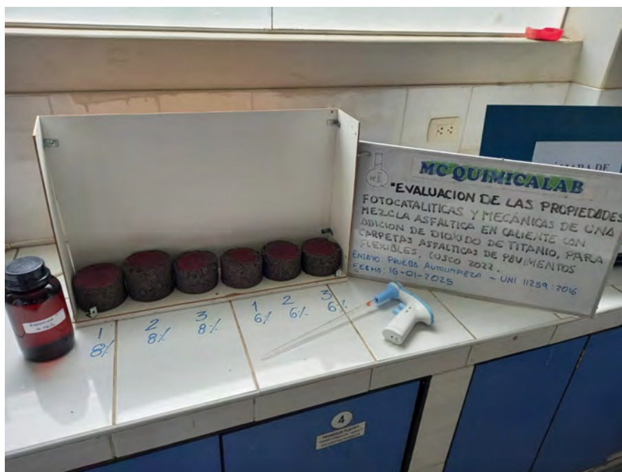
FIGURA NRO. 26: Ensayo de autolimpieza
