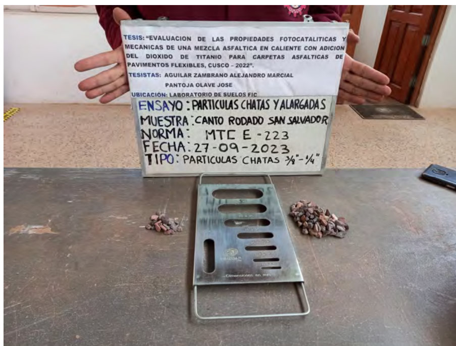
FIGURA NRO. 7: Ensayo de partículas chatas y alargadas agregado grueso
