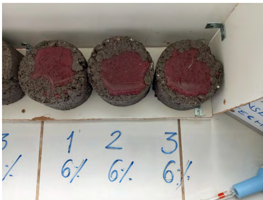
FIGURA NRO. 25: Briquetas con el reactivo de Rodamina para la prueba de colorimetría
