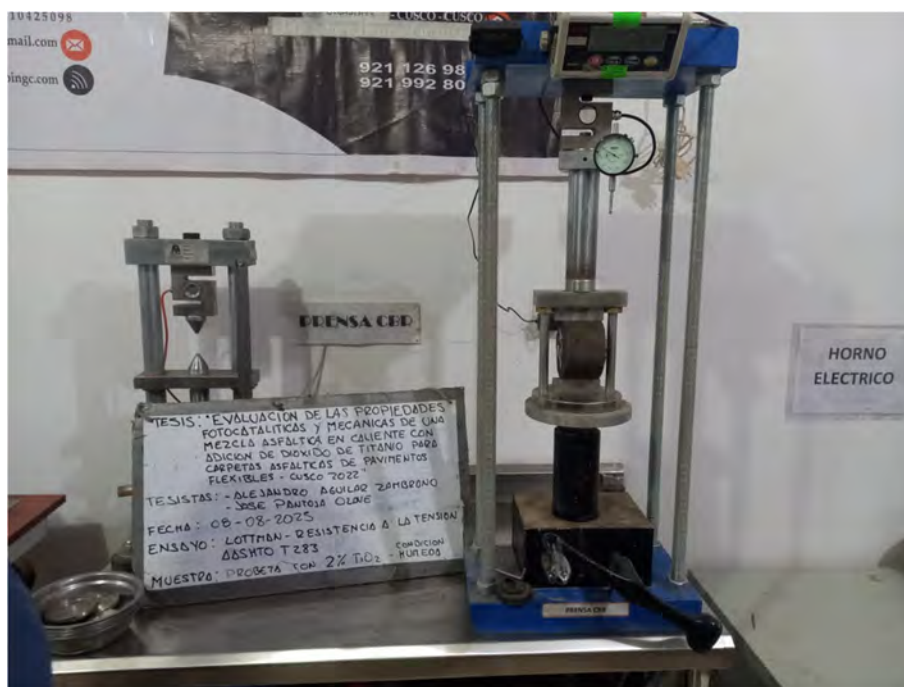
FIGURA NRO. 33: Ensayo para resistencia a la tensión usando cabezal LOTTMAN muestra en condición húmeda
