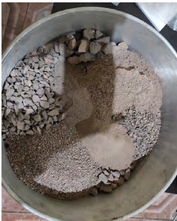
FIGURA NRO. 14: Tamizado para fraccionamiento de agregado segun indica la norma
