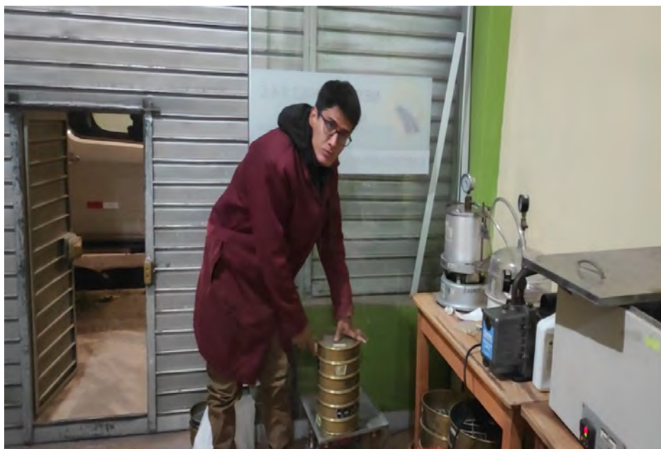
FIGURA NRO. 13: Tamizado del agregado para el fraccionamiento en el ensayo Marshall
