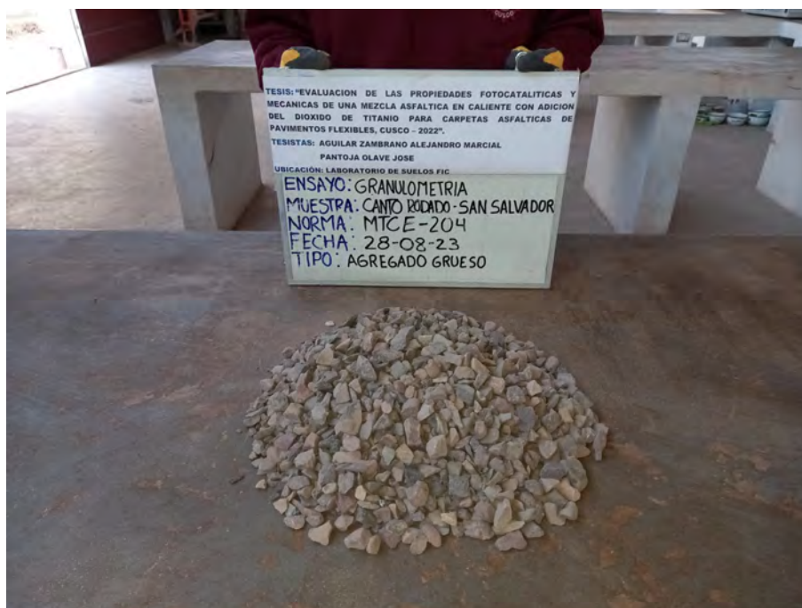
FIGURA NRO. 3: Granulometría del agregado grueso cantera morro blanco
