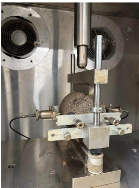
FIGURA NRO. 31: Ensayo MODULO RESILIENTE de la briqueta con adición de dióxido de titanio, TDM-Lima
