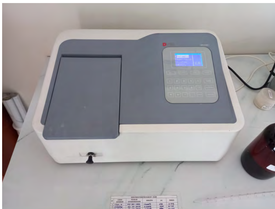
FIGURA NRO. 27: Espectrofotometro con el que se realizaron los ensayos de autolimpieza mediante la coloracion
