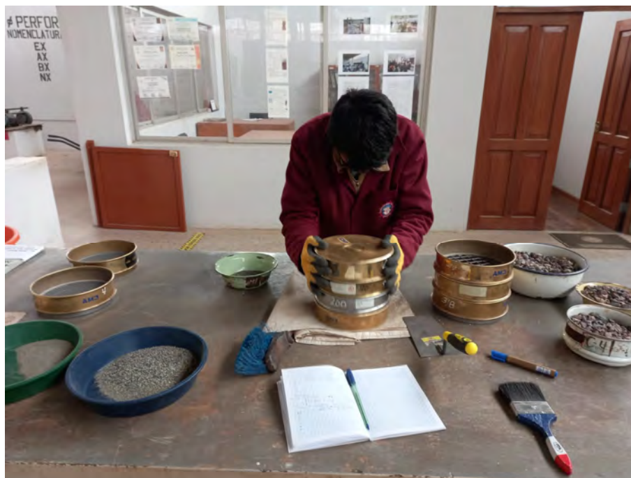
FIGURA NRO. 5: Granulometría y tamizado agregado fino
