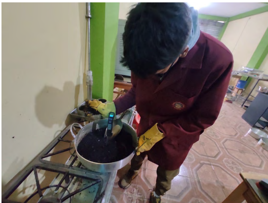
FIGURA NRO. 16: Produccion de mezcla asfaltica por el metodo marshall
