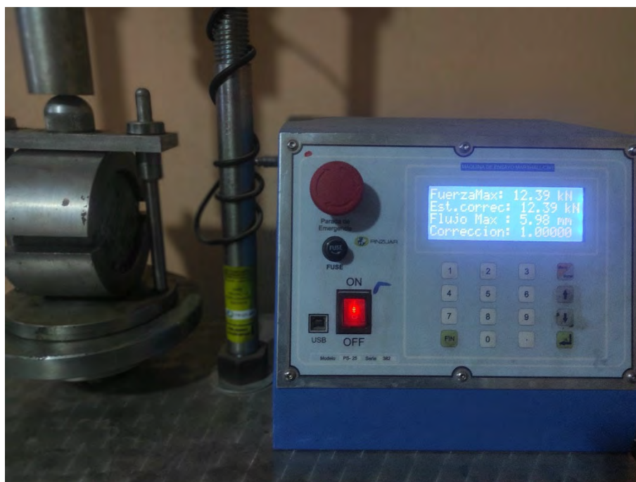
FIGURA NRO. 23: Rotura de briqueta en la prensa Marshall
