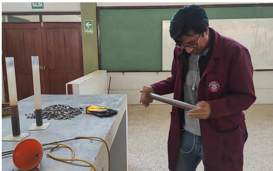
FIGURA NRO. 11: Ensayo de equivalente de arena agregado fino
