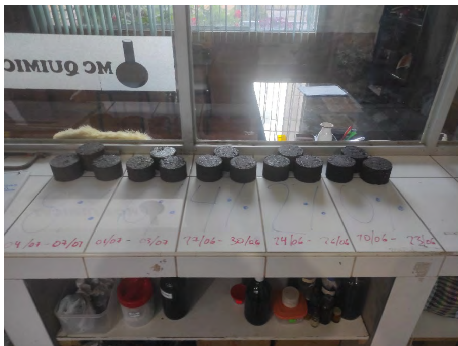
FIGURA NRO. 30: Briquetas con los diferentes porcentajes de Dióxido de titanio
