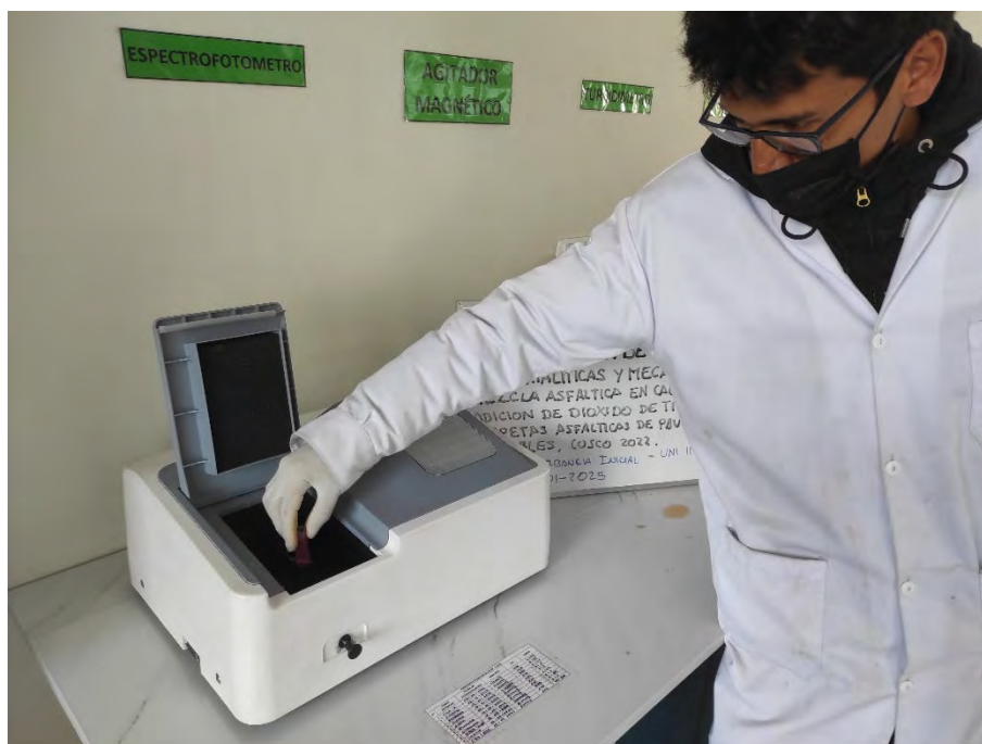
FIGURA NRO. 28: Ensayo de la colorancia en el espectrofotómetro
