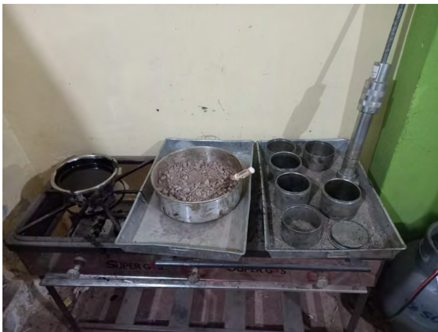
FIGURA NRO. 15: Calentamiento de materiales y equipos de compactación Marshall
