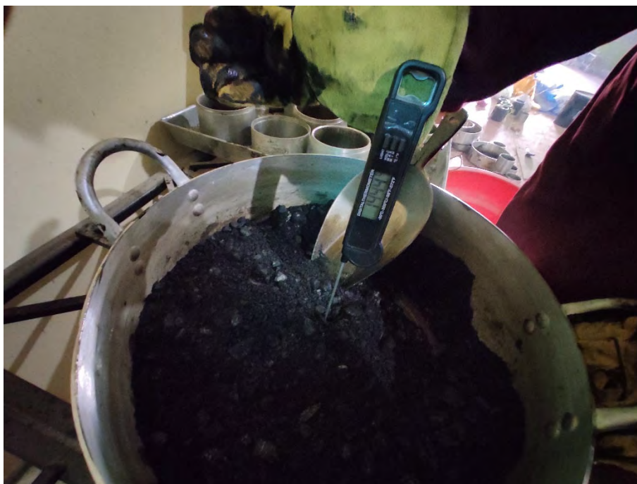
FIGURA NRO. 17: Medicion de temperatura de mezclado para fabricacion de briquetas
