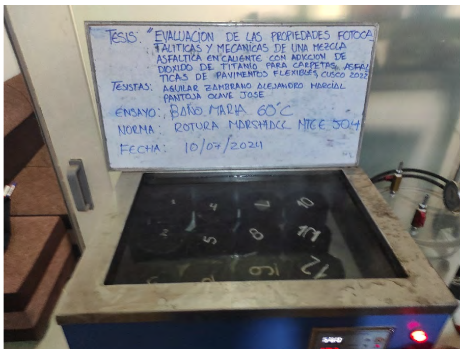
FIGURA NRO. 20: Acondicionamiento de las briquetas para su rotura en la prensa Marshall
