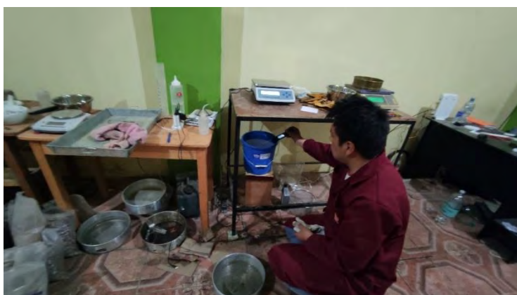
Figura 112: Control de temperatura para el pesaje de especímenes sumergidos y así determinar el peso específico de las MAC.
