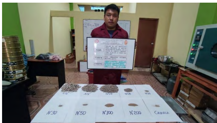
Figura 96: Granulometría de agregado grueso piedra chancada.
