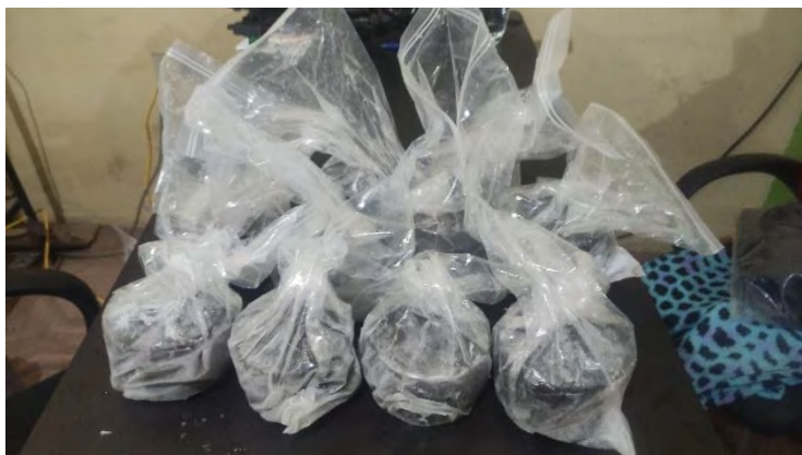
Figura 129: Preparación de las de los especímenes MAC patrón y MAC patrón adicionando cemento como filler para la etapa de congelación del ensayo TSR.
