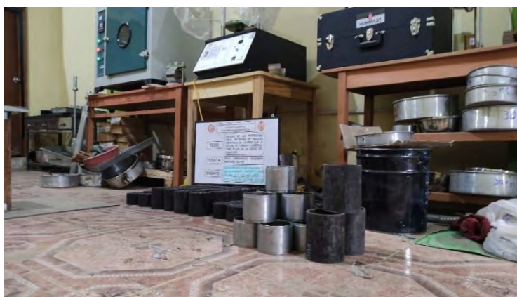
Figura 124: Moldes que se usaron para la elaboración de especímenes de MAC.
