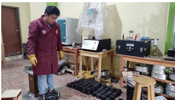
Figura 121: Especímenes adicionando 1%, 2%, 4% y 8% de cemento como filler para la determinación del contenido óptimo de cemento adicionado de MAC.
