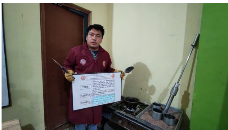
Figura 118: Calentado de agregados, cemento y asfalto para la determinación del contenido óptimo de cemento adicionado de MAC.
