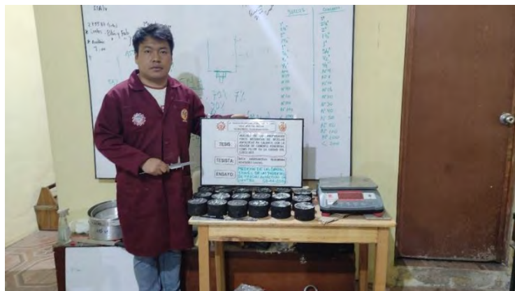
Figura 108: Pesaje de los especímenes para la obtención de contenido óptimo de asfalto de MAC patrón.
