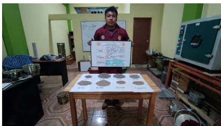
Figura 97: Granulometría de agregado fino arena natural.
