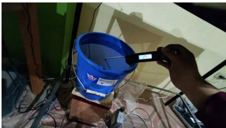
Figura 111: Control de temperatura de baño maría para determinar el peso específico de las MAC.
