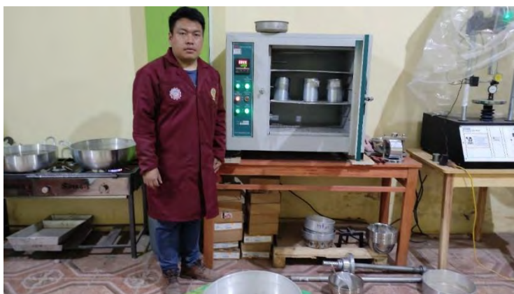
Figura 100: Calentado de briqueteras para iniciar con la mezcla y compactación de MAC patrón.
