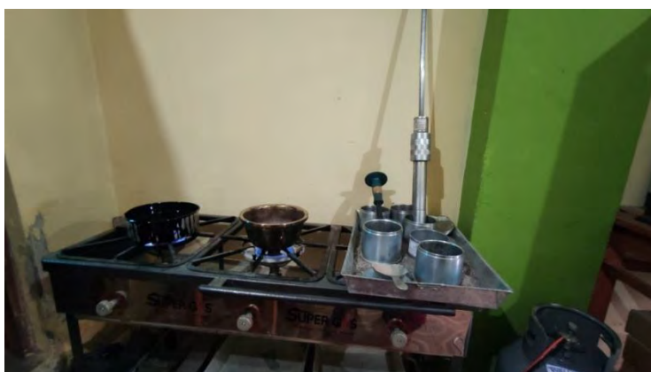
Figura 104: Calentado en simultáneo de agregado, asfalto y equipo para la mezcla y compactación de MAC patrón.
