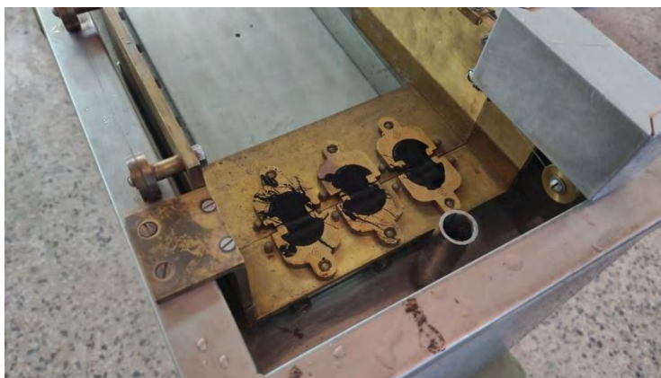
Figura 114: Colocación de muestras en el ductilómetro de asfalto Pen 85/100.
