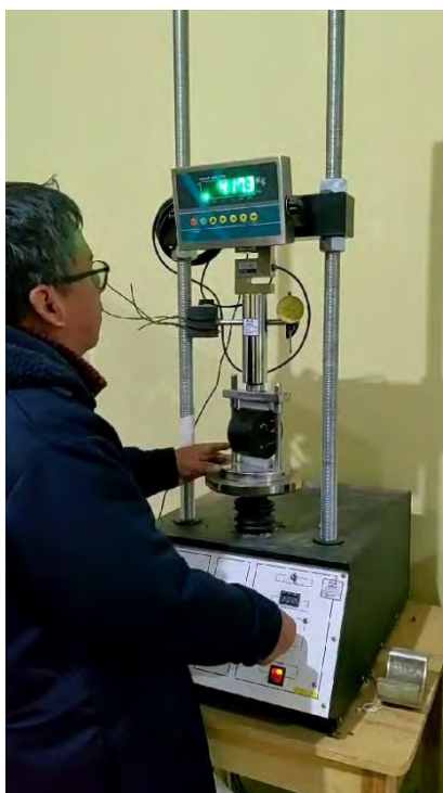
Figura 133: Ensayo en el cabezal Lottman para determinar TSR de especímenes MAC patrón y MAC patrón adicionando cemento como filler.
