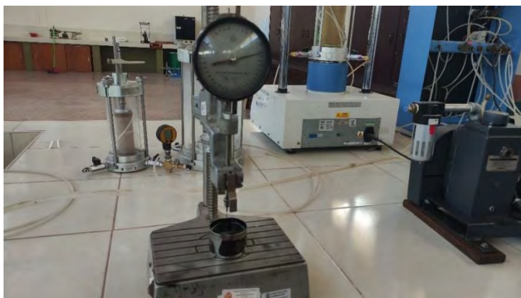
Figura 117: Colocación de muestras en el penetrómetro de asfalto Pen 85/100.
