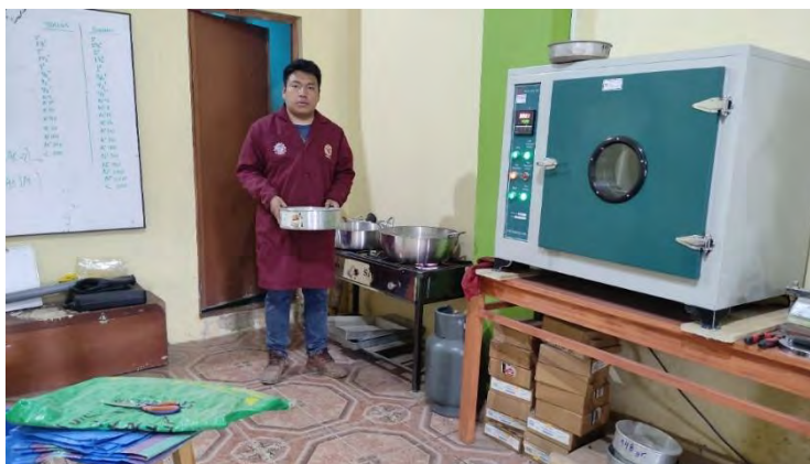
Figura 99: Equipo para calentar los agregados y asfalto.
