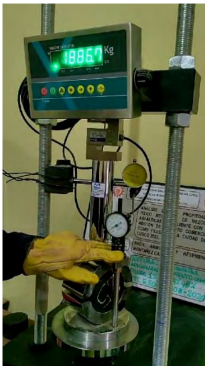
Figura 132: Ensayo en el aparato Marshall para determinar estabilidad y flujo de especímenes MAC patrón y MAC patrón adicionando cemento como filler.
