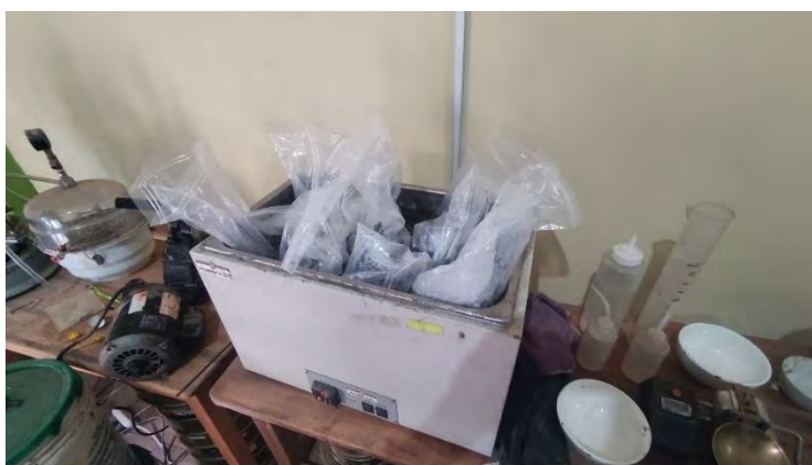
Figura 131: Descongelación a 25^{\circ}\text{C} para su medición de espesor y diámetro de especímenes MAC patrón y MAC patrón adicionando cemento como filler son congelados.
