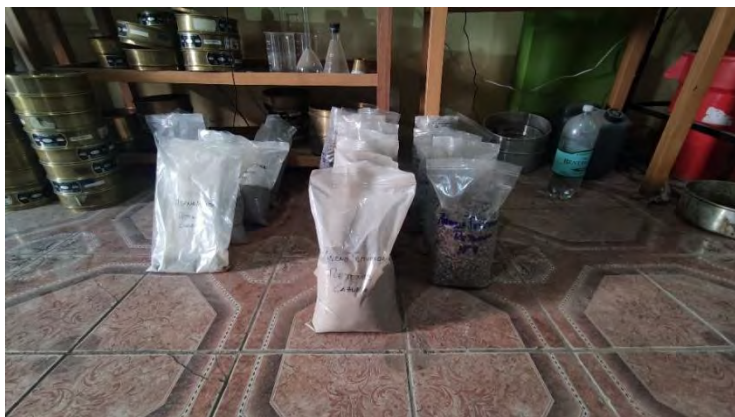
Figura 105: Preparación de agregados para las distintas dosificaciones de asfalto para la mezcla y compactación de MAC patrón.
