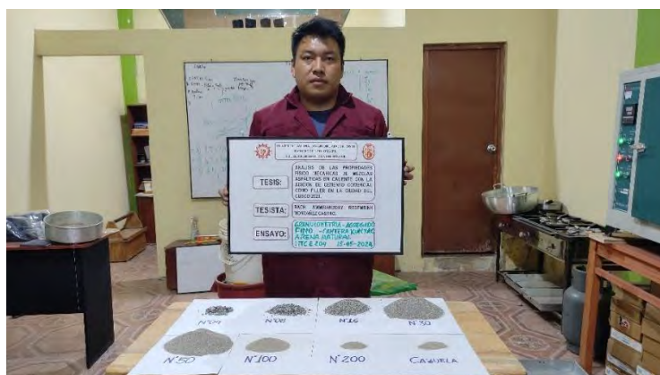
Figura 98: Granulometría de agregado fino arena triturada
