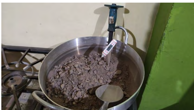
Figura 103: Control de temperatura en el calentado de agregados para la mezcla y compactación de MAC patrón.
