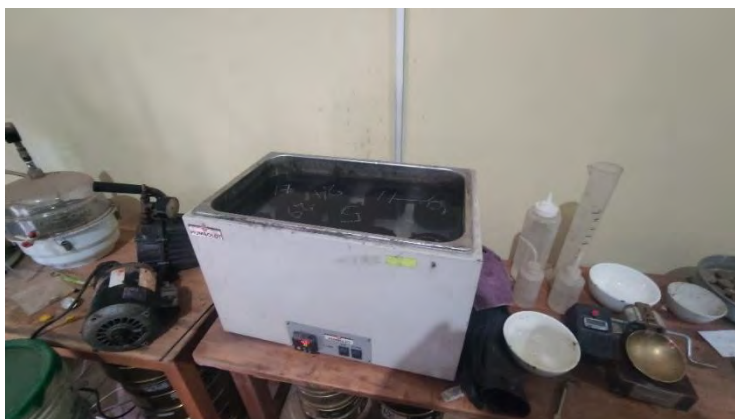
Figura 128: Saturación de los especímenes MAC patrón y MAC patrón adicionando cemento como filler para realizar el ensayo TSR.
