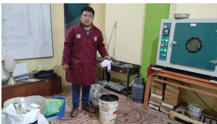
Figura 101: Separación de asfalto para iniciar con la mezcla y compactación de MAC patrón.
