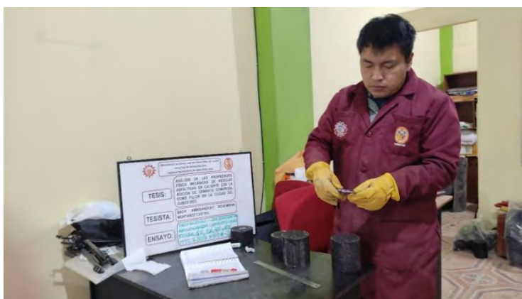
Figura 122: Medición de espesor y altura de especímenes adicionando 1%, 2%, 4% y 8% de cemento como filler de MAC.
