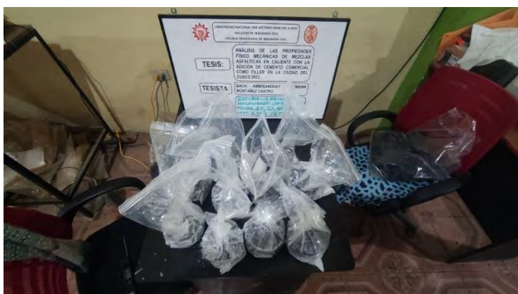
Figura 130: Proceso del ensayo de TSR donde los especímenes MAC patrón y MAC patrón adicionando cemento como filler son congelados a -18^{\circ}\text{C} .
