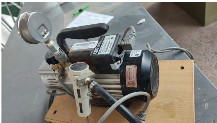
Figura 126: Equipo de vacíos para realizar el ensayo de gravedad teórica máxima y saturación de MAC patrón y MAC patrón adicionando cemento como filler.
