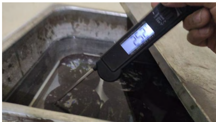
Figura 110: Control de temperatura de baño maría para determinar el peso específico de las MAC.
