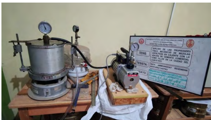
Figura 127: Equipo RICE para la determinación de gravedad teórica máxima y saturación de MAC patrón y MAC patrón adicionando cemento como filler.
