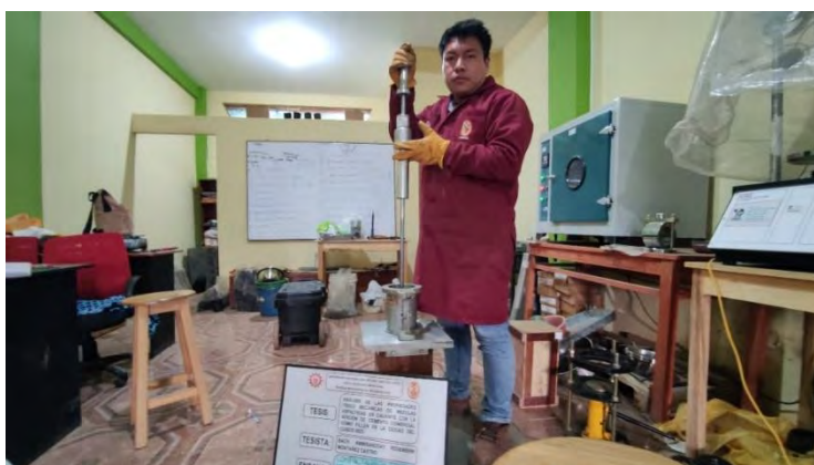
Figura 119: Compactación manual de las MAC para la determinación del contenido óptimo de cemento adicionado de MAC.
