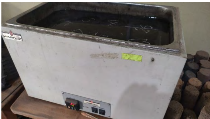
Figura 125: Baño maría para realizar el ensayo en el aparato Marshall y así obtener los parámetros de estabilidad y flujo de MAC adicionado cemento como filler.
