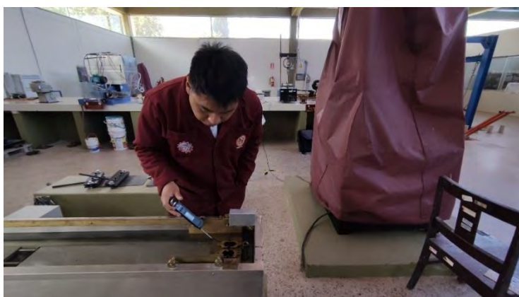
Figura 115: Control de temperatura en el ductilómetro para realizar el ensayo de ductilidad de asfalto pen 85/100.
