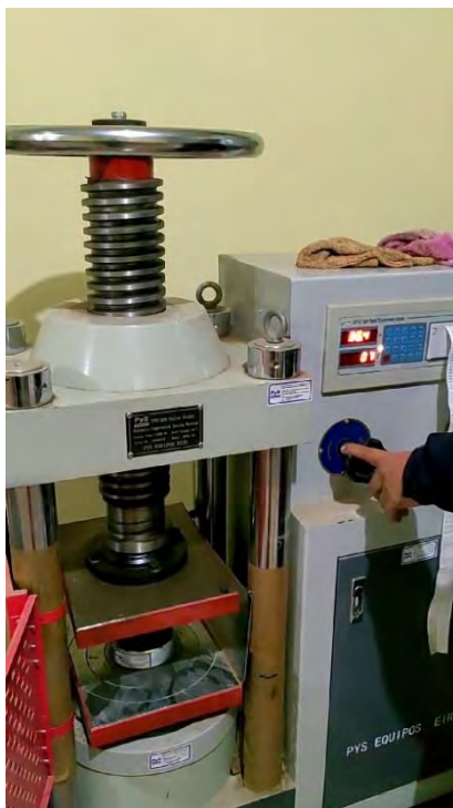
Figura 134: Ensayo compresión para determinar resistencia a la compresión e índice de retención retenida de especímenes MAC patrón y MAC patrón adicionando cemento como filler.
