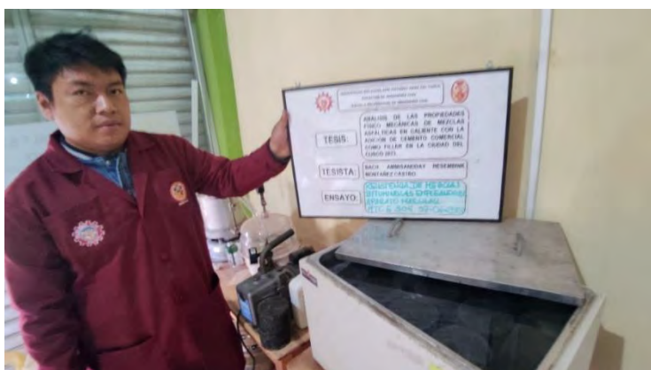
Figura 113: Baño maría de los especímenes para posterior ensayo en aparato Marshall y determinación de estabilidad y flujo.
