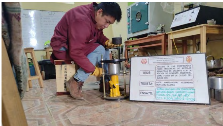
Figura 120: Extracción manual de las MAC para la determinación del contenido óptimo de cemento adicionado de MAC.
