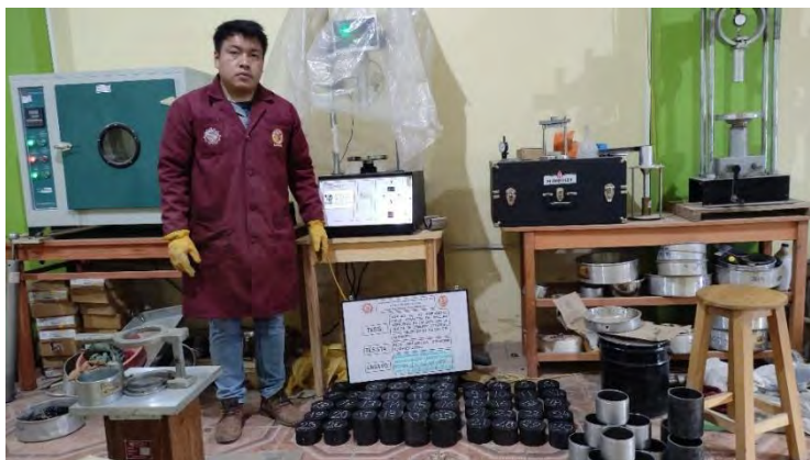
Figura 123: Especímenes adicionando 1%, 2%, 4% y 8% de cemento como filler para los ensayos TSR, resistencia a la compresión e índice de resistencia retenida.
