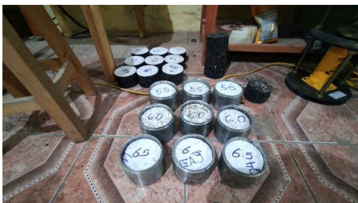
Figura 106: Muestras compactadas con las distintas dosificaciones de asfalto para la obtención de contenido óptimo de asfalto de MAC patrón.
