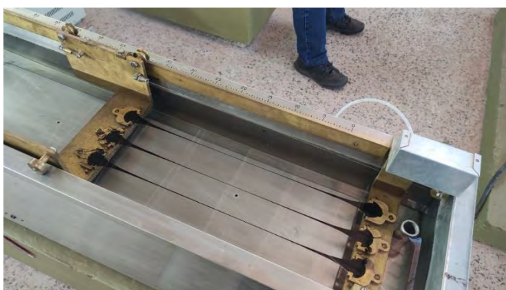
Figura 116: Ensayo de ductilidad de asfalto pen 85/100.
