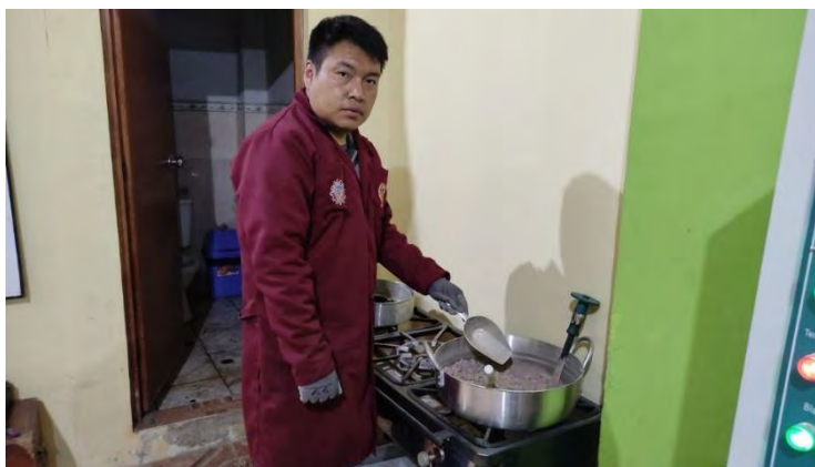
Figura 102: Calentado de agregados para la posterior mezcla con asfalto.
