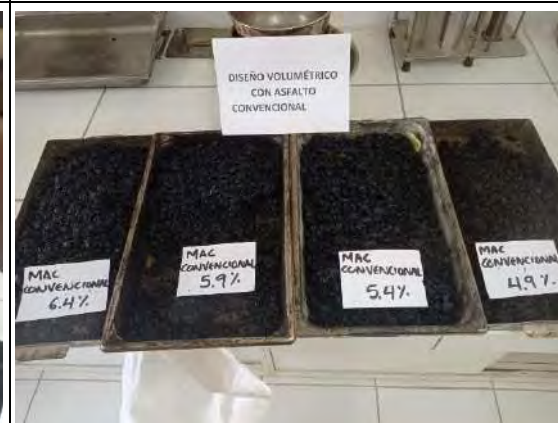
Muestras Convencional De Asfalto Para Compactador
