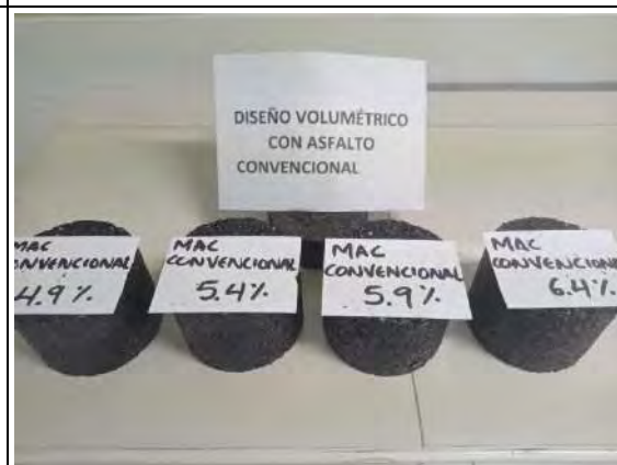
Briquetas Compactador Giratorio Convencional
