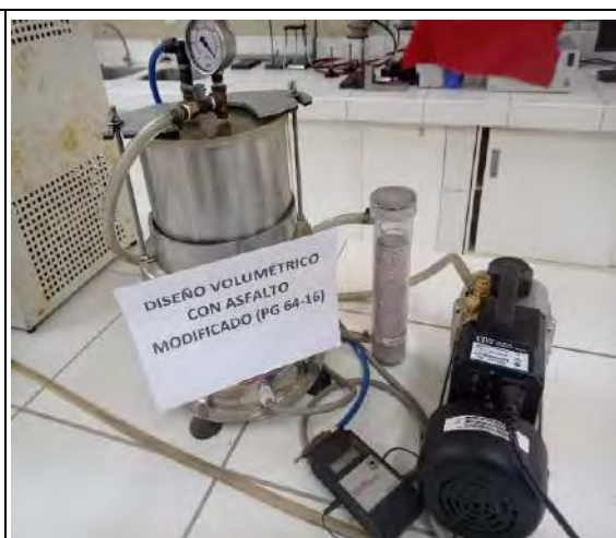
Picnómetro De Vacío Para Modificado 4% SBS
