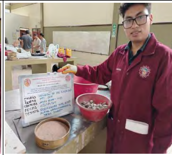
Abrasión Gradación Tipo 'A' Cantera Amaru (03)
