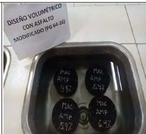
Sumersión De Briquetas Modificadas Con SBS 4%
