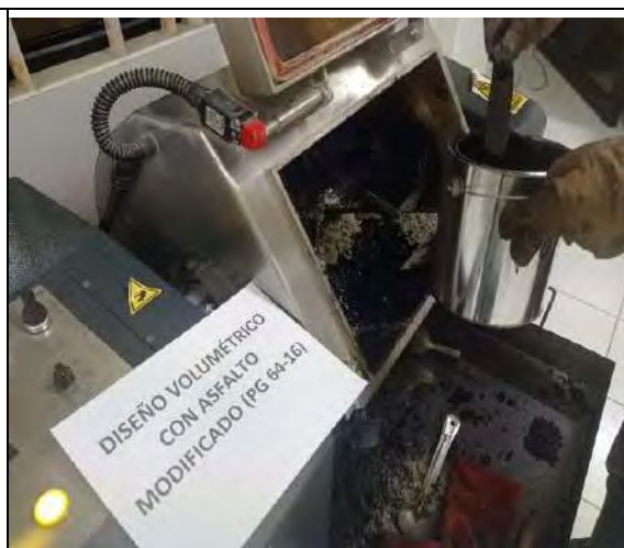
Incorporación De SBS 4% Para Asfalto 64-16
