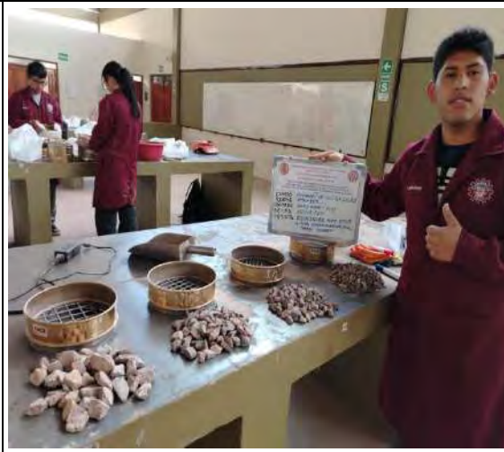
Abrasión Gradación Tipo 'A' Cantera Amaru (03)
