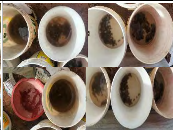
Resistencia al Sulfato Grueso Primera Inmersión
