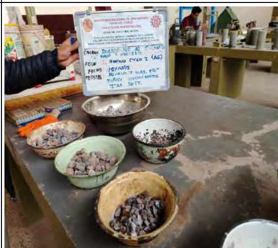
Resistencia al Sulfato Grueso Resultado de la Primera Inmersión
