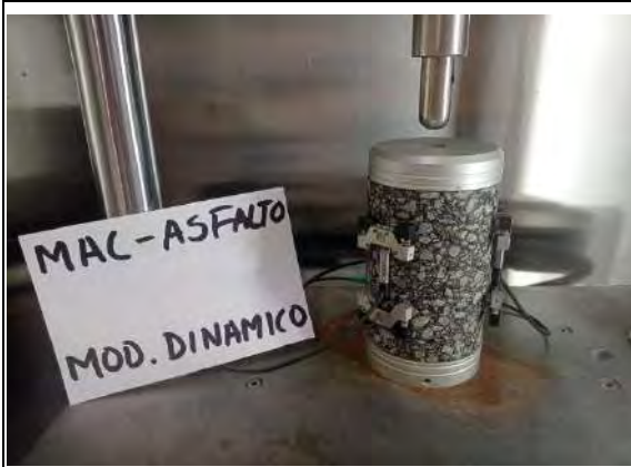
Modulo Dinámico Convencional Pruebas
