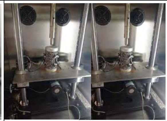
Modulo Dinámico Modificado Y Convencional
