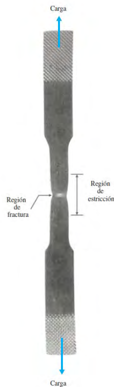
Figura 11. Barra sometida a carga axial (ensayo de tracción de una probeta).
