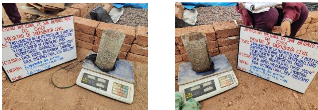
Figura. N°42. Resistencia a la pérdida de finos (Inicial: 2 280g, Final: 2 110g).
