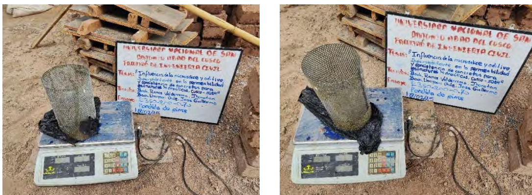
Figura. N°60. Resistencia a la pérdida de finos (Inicial: 2 145g, Final: 2 015g).
