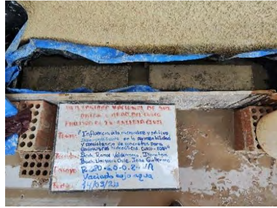
Figura. N°29. Vaciado bajo agua de briquetas y viguetas.
