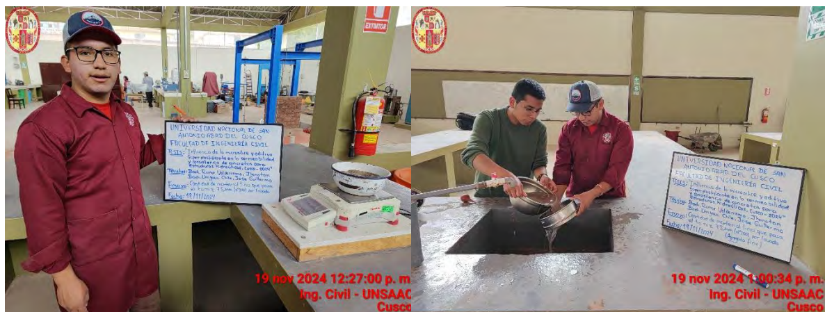
Fotografía N°19. Procedimiento del lavado del agregado fino a través de la malla N°200
