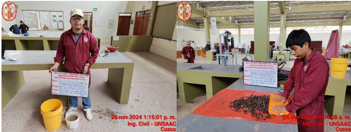
Fotografía N°8. Procedimiento de inmersión y secado superficial del agregado grueso
