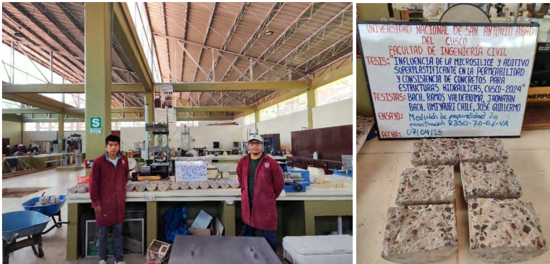
Figura. N°64. Muestras rotas producto de la penetración del agua f'c 350 \text{kg/cm}^2 .
