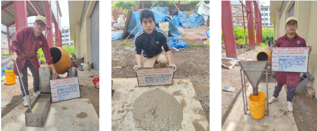
Figura. N°46. Ensayos de consistencia: Capacidad de paso, capacidad de llenado y viscosidad.
