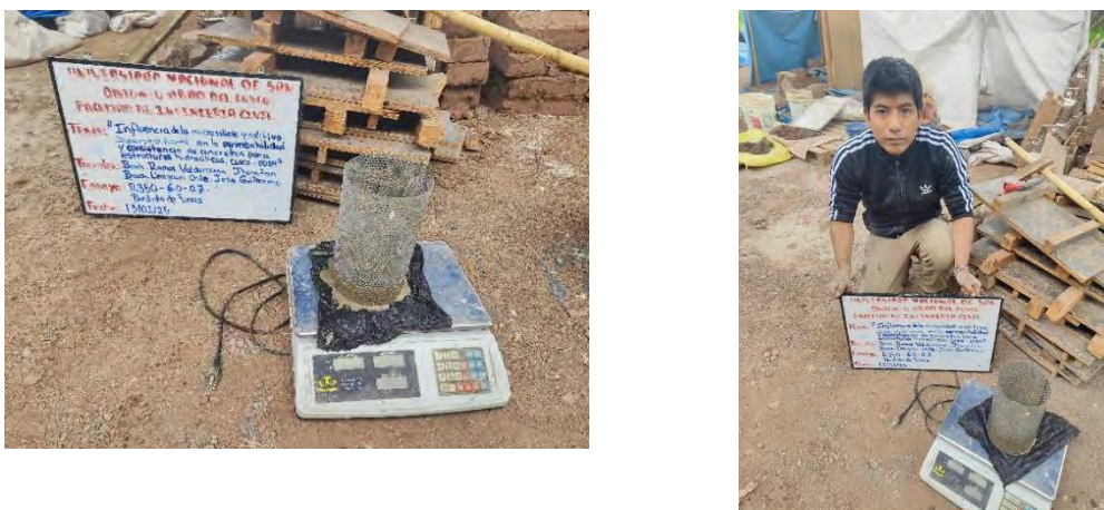
Figura. N°48. Resistencia a la pérdida de finos (Inicial: 2 125g, Final: 1 995g).
