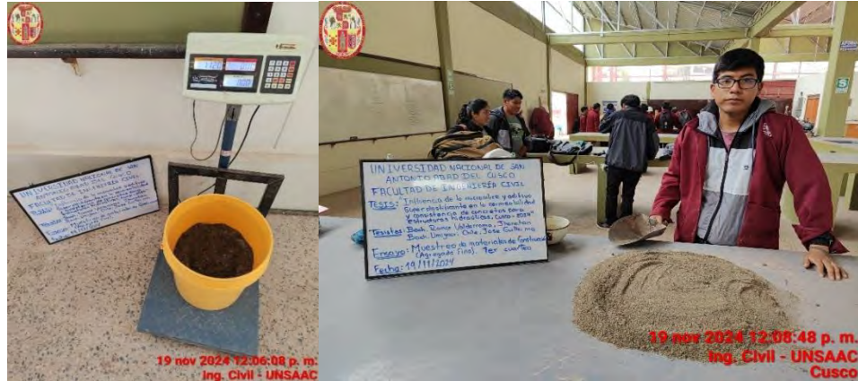
Fotografía N°21. Cantidad de material pesado para el cuarteo.
