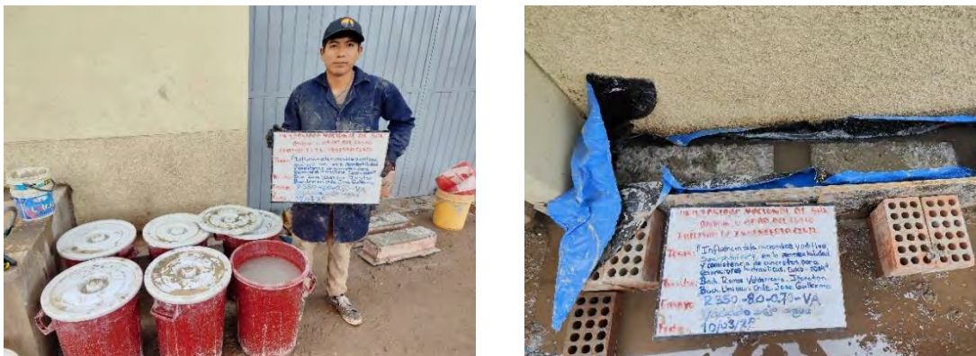
Figura. N°59. Vaciado bajo agua de briquetas y viguetas.
