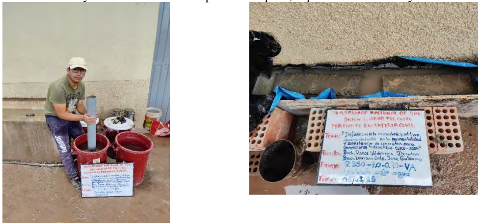
Figura. N°53. Vaciado bajo agua de briquetas y viguetas.
