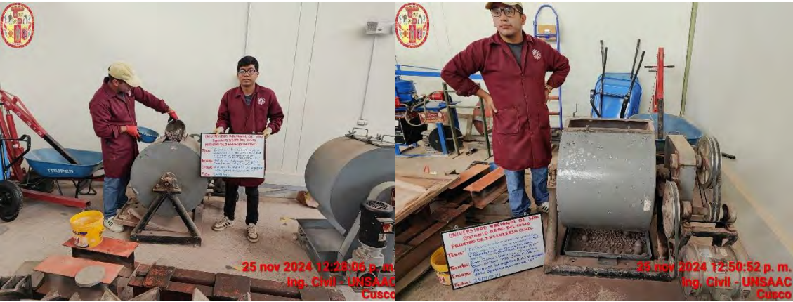
Fotografía N°17. Inserción del material dentro de la máquina de abrasión Los Ángeles
