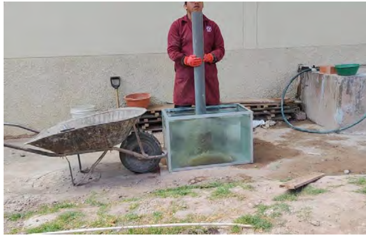
Figura. N°71. Inmersión directa de concreto bajo agua.
