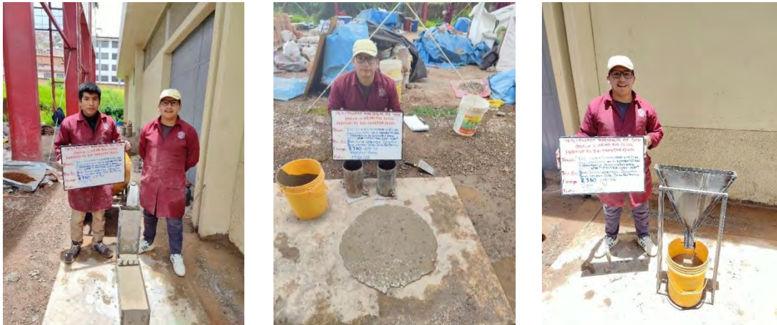
Figura. N°43. Ensayos de consistencia: Capacidad de paso, capacidad de llenado y viscosidad.
