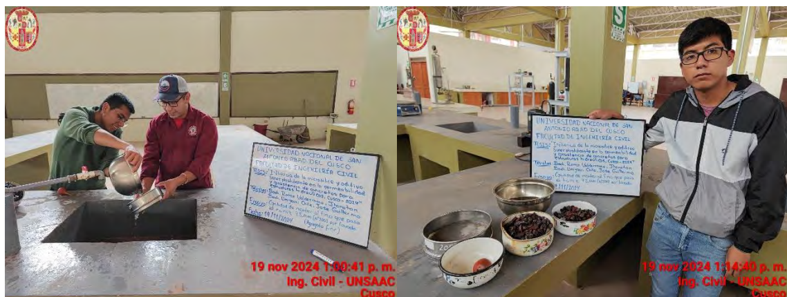
Fotografía N°20. Proceso iterativo del lavado en el agregado fino.
