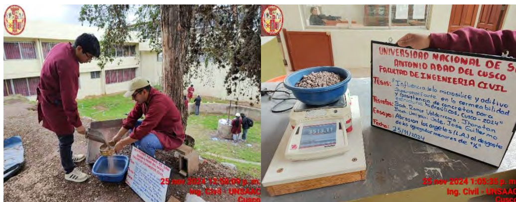
Fotografía N°16. Tamizado del material de degradado y peso de la muestra.
