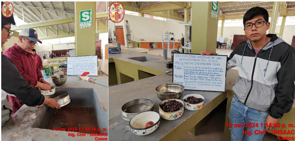
Fotografía N°4. Procedimiento iterativo del lavado del agregado grueso.
