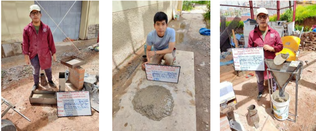
Figura. N°58. Ensayos de consistencia: Capacidad de paso, capacidad de llenado y viscosidad.
