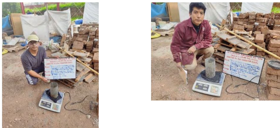
Figura. N°45. Resistencia a la pérdida de finos (Inicial: 2 425g, Final: 2 285g).
