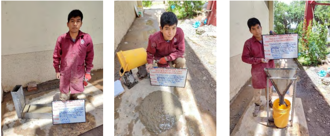
Figura. N°52. Ensayos de consistencia: Capacidad de paso, capacidad de llenado y viscosidad.
