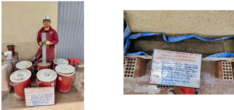
Figura. N°38. Vaciado bajo agua de briquetas y viguetas.
