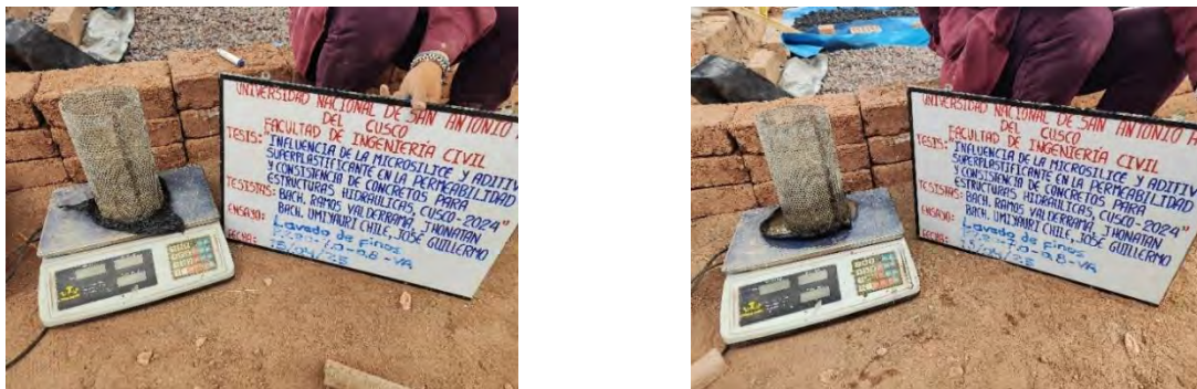
Figura. N°36. Resistencia a la perdida de finos (Inicial: 2 495g, Final: 2 245g).
