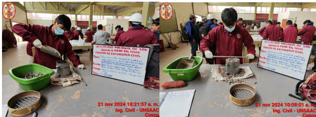
Fotografía N°11. Introducción del agregado en el molde y enrazado del material sobrante
