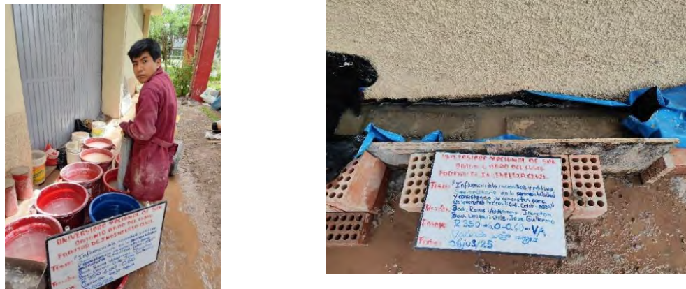
Figura. N°44. Vaciado bajo agua de briquetas y viguetas
