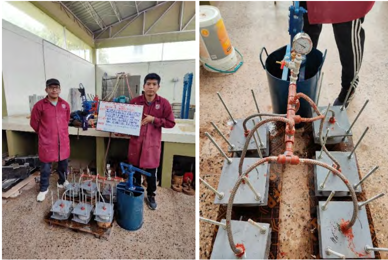
Figura. N°63. Presión del agua a 0.5 MPa al diseño de mezclas de f'c 350 \text{kg/cm}^2 .
