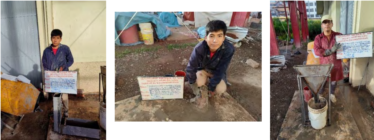
Figura. N°34. Ensayos de consistencia: Capacidad de paso, capacidad de llenado y viscosidad.
