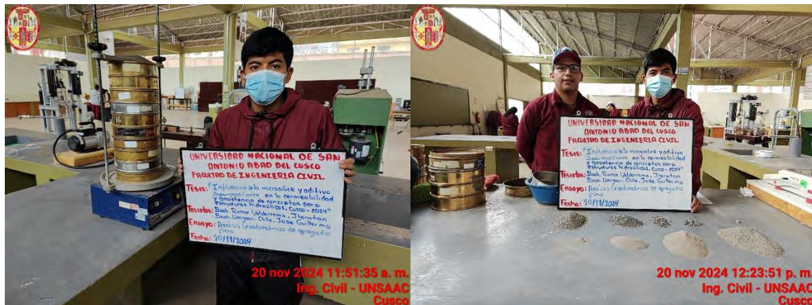
Fotografía N°22. Tamizado mecánico y distribución de tamaño del agregado fino.
