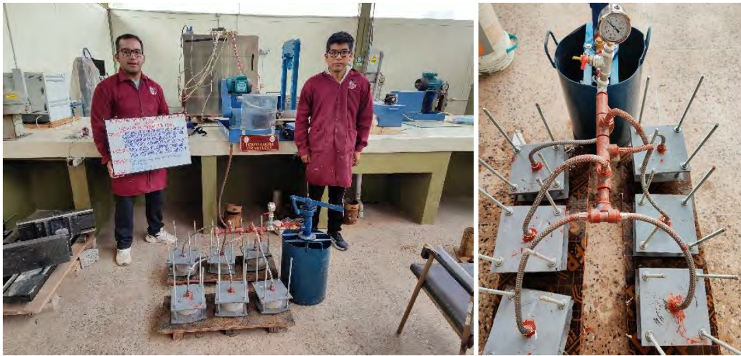
Figura. N°61. Presión del agua a 0.5 MPa al diseño de mezclas de f'c 280 \text{kg/cm}^2 .
