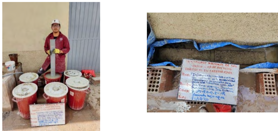
Figura. N°41. Vaciado bajo agua de briquetas y viguetas.
