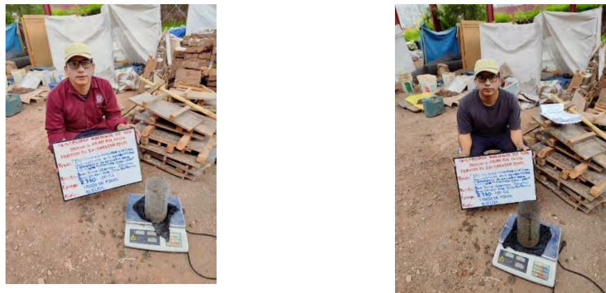
Figura. N°51. Resistencia a la pérdida de finos (Inicial: 2 875g, Final: 2 735g).
