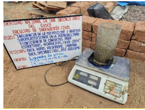
Figura. N°30. Resistencia a la pérdida de finos (Inicial: 2 150g, Final: 1 885g).
