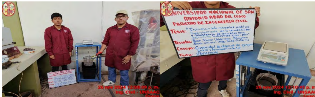
Fotografía N°10. Registro del peso del agregado grueso sumergido
