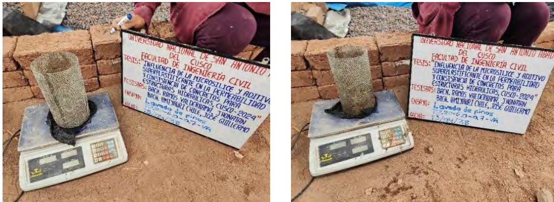
Figura. N°27. Resistencia a la pérdida de finos (Inicial: 2 305g, Final: 2 055g).
