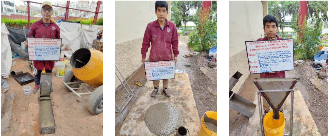
Figura. N°49. Ensayos de consistencia: Capacidad de paso, capacidad de llenado y viscosidad.
