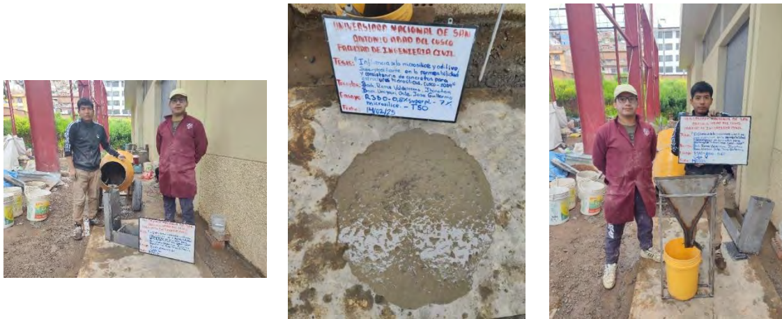
Figura. N°55. Ensayos de consistencia: Capacidad de paso, capacidad de llenado y viscosidad.
