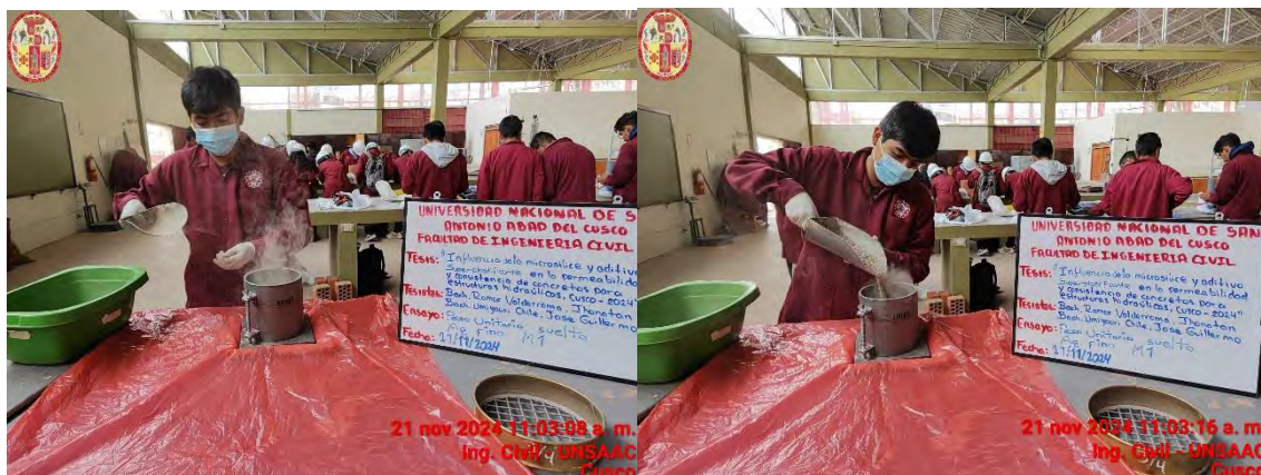
Fotografía N°27. Llenado del molde con el agregado fino en estado suelto.
