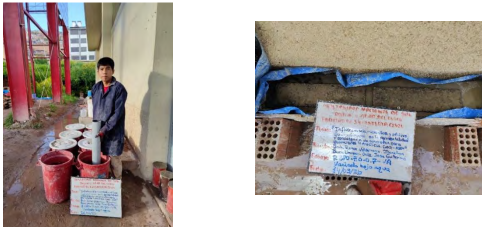
Figura. N°32. Vaciado bajo agua de briquetas y viguetas.
