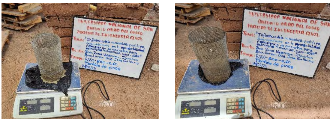
Figura. N°57. Resistencia a la pérdida de finos (Inicial: 2 070g, Final: 1 980g).
