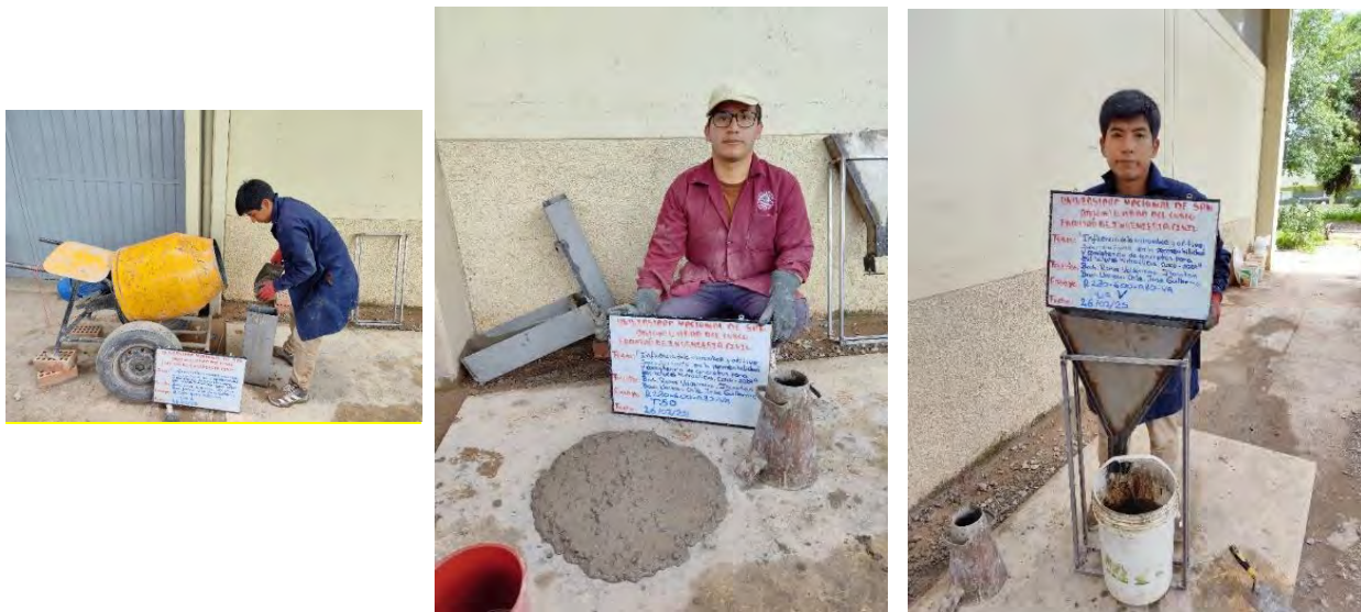
Figura. N°28. Ensayos de consistencia: Capacidad de paso, capacidad de llenado y viscosidad.
