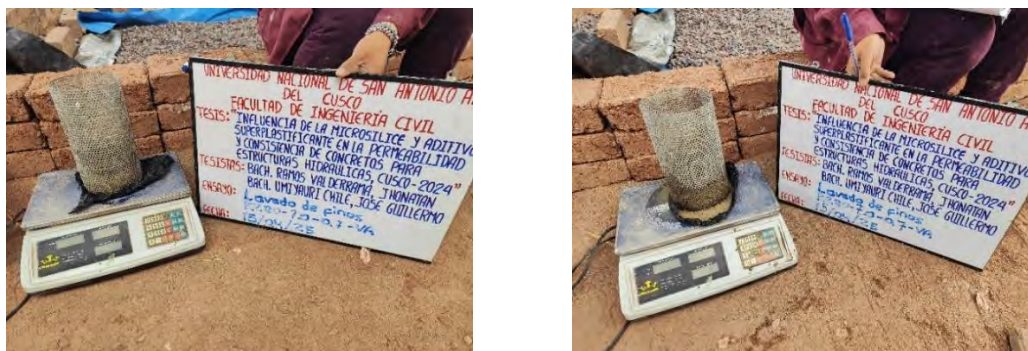
Figura. N°33. Resistencia a la pérdida de finos (Inicial: 2 315g, Final: 2 155g).
