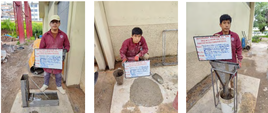
Figura. N°25. Ensayos de consistencia: Capacidad de paso, capacidad de llenado y viscosidad.
