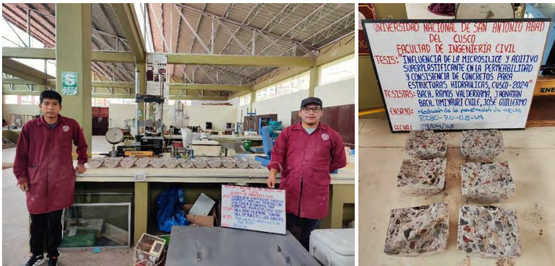
Figura. N°62. Muestras rotas producto de la penetración del agua f'c 280 \text{kg/cm}^2 .
