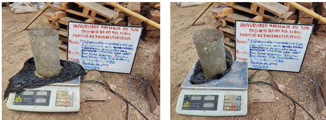
Figura. N°54. Resistencia a la pérdida de finos (Inicial: 2 100g, Final: 1 970g).
