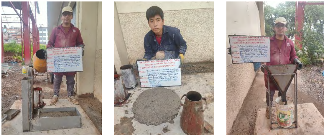
Figura. N°40. Ensayos de consistencia: Capacidad de paso, capacidad de llenado y viscosidad
