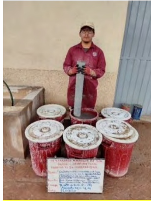
Figura. N°29. Vaciado bajo agua de briquetas y viguetas.
