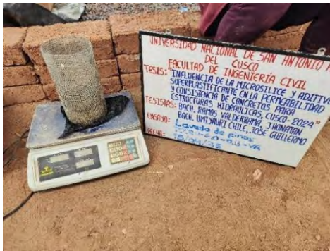
Figura. N°30. Resistencia a la pérdida de finos (Inicial: 2 150g, Final: 1 885g).
