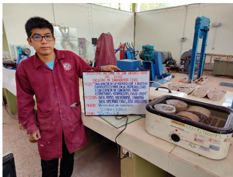
Figura. N°66. Muestra en inmersión para porosidad del concreto.
