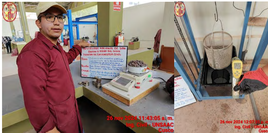
Fotografía N°9. Registro de peso en estado SSS y la temperatura del agua de inmersión
