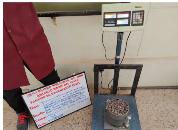
Fotografía N°12. Registro del peso unitario suelto del agregado grueso
