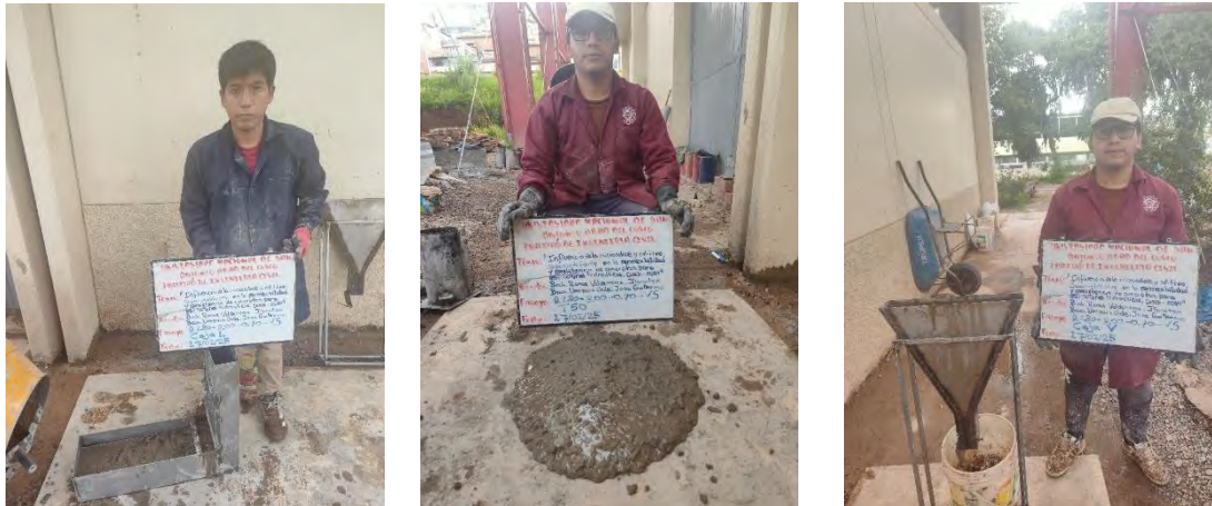
Figura. N°37. Ensayos de consistencia: Capacidad de paso, capacidad de llenado y viscosidad.
