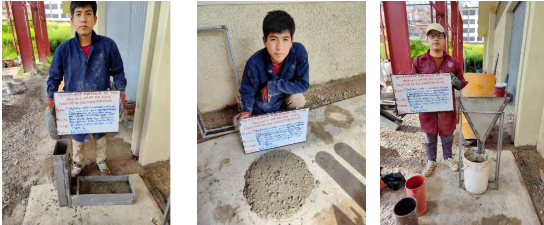
Figura. N°31. Ensayos de consistencia: Capacidad de paso, capacidad de llenado y viscosidad.
