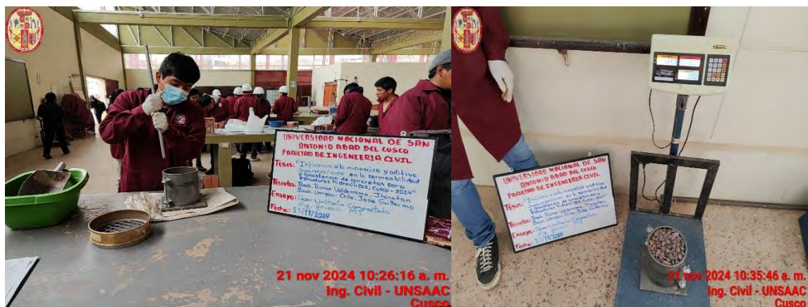
Fotografía N°13. Varillado del molde más el agregado grueso y el registro del peso
