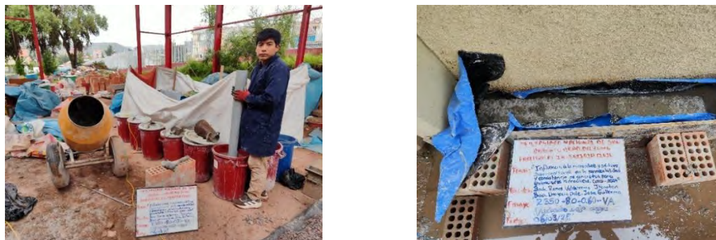
Figura. N°56. Vaciado bajo agua de briquetas y viguetas.
