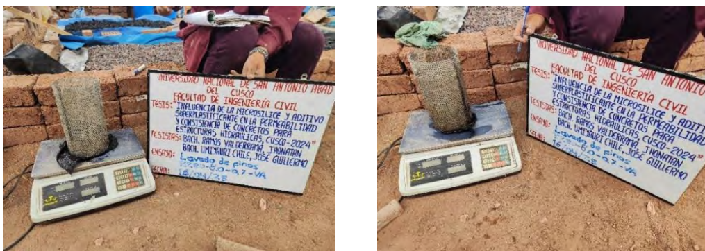
Figura. N°39. Resistencia a la pérdida de finos (Inicial: 2 165g, Final: 2 015g).
