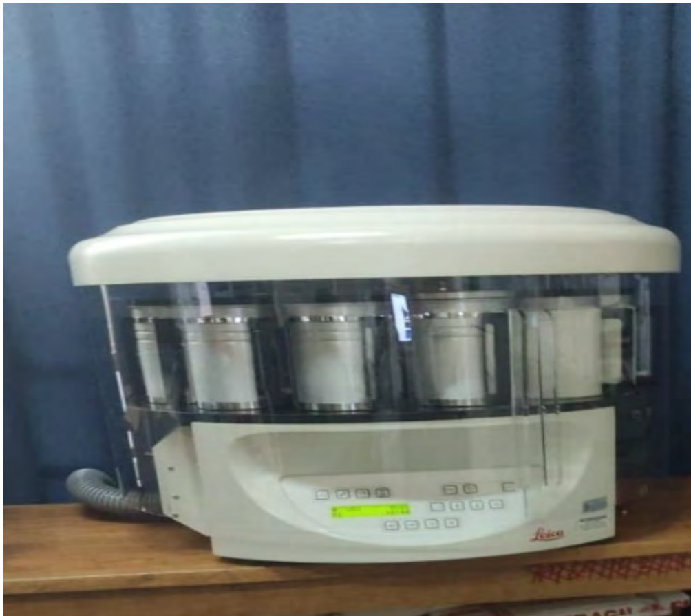
Figura 14. Procesamiento automatizado de muestras histológicas. Procesador automático de tejidos marca Leica, utilizado para el tratamiento de las muestras intestinales.
