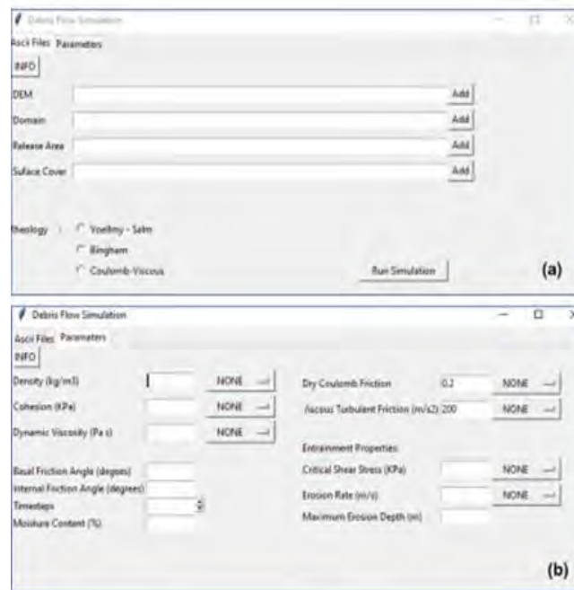
Figura 9: Interfaz para entrada de datos: (a) archivos ASCII y reología, y (b) entradas paramétricas.
