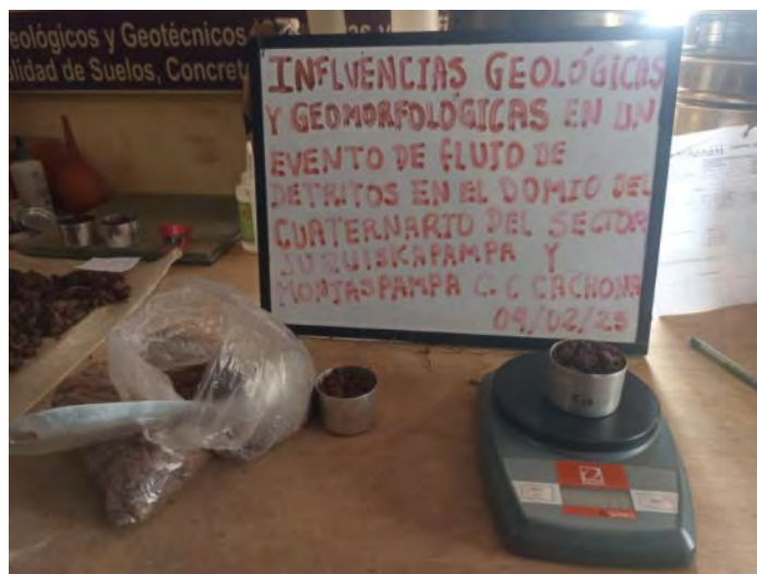
Figura 78: Ensayo de laboratorio para el contenido de humedad.
