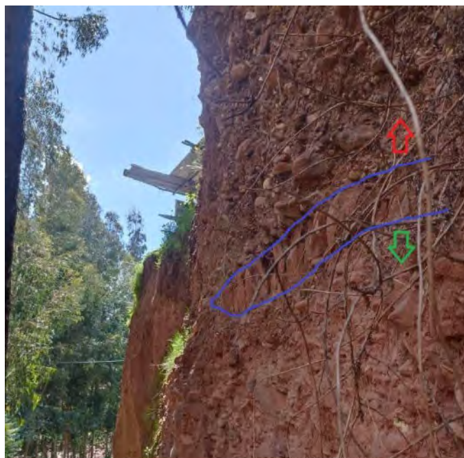
Figura 54: a) Deposito coluvial con lentes de arena de grano medio.
