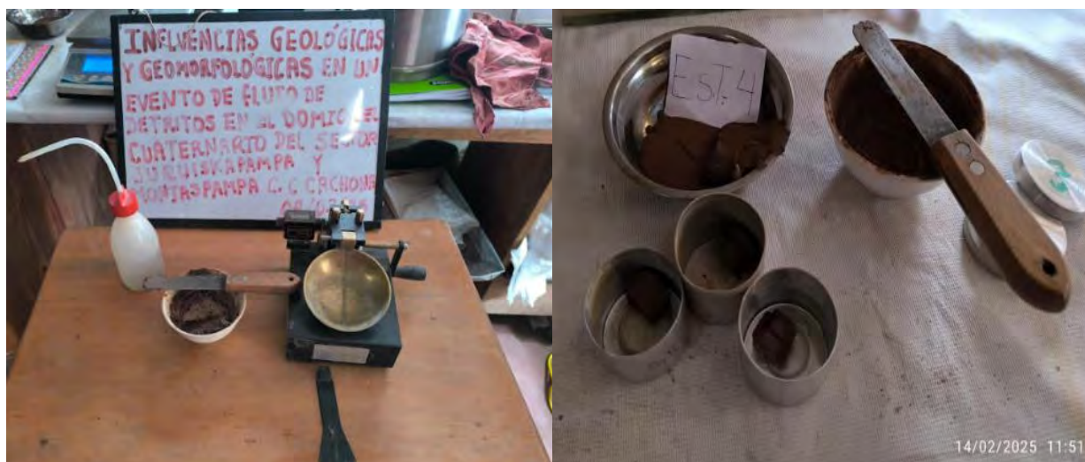
Figura 80: Ensayo límite líquido plástico.
