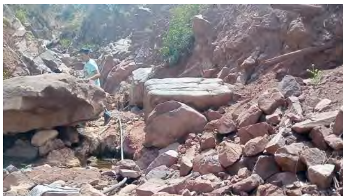
Anexo 1.17: Material colmatado en el rio Compimayo, bolones de 1.2m de diámetro.
