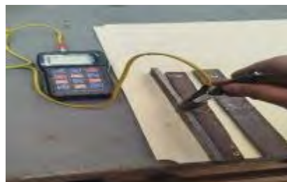
Midiendo la dureza del cordón soldadura
