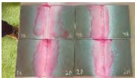
Probetas cubiertas con tinte penetrante
