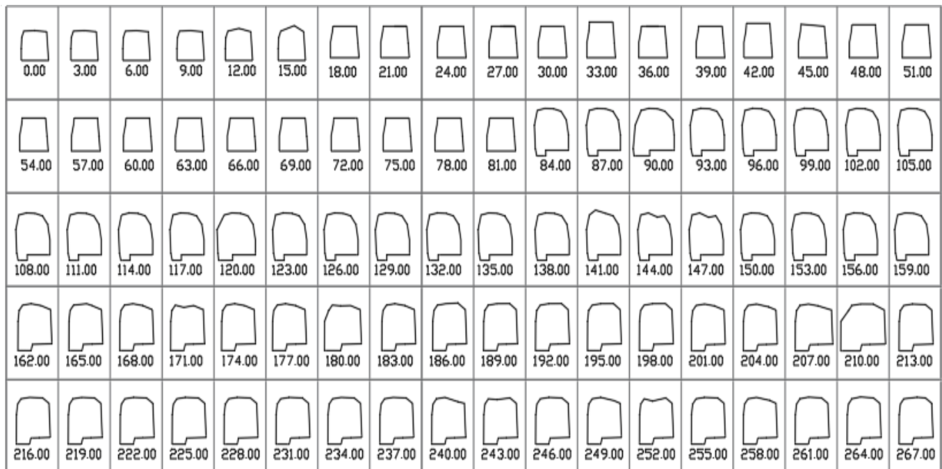
Figura 31. Secciones del túnel después del disparo de la progresiva 0 + 00, 0 + 267
