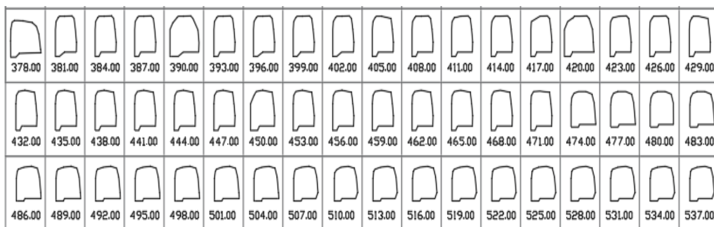
Figura 55. Secciones del túnel más uniformes (post voladura)
