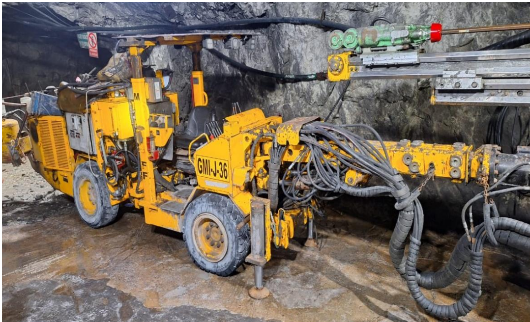
Figura 26. Jumbo frontonero para la perforación del frente de avance
