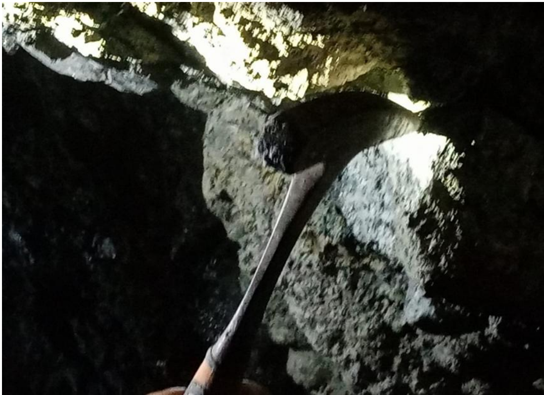
Figura 35. Determinacion de la resistencia a la compresión uniaxial con golpe de picota
