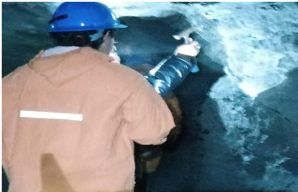
Figura 33. Determinacion de la compresión uniaxial con golpe de picota
