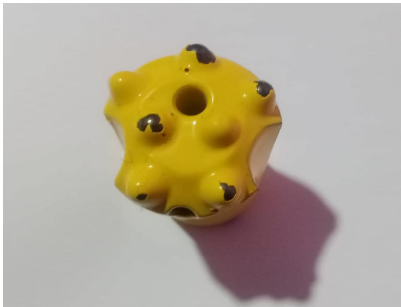
Figura 25. Broca de perforación de botones 45mm
