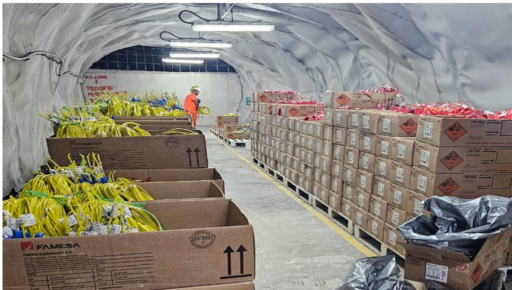
Figura 7. Fanel almacenado en polvorín interior mina
