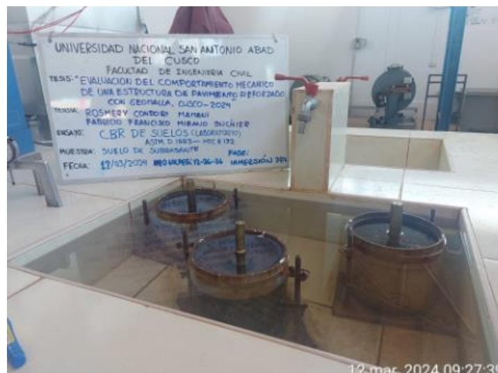
Fotografía 6 Moldes de CBR - Subrasante
