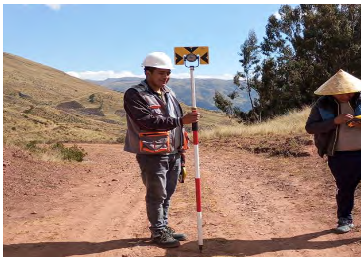
Ilustración 13. Levantamiento de eje del camino rural existente.
