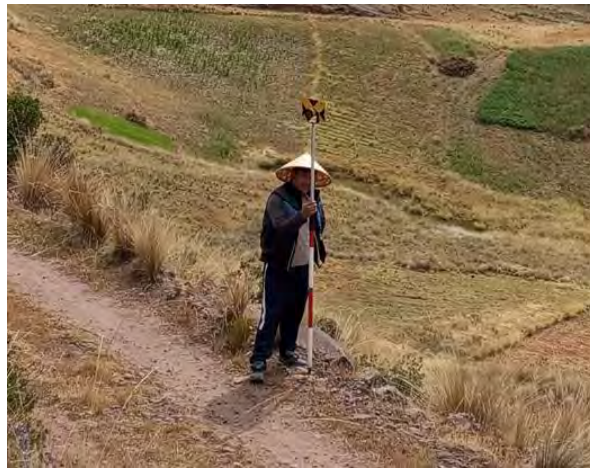
Ilustración 26. toma de puntos de la vía existente levantamiento topográfico comunidad de Huasampata.
