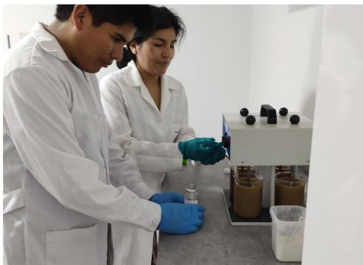
Fotografía N°06: ampliación de concentración de coagulante y floculante.
