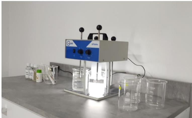
Fotografía N°05: equipo de prueba de jarras calibrado.
