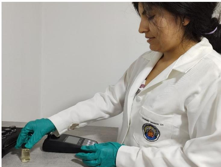
Fotografía N°08: lectura de turbidez después del tratamiento con equipo turbidímetro.
