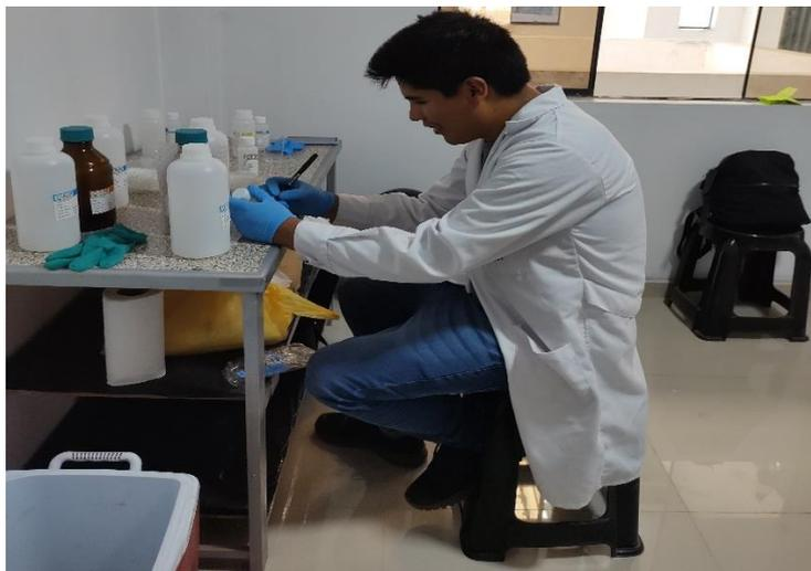
Fotografía N°09: toma de muestra del lixiviado tratado para los análisis bacteriológicos, fisicoquímico y metales pesados.
