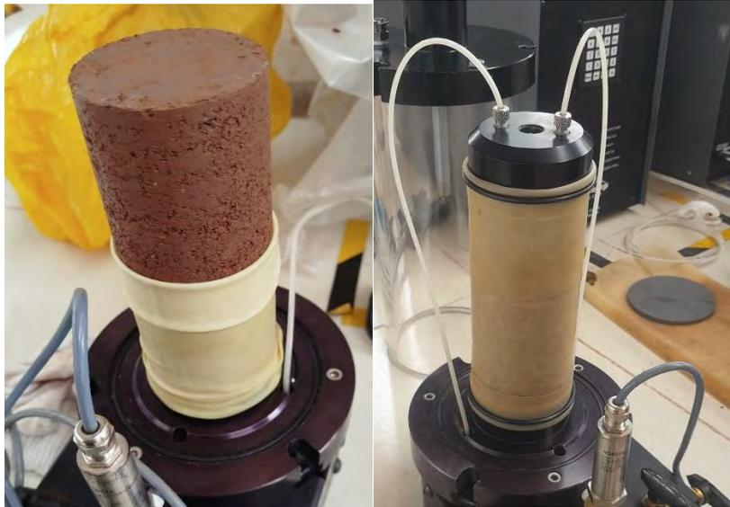
*Nota.* Muestras de diámetro 70 mm para ensayo de Modulo Resiliente del subtramo 1 correspondiente a las progresivas Km 0+000 - Km 04+000
