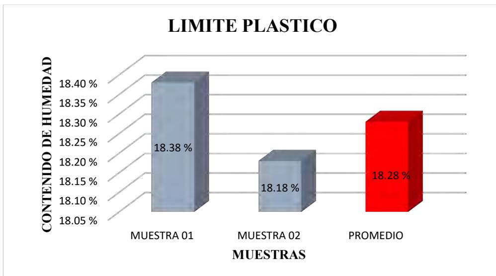
**Anexo A-2.5 Limite líquido, limite plástico e Índice de plasticidad de la calicata del kilómetro 05+360**
