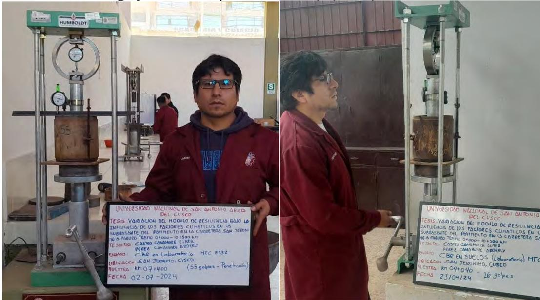
**Anexo B-5.3 Fotografías Ensayo CBR del primer subtramo**
