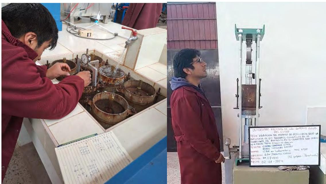
*Nota.* Lectura de moldes con dial de expansión y penetración de muestras para progresiva Km 02+200 y Km 03+060
