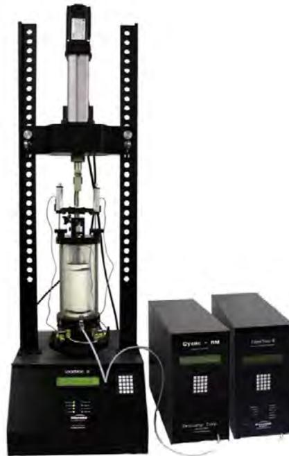
*Nota.* En la imagen se presenta el equipo *Standard Cyclic Triaxial LoadTrac II* utilizado para los ensayos de laboratorio. Fuente: «Resilient Modulus Test System», s. f.
