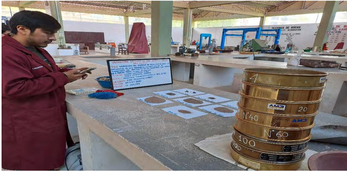
Anexo B-1.3 Fotografía del Análisis Granulométrico del segundo Subtramo
