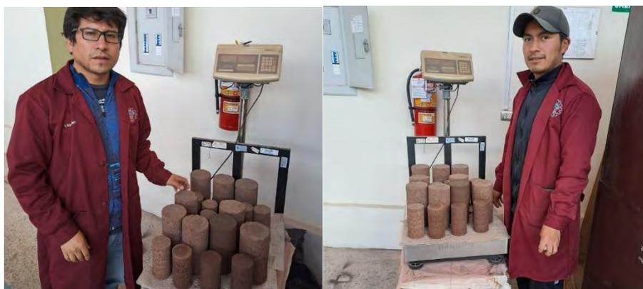
*Nota.* Se muestra los especímenes ensayados de 70 mm y 100 mm con diferentes contenidos de humedad.
