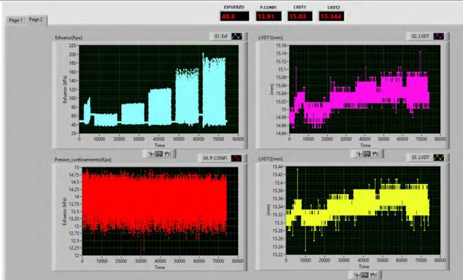
**Anexo A-5.2.1 AASTHO T 307-99 (2012) Ensayo de módulo de resiliencia Tipo de suelo "SC-SM" compactador al 95% de MDS, con el óptimo contenido de humedad (9.46%)**
