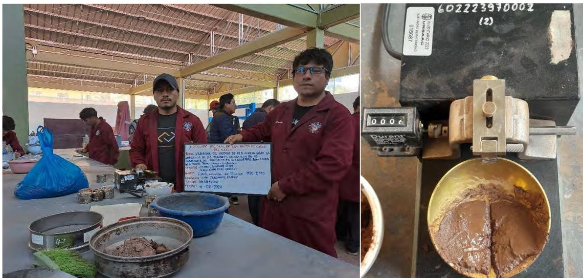
*Nota.* Se observa el procedimiento realizado para la obtención del Limite Liquido para la progresiva Km 08+300.
