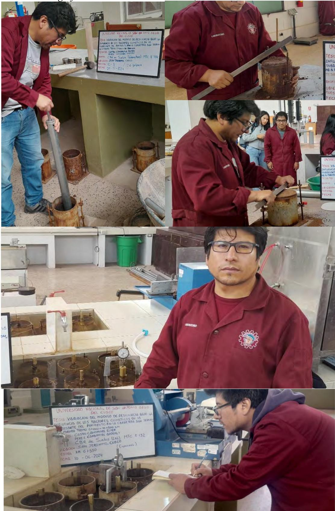
**Anexo B-5.2 Fotografías del Ensayo CBR en el equipo de penetración**
