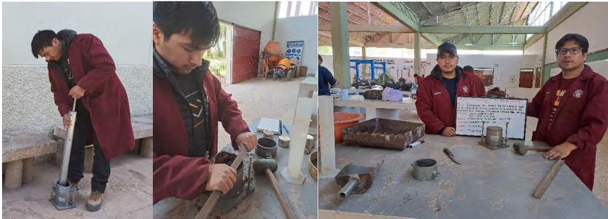
*Nota.* Se observa la compactación y enrasamiento con molde de 4" para la progresiva Km 03+060
