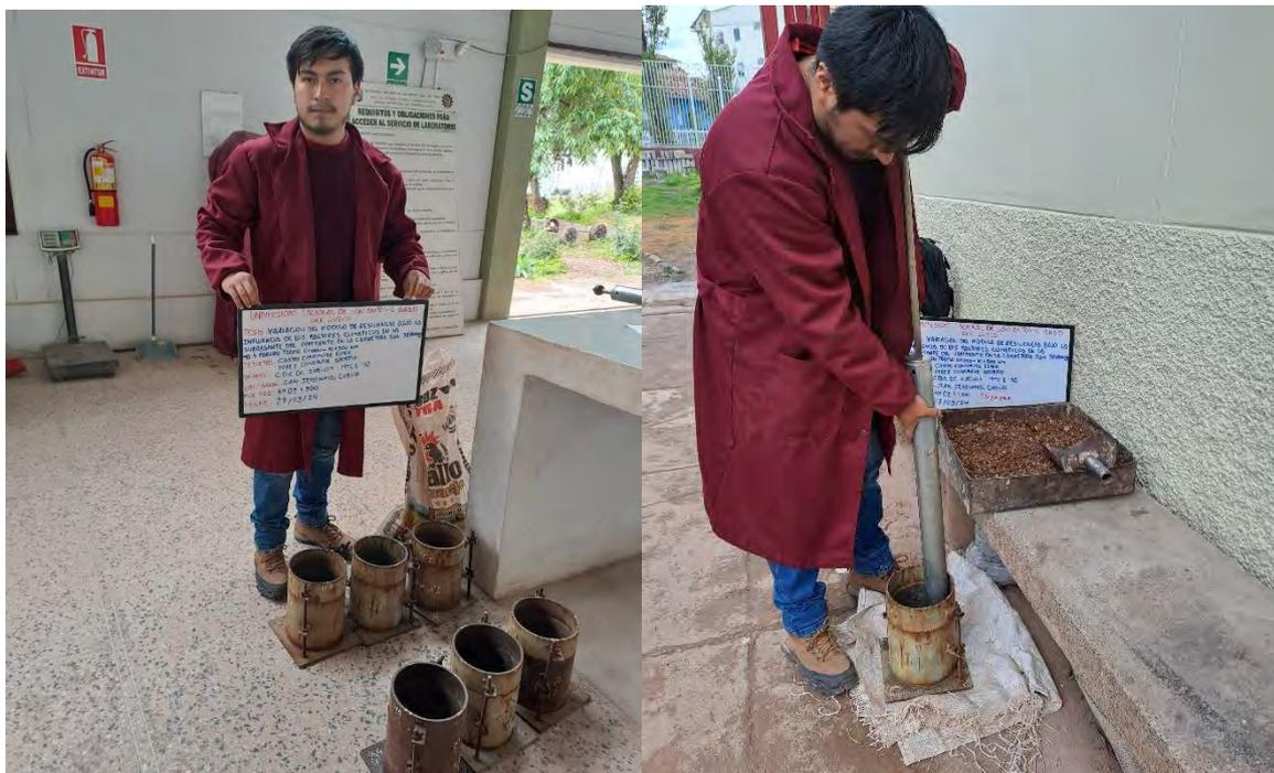
*Nota.* Preparación de moldes y compactación de CBR para progresiva Km 02+200 y Km 03+060
