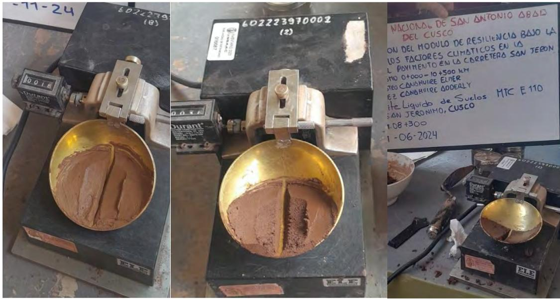
**Anexo B-2.3 Fotografías del Ensayo de limite de plasticidad del primer, segundo y tercer subtramo**
