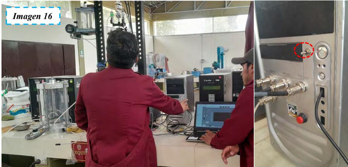
Ejecute el software en la computadora, configure los valores correspondientes para subrasante e inicie la prueba.
