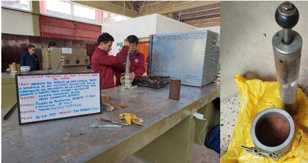
*Nota.* Compactación y elaboración de muestras de diámetro 100 mm para ensayo de Modulo Resiliente del subtramo 2.
