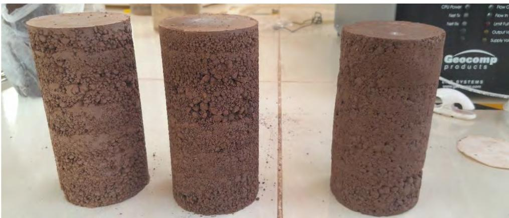
*Nota:* Para el ensayo de módulo resiliente correspondiente al subtramo 1, se utilizaron especímenes cilíndricos de 70 mm de diámetro, en la figura se muestra tres condiciones de humedad distintas: una muestra con humedad reducida al 2.8 %, otra compactada al contenido óptimo, y una tercera completamente saturada. Fuente: Elaboración propia.
