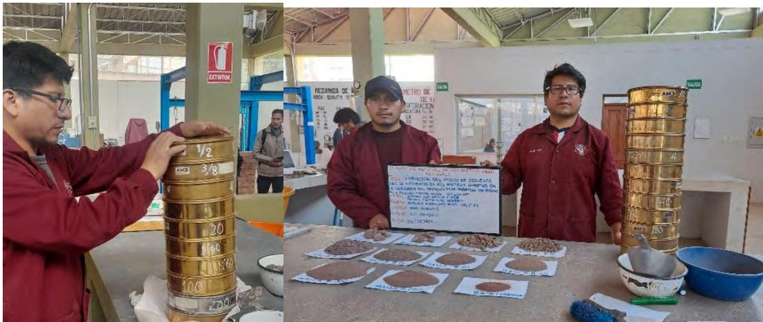
*Nota.* Se observa el procedimiento de tamizaje y obtención de material retenido de mallas para la granulometría de la progresiva Km 09+630.
