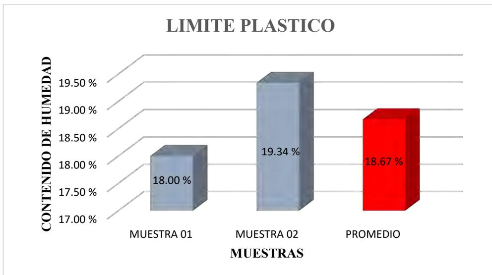
**Anexo A-2.6 Limite líquido, limite plástico e Índice de plasticidad de la calicata del kilómetro 06+550**
