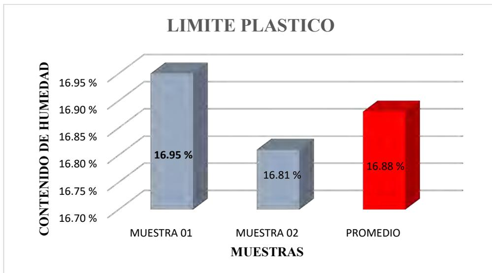
**Anexo A-2.4 Limite líquido, limite plástico e Índice de plasticidad de la calicata del kilómetro 04+040**
