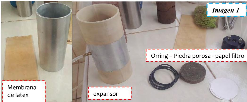
Primeramente, coloque una piedra porosa y un papel filtro en la parte superior de la base de la muestra de la cámara triaxial como se muestra en la Figura, posteriormente sobre ella con mucho cuidado se colocará la muestra cilíndrica.
