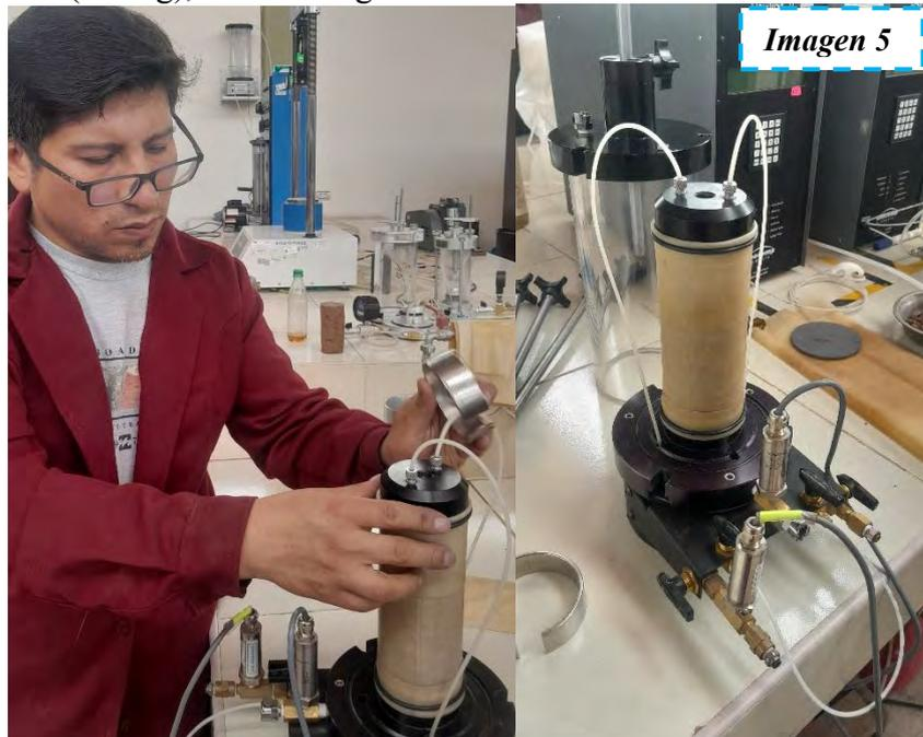
Coloque la c mara en la placa base y la placa de cubierta en la c mara. Inserte el pist n de carga y obtenga una conexi n firme con la celda de carga y la muestra.
