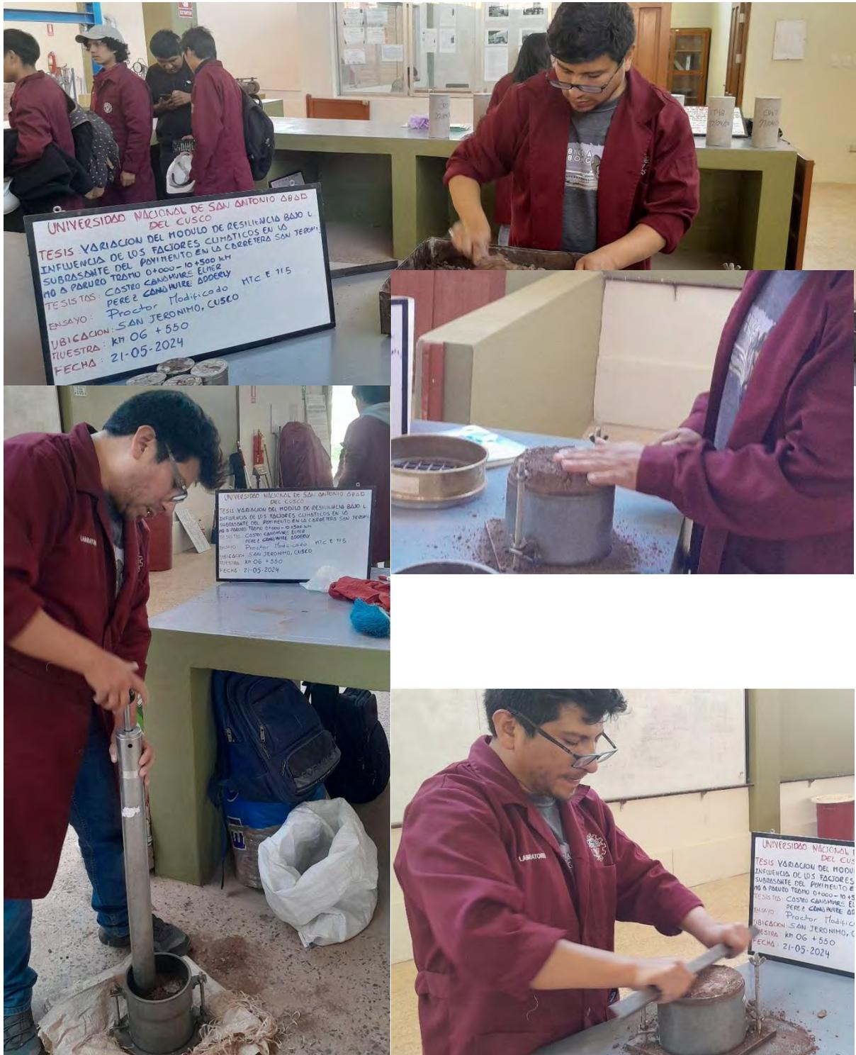
Anexo B-3.2 Fotografía del Ensayo de Proctor modificado del primer subtramo
