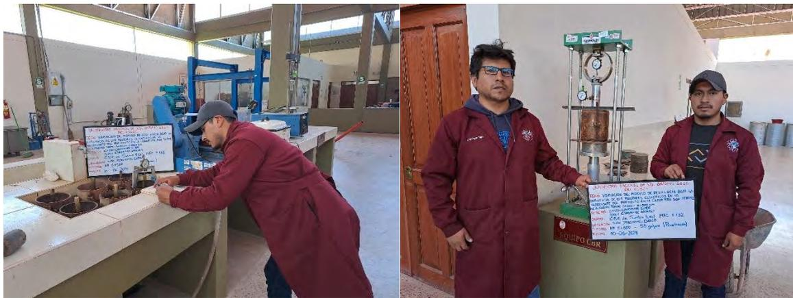
*Nota.* Lectura de muestras con dial de expansión y penetración de muestras para progresiva Km 06+550
