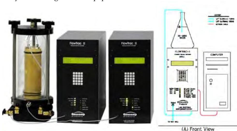
*Nota.* En la imagen se presenta el equipo *FlowTrac II* utilizado para los ensayos de laboratorio. Fuente: «Resilient Modulus Test System», s. f.
