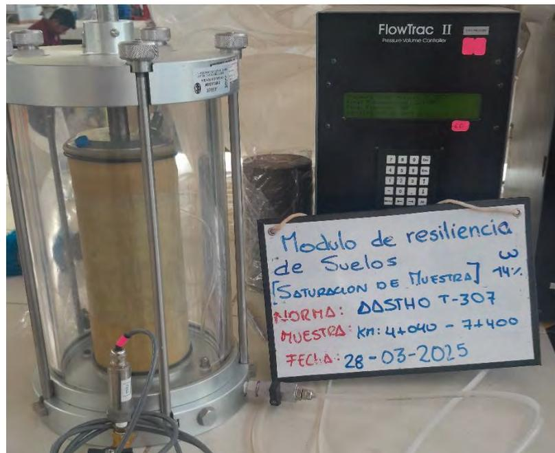
*Nota.* Muestras de diámetro 100 mm para ensayo de Modulo Resiliente del subtramo 2, para llegar a su saturación, se procedió a utilizar el equipo FlowTrac II, el cual nos permite incrementar el contenido de agua de las muestras. Fuente: Elaboración propia
