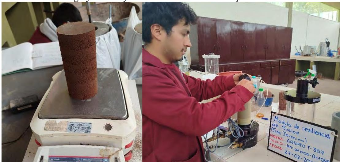
Anexo B-6.2 Fotografías del Ensayo de Modulo de resiliencia control y monitoreo
