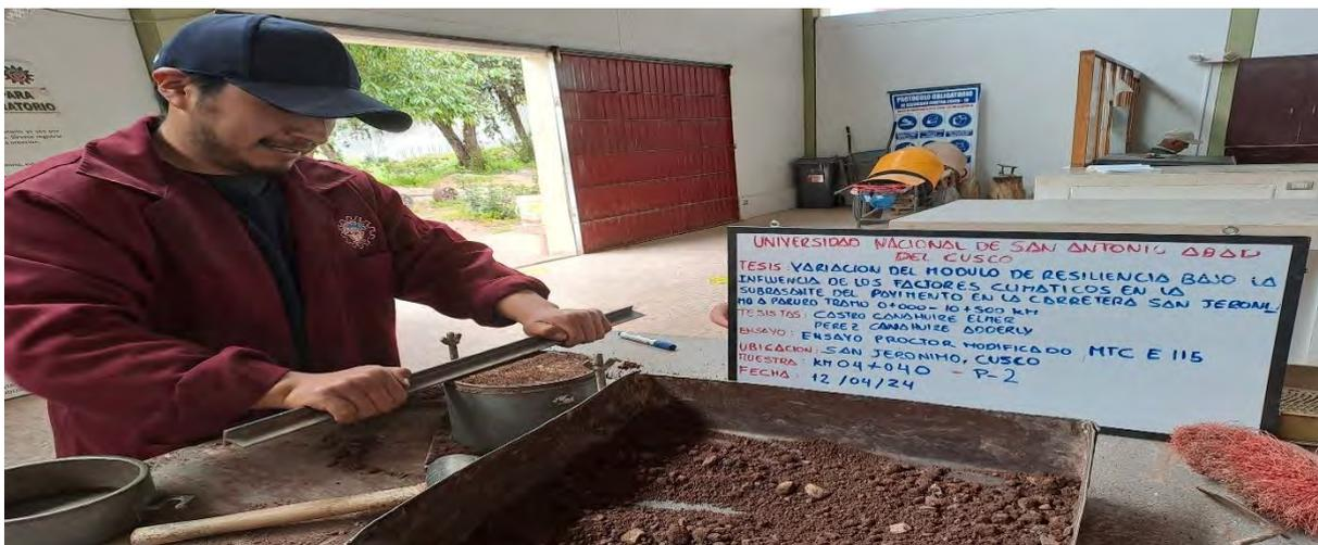
Anexo B-3.4 Fotografía del Ensayo de Proctor modificado del tercer subtramo
