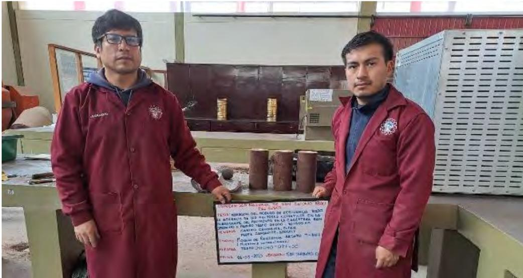
*Nota.* Muestras de diámetro 100 mm para ensayo de Modulo Resiliente del subtramo 2 correspondiente a las progresivas Km 04+000 - Km 07+500
