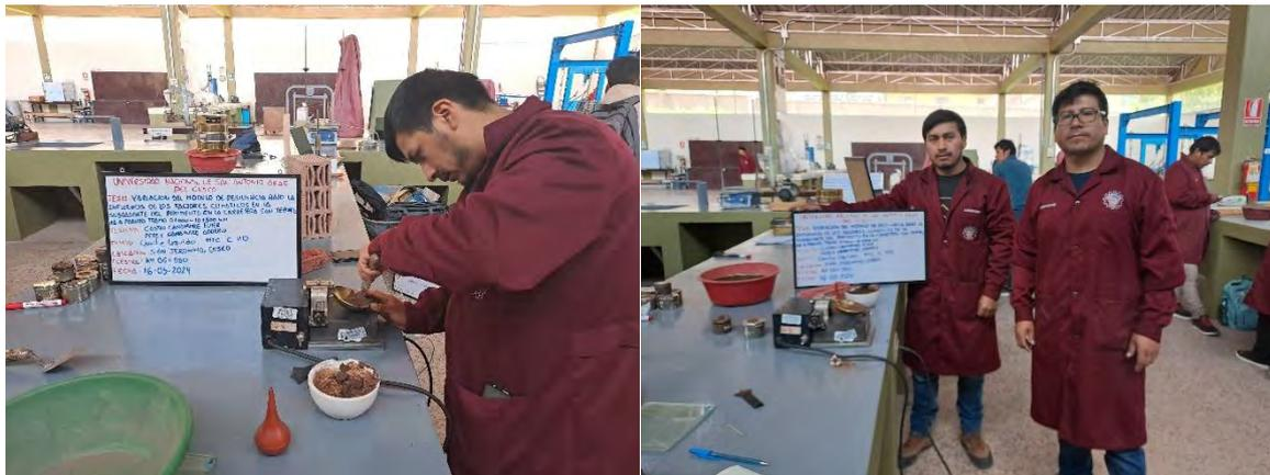
*Nota.* Se observa el procedimiento realizado para la obtención del Limite Liquido para la progresiva Km 06+550.
