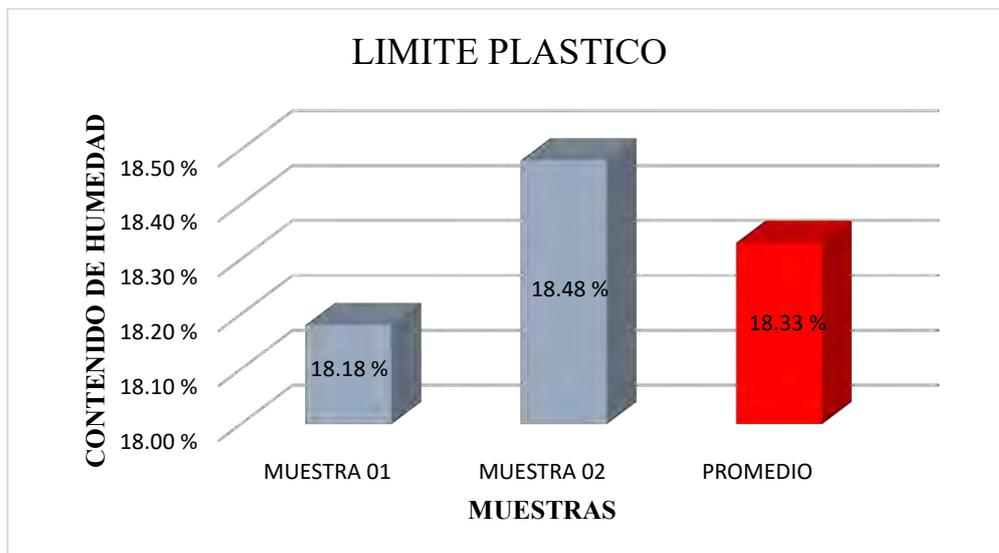
**Anexo A-2.10** *Limite líquido, limite plástico e Índice de plasticidad de la calicata del kilómetro 10+500*
