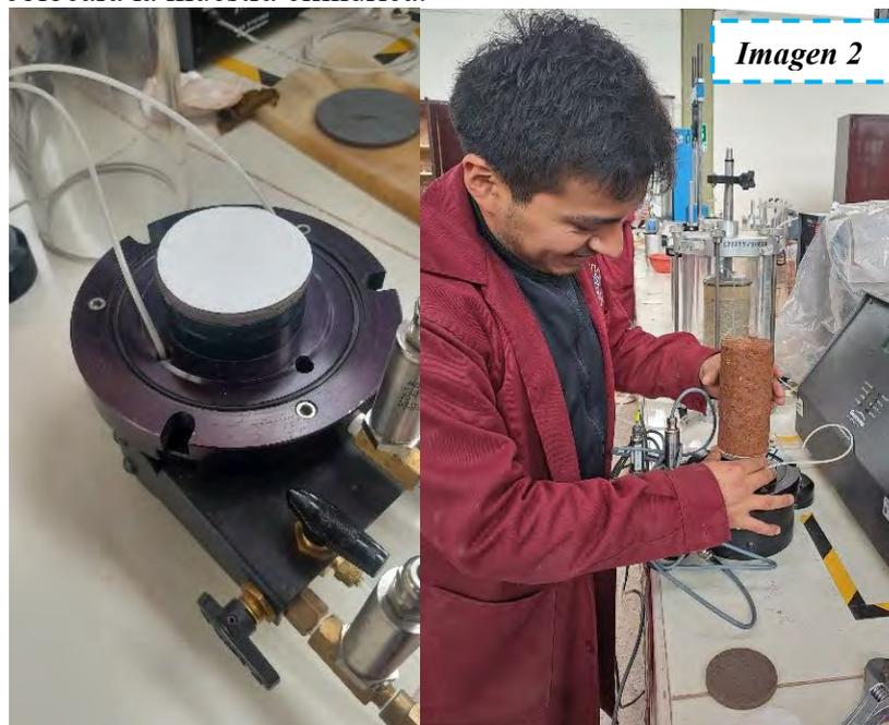
La membrana ya puesta en el expansor de membrana, se procederá a cubrir la muestra. Para ello aplique vacío al expansor de membrana, luego coloque con cuidado la membrana sobre la muestra y retire el vacío y el expansor de membrana. (Véase las imágenes como referencia)
