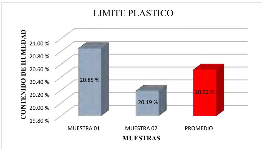
**Anexo A-2.7 Limite líquido, limite plástico e Índice de plasticidad de la calicata del kilómetro 07+400**
