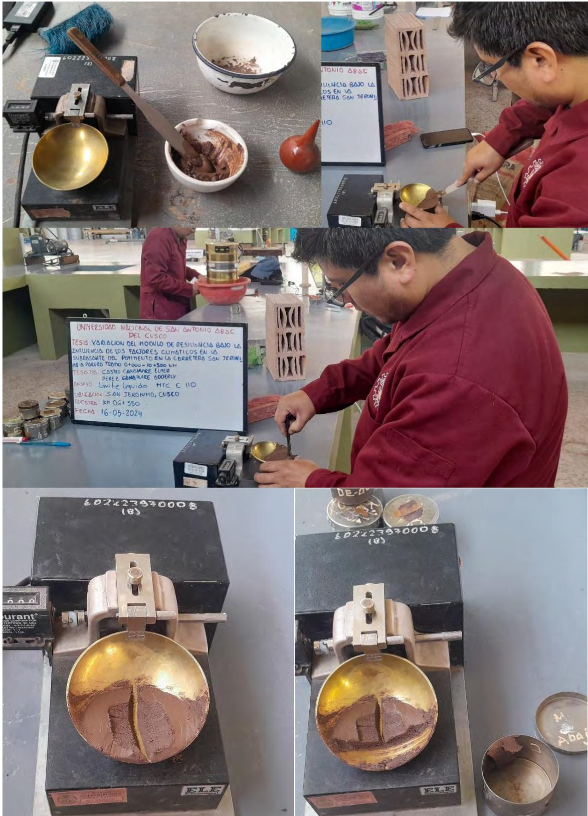
**Anexo B-2.2 Fotografías del Ensayo de limite liquido del primer, segundo y tercer subtramo**
