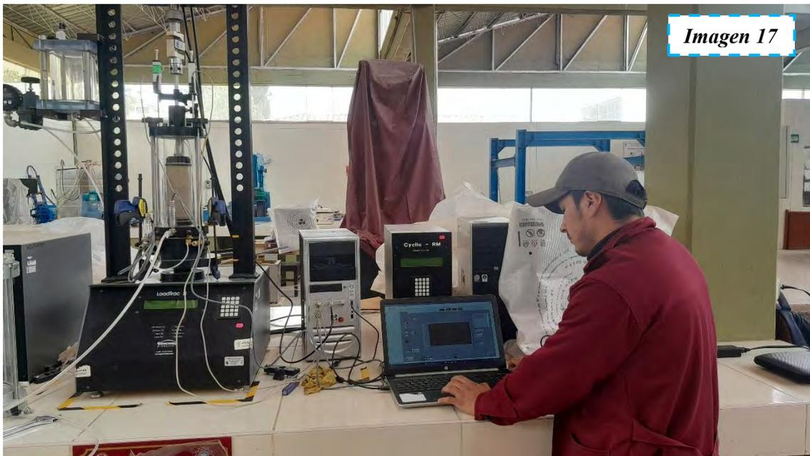
En el ejecutable le introduciremos, los parámetros necesarios para el ensayo, como son el diámetro de la muestra, la cantidad de ciclos de acondicionamiento.
