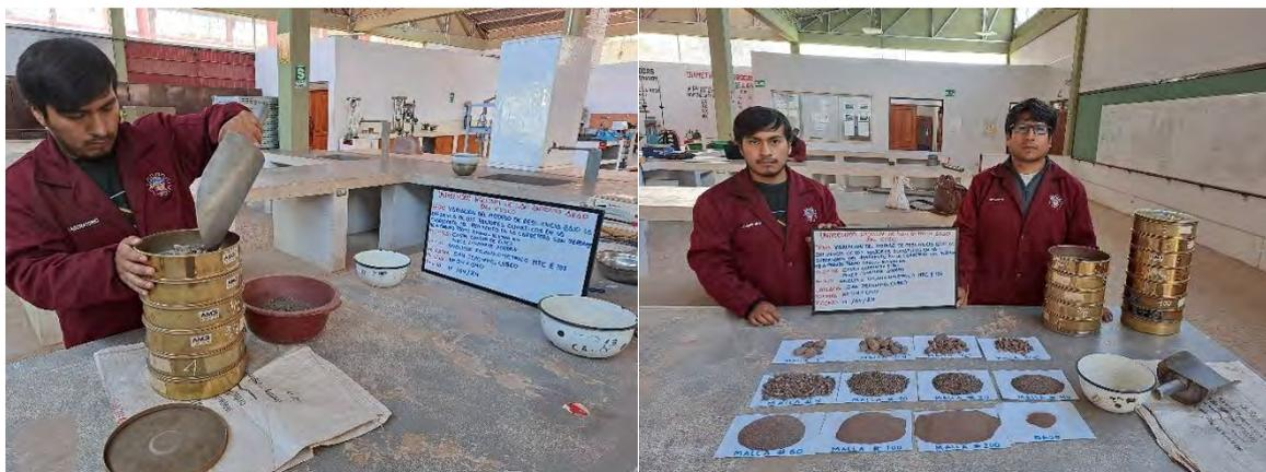
*Nota.* Se observa el procedimiento de tamizaje y obtención de material retenido de mallas para la granulometría de la progresiva Km 04+040.
