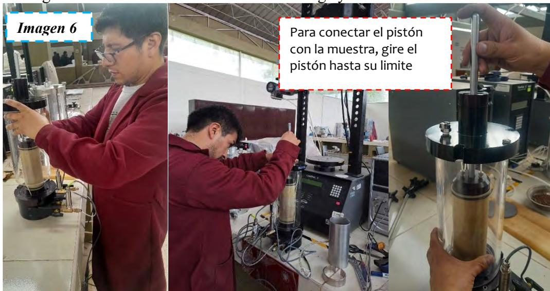
Asegura la celda triaxial fuertemente con las perillas de poste, posterior a ello coloque los LVDT's sobre la celda triaxial, tome como referencia la figura.
