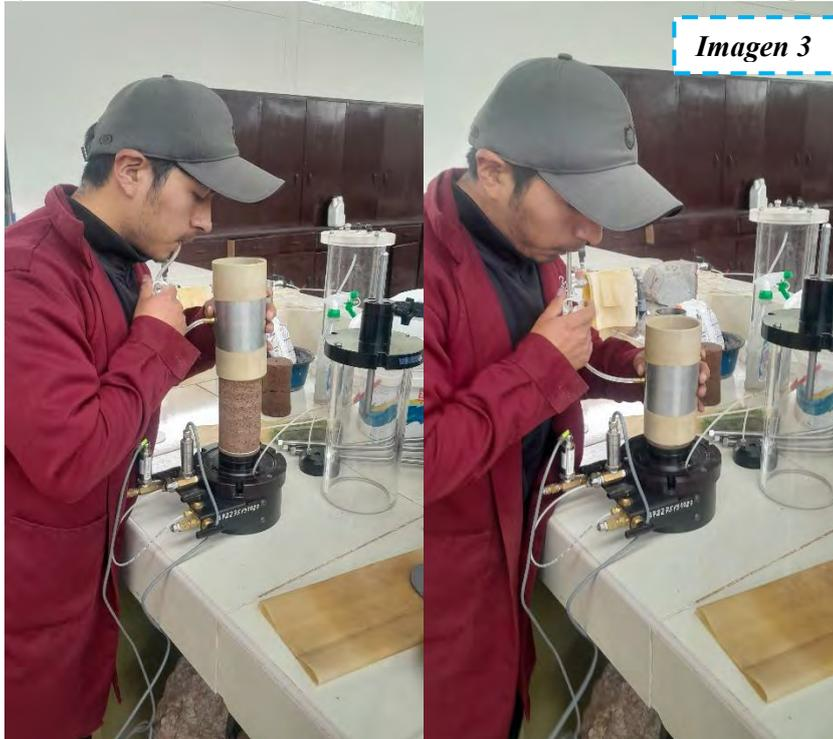
Antes de retirar el expansor coloque un filtro de papel sobre la muestra en la parte superior y la piedra porosa, suelte la membrana del expansor y selle la membrana a la placa inferior con dos juntas tóricas (Orring).
