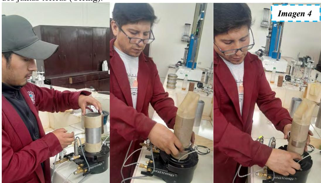
Coloque la placa superior sobre la muestra, doble la membrana y s ello a la placa superior con dos juntas t oricas (Orring), utilice la figura como referencia.
