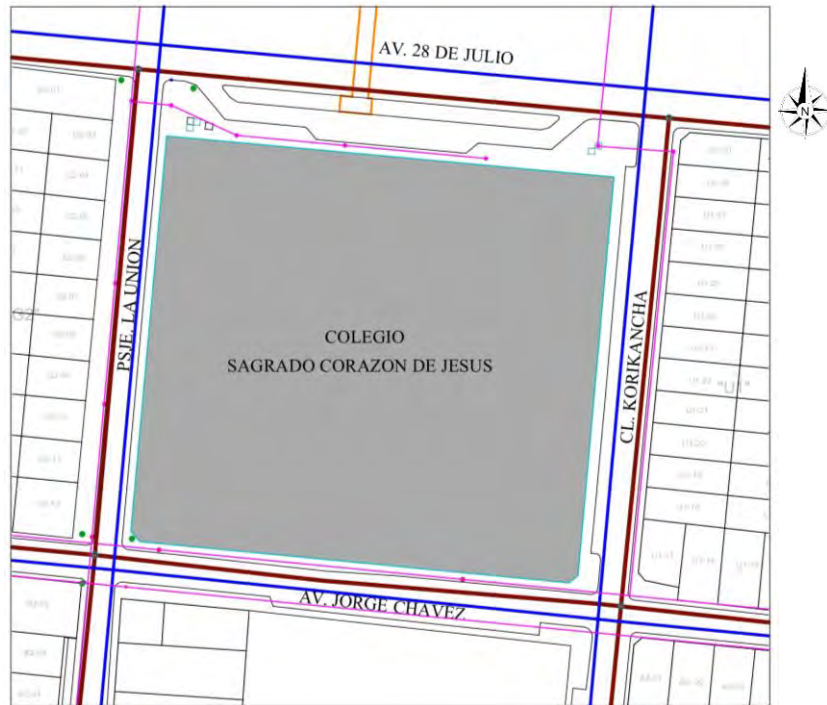
Figura 65. Servicios básicos: agua, electricidad y desagüe en el contexto inmediato.
