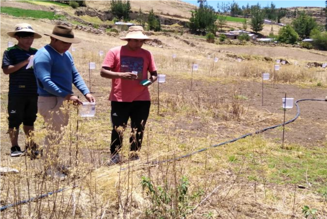
Anexo 22: Pluviómetro en plena evaluación, con contenido de agua colectada.
