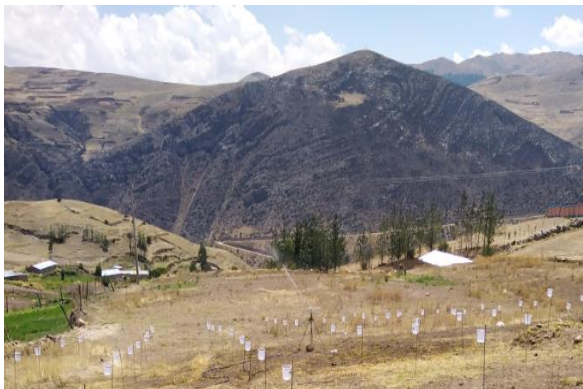
Anexo 09. Evaluación del aspersor F30, en pendiente 3.8 % en marco de riego 18 x 18 m.
