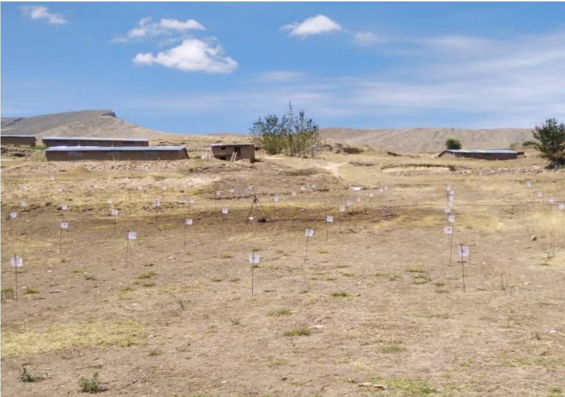
Anexo 11: Evaluación del aspersor VYR 35, en pendiente simulado de 10.6 % enmarco de riego 18 x 18 m.
