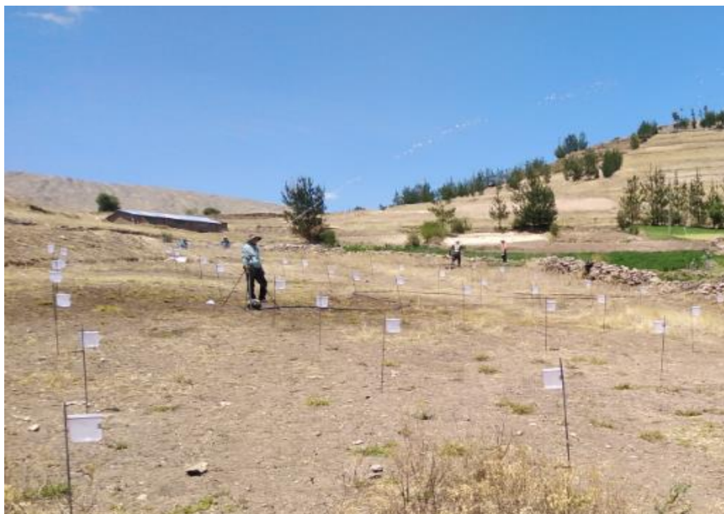
Anexo 12: Evaluación del aspersor VYR 70, en pendiente simulado de 10.6 % enmarco de riego 18 x 18 m.
