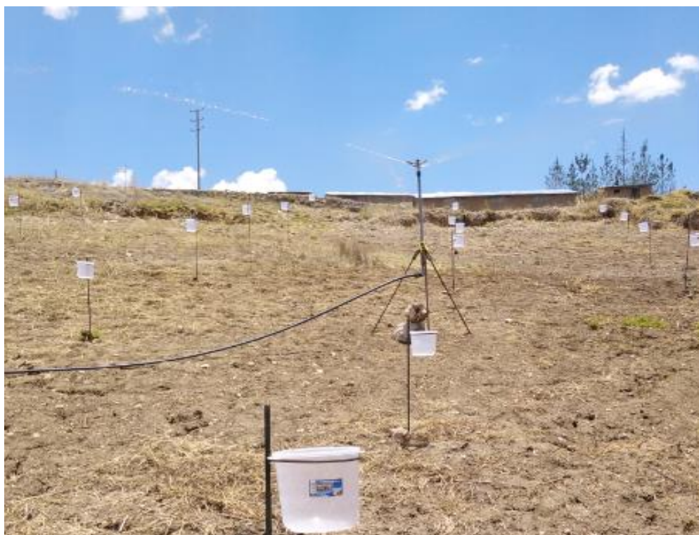
Anexo 17: Evaluación del aspersor F30, en pendiente de 21.50 % enmarco de riego 18x18
