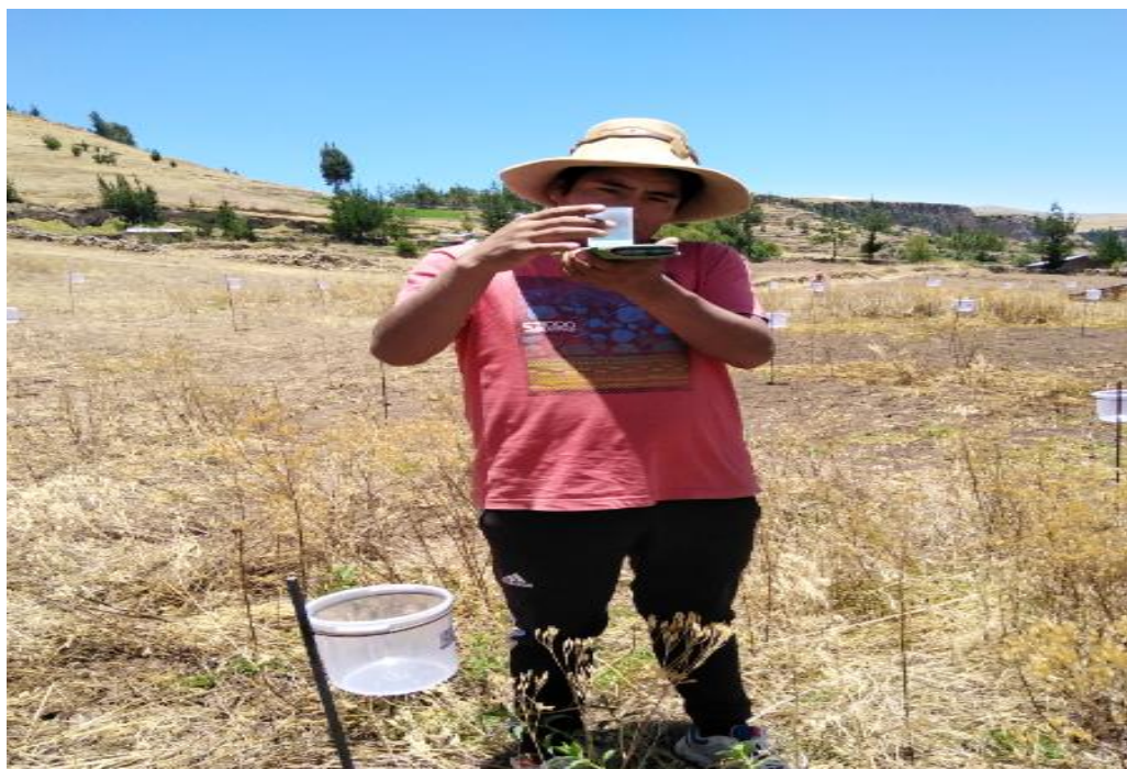
Anexo 18: Lectura del agua colectada en los pluviómetros con probetas de 250y 25 ml, durante las evaluaciones.
