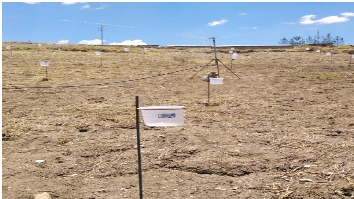
Anexo 16: Evaluación del aspersor VYR 70, en pendiente de 21.50% en marcode riego 18x18 m.
