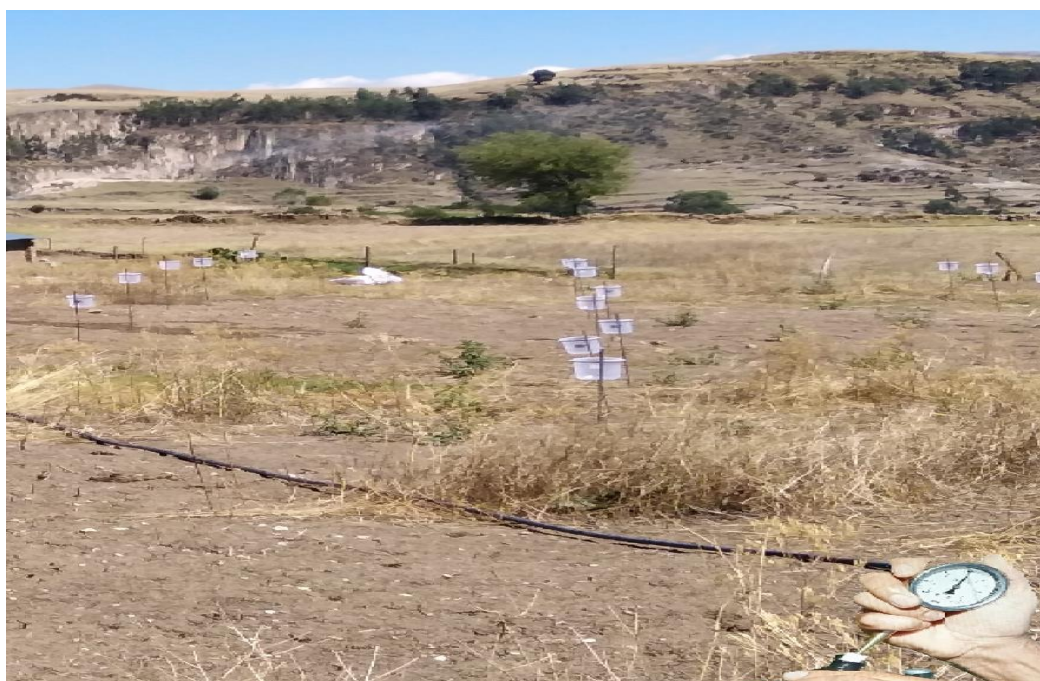
Anexo 19: Evaluación de la presión de funcionamiento de los aspersores conmanómetro en unidad de medida bar.
