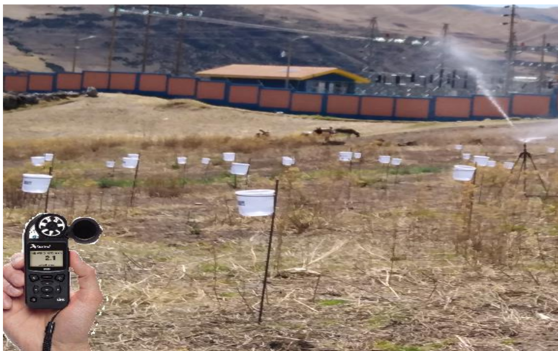
Anexo 20: Evaluación de la velocidad de viento con anemómetro Manual en m/s.
