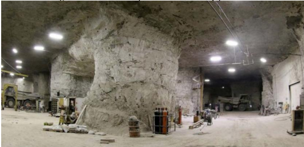
Figura 3. Método de explotación, cámaras y pilares
