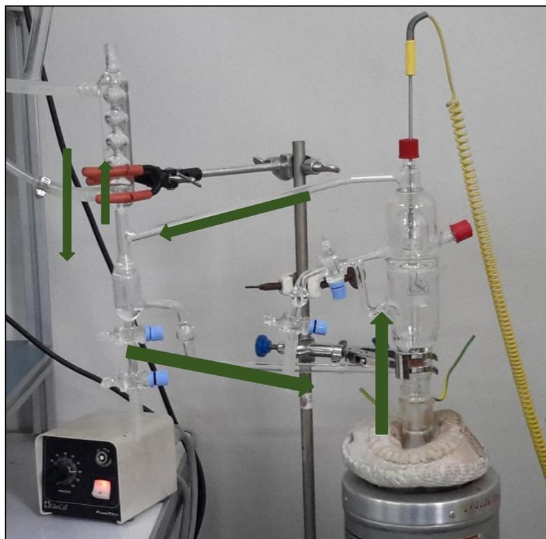
**Figura D1.** Ebullómetro de vidrio que describe el funcionamiento obtenido de (Pinto H., 2021)
