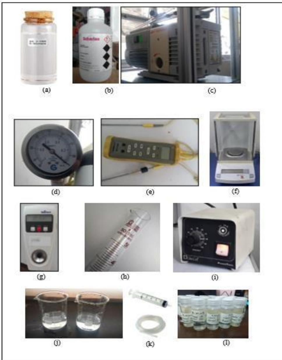
**Nota.** a=Limoneno, b=Hexanol, c=bomba de vacío, d=vacuómetro, e=termómetro digital, f=Balanza digital, g=Refractómetro, i=control de potencia Glas,
