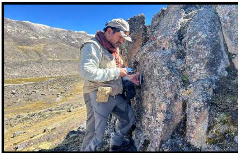
*Foto 30 Medición del plano de diaclasas del miembro Sapanuta, margen derecho de la Quebrada Huayllani*
