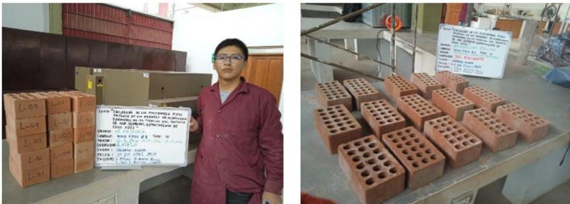
*Nota.* En la imagen se observa el desarrollo del ensayo de Absorción de las unidades de albañilería.
