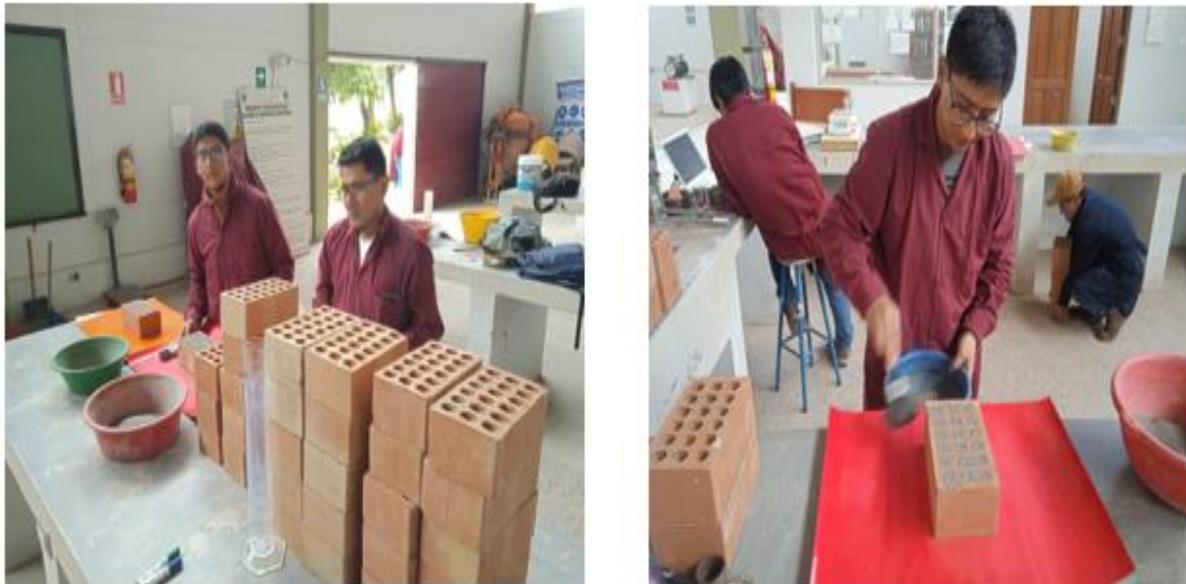
*Nota.* En la imagen se observa el desarrollo del ensayo de porcentaje de vacíos de las unidades de albañilería.
