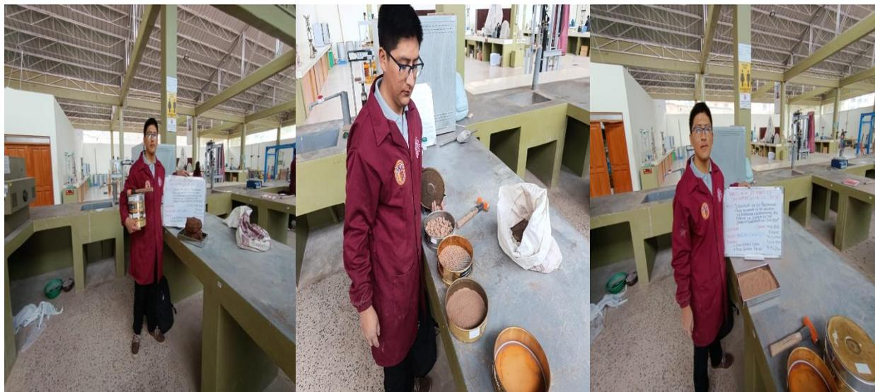
*Nota.* En la imagen se observa la preparación, pulverización y tamizado de la muestra con la finalidad de uniformizar el tamaño de la muestra.
