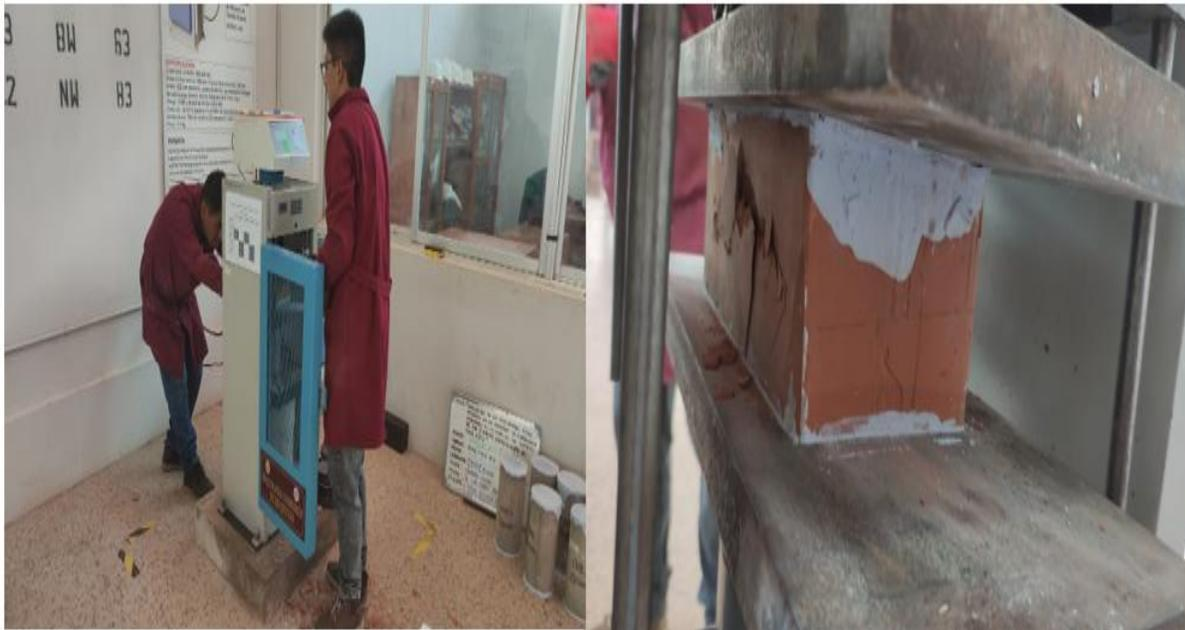
*Nota.* Desarrollo del ensayo de resistencia a compresión de unidades de albañilería.
