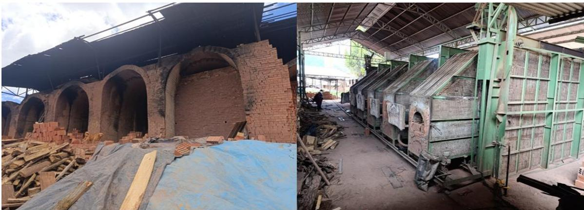
*Nota.* En las imágenes se observa las unidades en proceso de secados de forma natural sin el empleo de ventiladores mecánicos. Fuente: Elaboración Propia.
