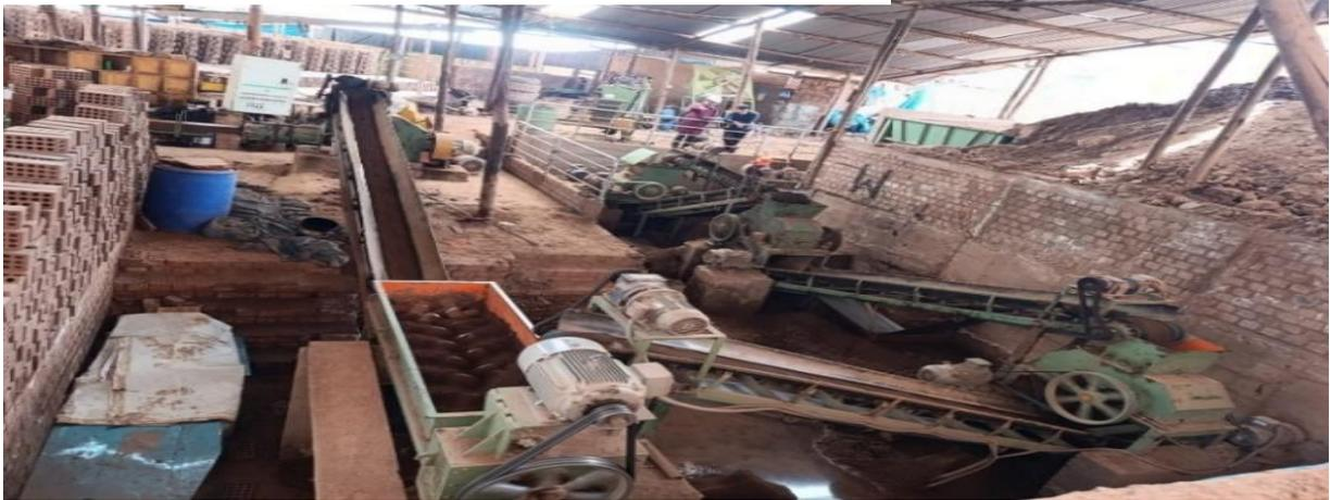
*Nota.* En las imágenes se observa el proceso de mezcla de la materia prima, y luego transportada a través de fajas a la máquina de laminado. Fuente: Elaboración Propia.
