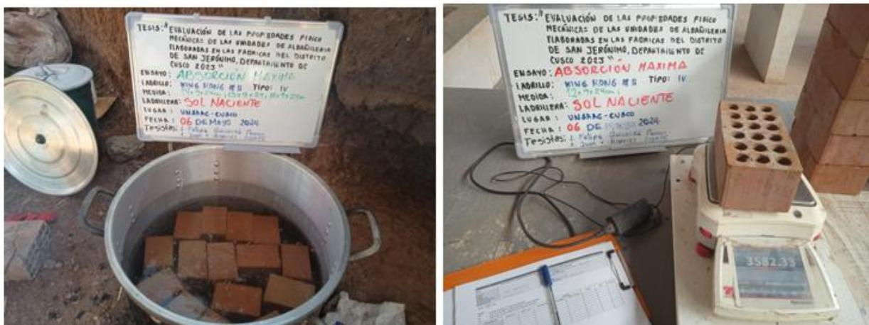
*Nota.* En la imagen se observa el desarrollo del ensayo de Absorción máxima de las unidades de albañilería.
