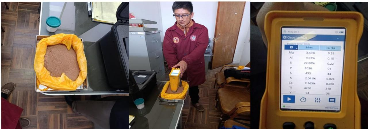
*Nota.* Mediante el equipo espectroscopía de fluorescencia de rayos X se determinó la relación de elementos químicos que se encuentran en la arcilla proveniente de la cantera de San Jerónimo.
