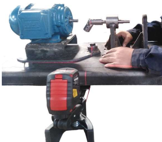
Fig. 6.6. Prueba de alineamiento de eje de motor y junta universal
