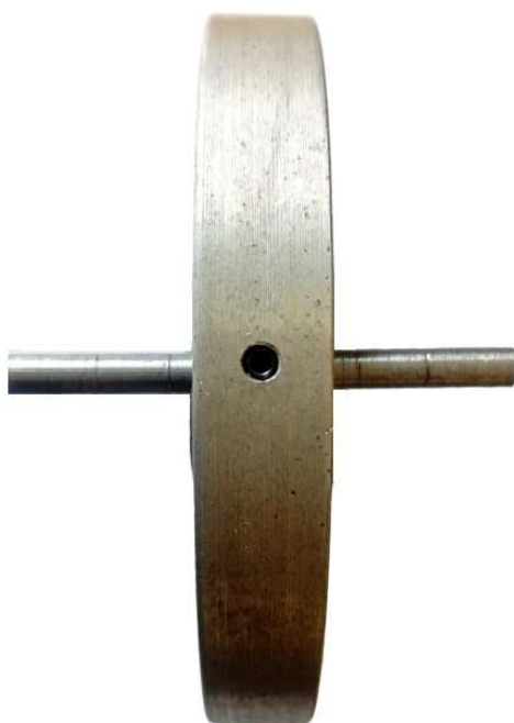
Fig. 6.4. Montaje del eje del péndulo en el volante de inercia
