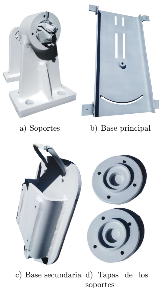
Fig. 6.13. Pintura anticorrosiva aplicada a los componentes del módulo
