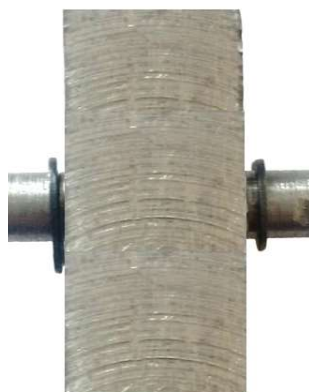
Fig. 6.11. Restricción de desplazamiento axial del péndulo mediante anillos de retención
