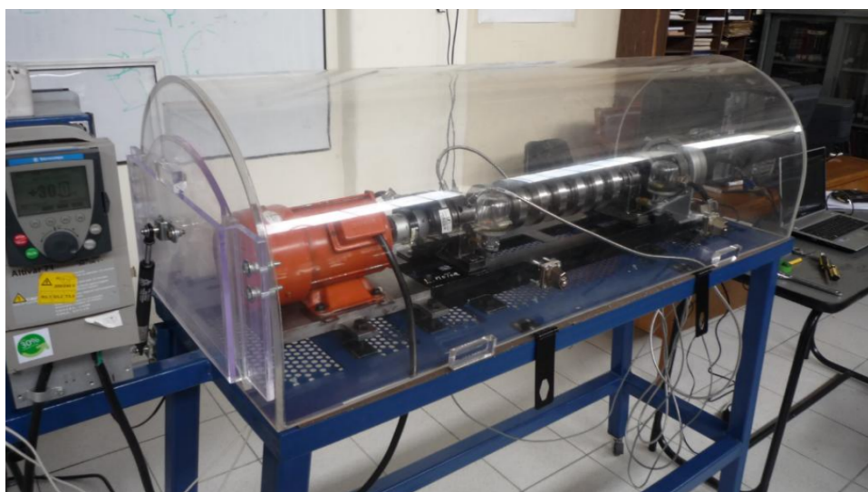
Fig. 2.10. Banco de pruebas de vibraciones laterales y torsionales. [38]
