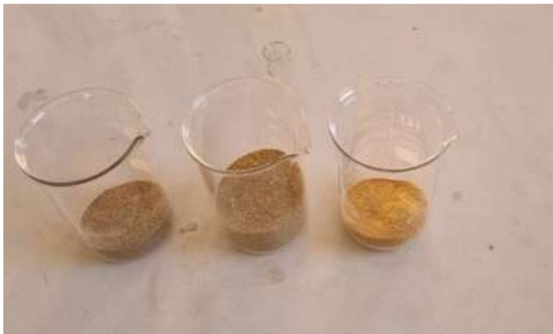
Foto 6. Bioadsorbentes obtenidos MA, CB y EP para ser utilizados en todos los procesos de adsorción
