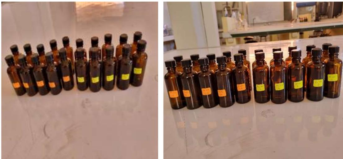
Foto 8 Muestras filtradas de las soluciones acuosas de Pb (II) y Cd para el análisis por absorción atómica
