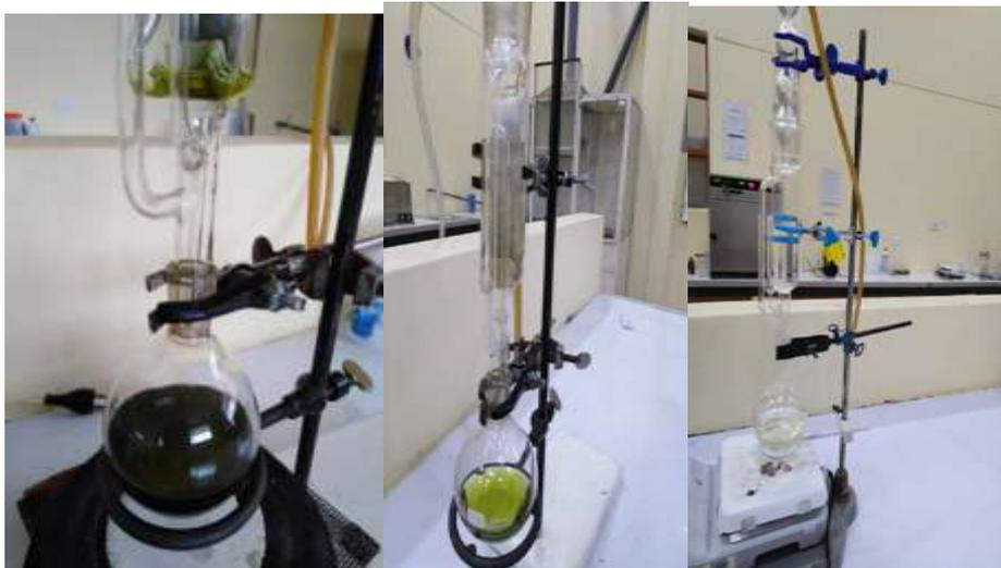
Foto 4. Extracción de clorofila de MA y CB por el método de shoclet
