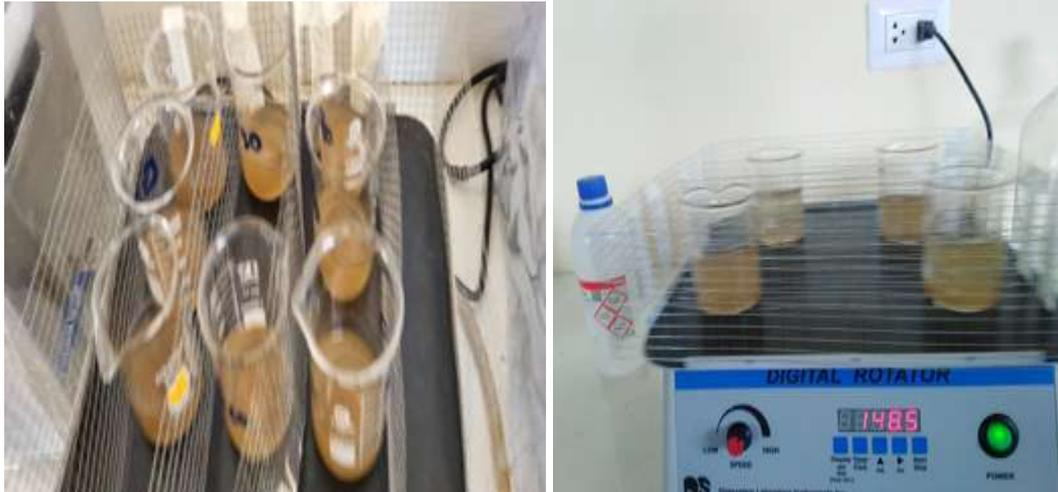
Foto 7. Proceso de determinación la capacidad de adsorción de los bioadsorbentes por el método de lotes
