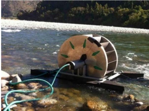
*Nota.* La figura 11 muestra el funcionamiento de una bomba Barsha tomado de aQysta BV (2012)
