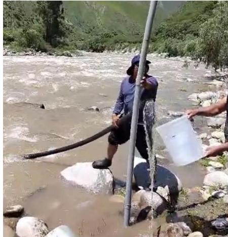
*Nota:* En la figura 112 se realiza la primera prueba con una manguera de descarga de 2" a 2 metro de altura sobre el nivel del río. Fuente elaboración propia.
