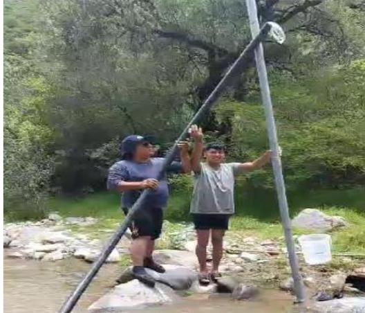
*Nota:* En la figura 116 se realiza una prueba más con una conexión a manguera de 2" a una elevación de 3 metros por encima del río.
