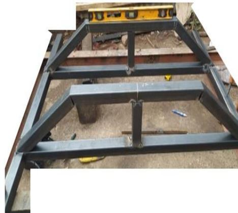
*Nota:* En la figura se observa la base en tubo cuadrado de 50x50x2mm que soportara la bomba hidráulica . Fuente elaboración propia
