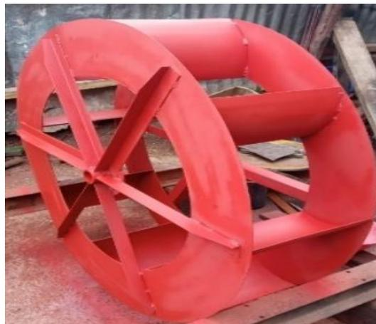
*Nota:* En la figura 103 se muestra el pintado de 2mm de espesor de la rueda hidráulica. Fuente elaboración propia
