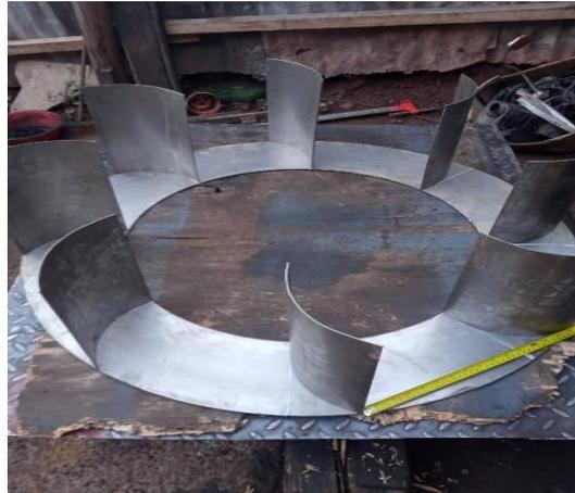
*Nota:* En la figura 102 se muestra el ensamble de los alabes por soldadura de arco eléctrico según las especificaciones del plano de rueda hidráulica BH-0002. Fuente elaboración propia.
