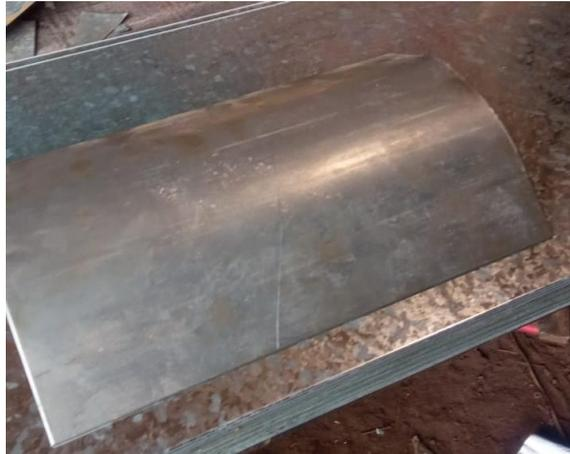
Nota: En la figura 100 se muestra el rolado de alabes de 2mm de espesor y diseñados según las especificaciones del plano de rueda hidráulica BH-0002. Fuente elaboración propia.
