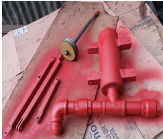
*Nota:* En la figura 106 se observa los componentes de la bomba en proceso de pintado con pintura anticorrosiva con 2 mm de espesor. Fuente elaboración propia
