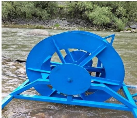
*Nota:* En la figura 110 se instala la bomba hidráulica en el río Chalhuanca en el distrito de Ihuallo, provincia de Aymaraes región Apurímac para realizar las pruebas de funcionamiento. Fuente elaboración propia.
