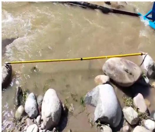
*Nota:* En la figura 111 se observa el tubo de 2 metros, material con el cual se medirá de manera empírica el caudal de río soltando la boya y cronometrando el tiempo de su recorrido, haciendo este proceso varias veces para tener una velocidad promedio. Fuente elaboración propia
