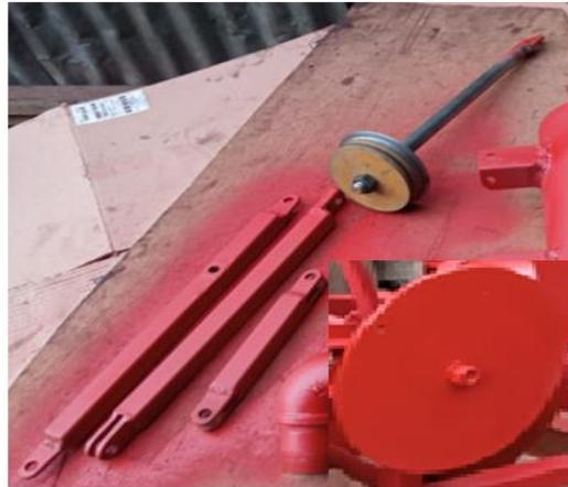
*Nota:* En la figura 104 se muestra los eslabones que corresponden al mecanismo de la bomba hidráulica dimensionados según plano BH-003. Fuente elaboración propia
