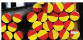
AISI / SAE 1018 - 1020 es un acero de bajo carbono que responde bien al trabajo en frío y al tratamiento térmico de cementación. Tiene un alto índice de soldabilidad, y por su alta tenacidad y baja resistencia mecánica es adecuado para elementos de maquinaria y usos convencionales de baja exigencia.
