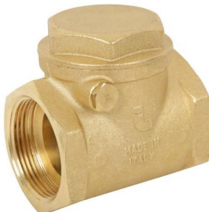
*Nota.* Válvula de descarga de 2 “ que impide el regreso del agua hacia la cámara del émbolo. Tomado de *Válvula Check Swing 1 1/2”* [Fotografía] por Sodimac, <https://sodimac.falabella.com.pe/sodimac-pe/product/113306910/Valvula-Check-Swing-1-1-2-/113306914>
