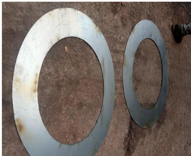
*Nota:* En la figura 99 se muestra los discos laterales de 2mm de espesor y diseñados según las especificaciones del plano de rueda hidráulica BH-0002. Fuente elaboración propia.
