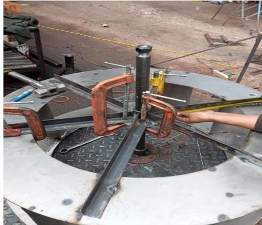
*Nota:* En la figura 101 se muestra el ensamblaje de la rueda y eje diseñados según las especificaciones del plano de rueda hidráulica BH-0002. Fuente elaboración propia.
