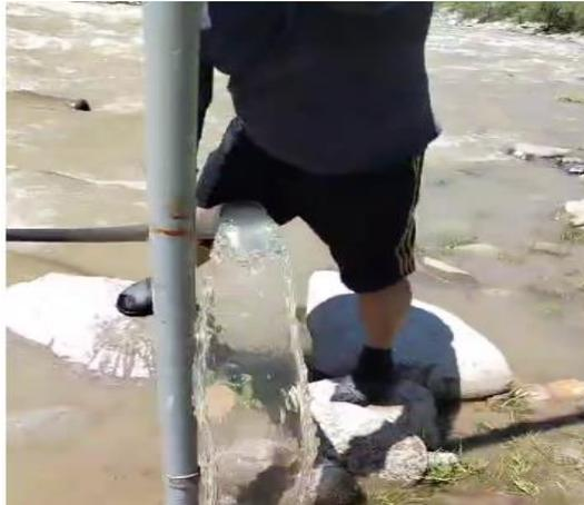
*Nota:* En la figura 114 se realiza una prueba más con una conexión a manguera de 2" a una elevación de 1 metros por encima del río, Fuente elaboración propia.
