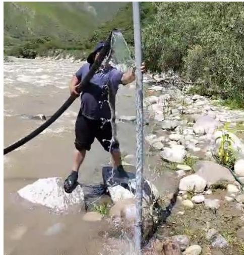
*Nota:* En la figura 113 se realiza la primera prueba con una conexión a manguera de 2" a una elevación de 2 metros por encima del río, Fuente elaboración propia.
