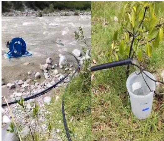
*Nota:* En la figura 117 se observa en funcionamiento la bomba hidráulica impulsando el agua desde el río hacia un árbol de palta con una conexión a manguera de 1 ½" extendida 20 metros a una elevación de 3 metros por encima del río. Fuente elaboración propia.
