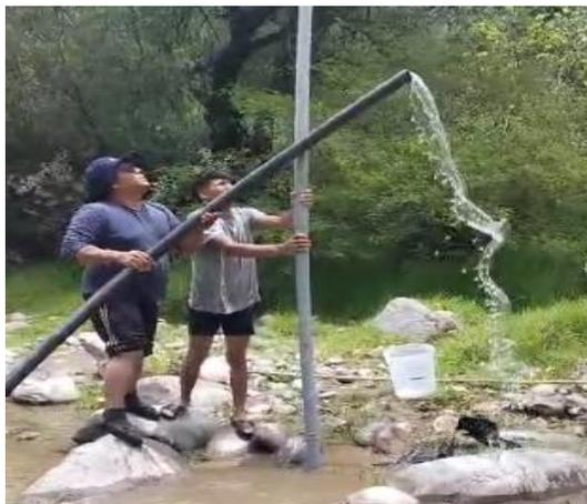
*Nota:* En la figura 115 se realiza una prueba más con una conexión a manguera de 2" a una elevación de 2 metros por encima del río. Fuente elaboración propia.
