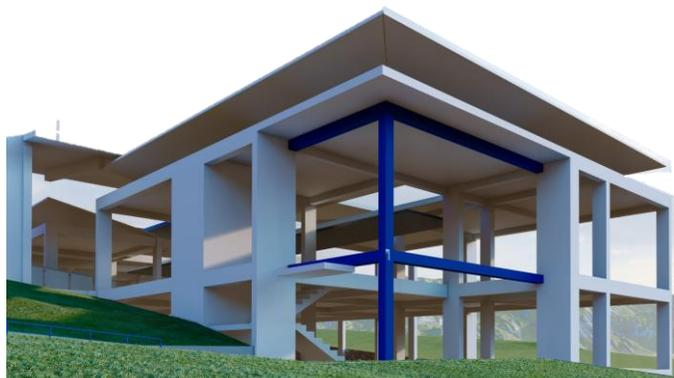
SISTEMA MIXTO: APORTICADO DE CONCRETO ARMADO – ESTRUCTURA METALICA
