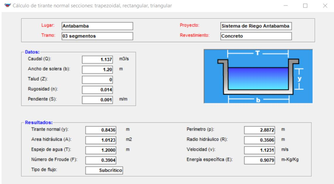
*Imagen 16.- Elementos Basicos para el Diseño de Canales (Manual Criterios de Diseño de Obras Hidraulicas – ANA) – Canal Rectangular*
