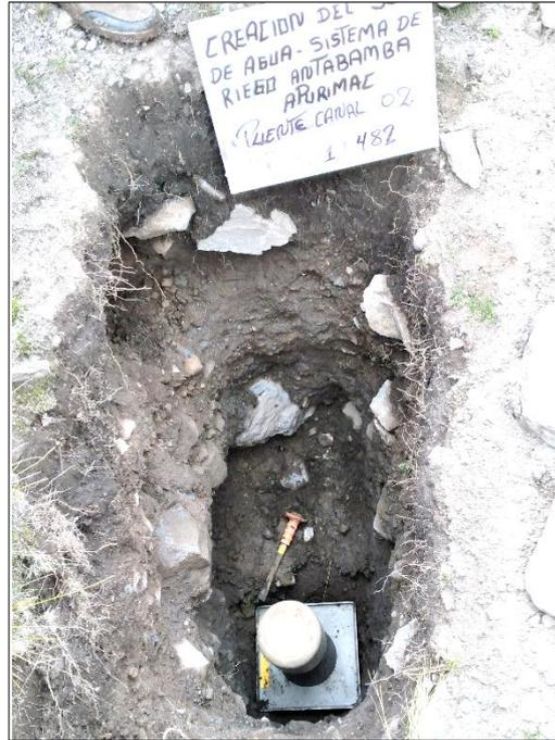
Fotografía 42.- Ensayo de Densidad en campo.
