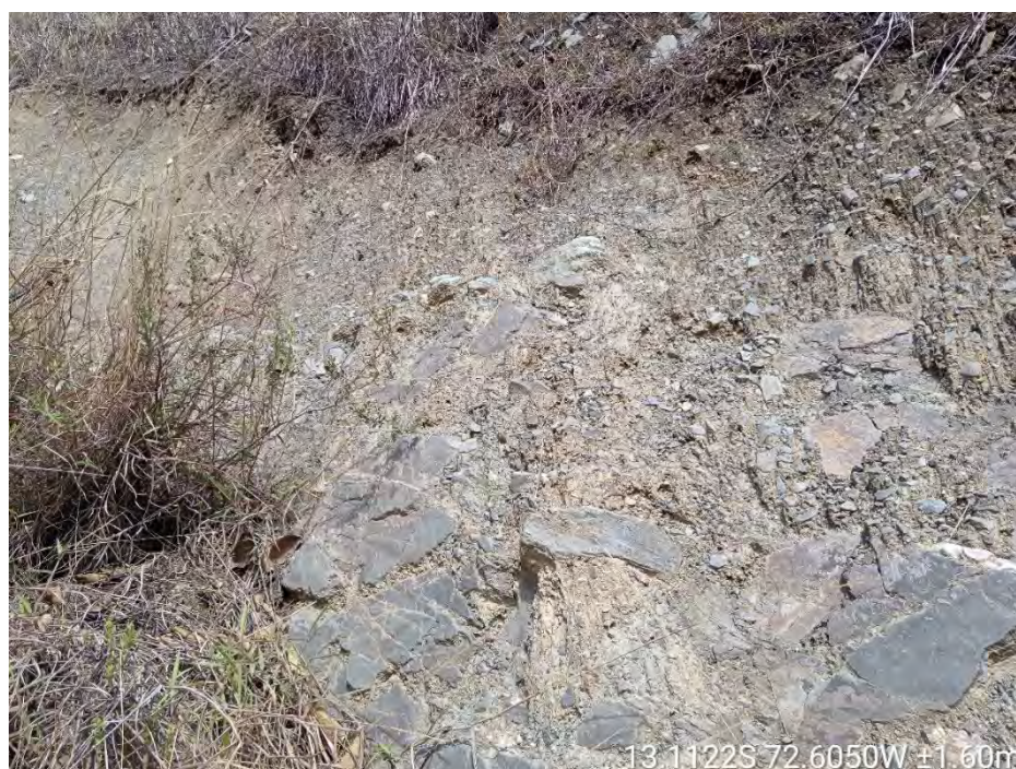
Foto 11_depósito coluvial, que supra yace sobre el macizo rocoso
