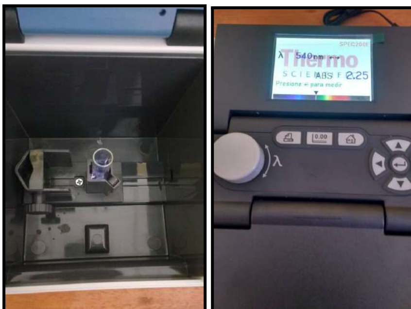
Foto 27 y 28. Lectura de NUS en el equipo de espectrofotómetro a una longitud de onda: 540 nm.
