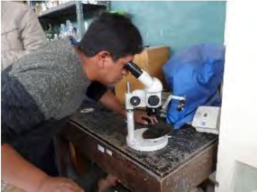
Fotografía 24. Observación del concentrado después del plateado con ayuda del microscopio estereoscópico
