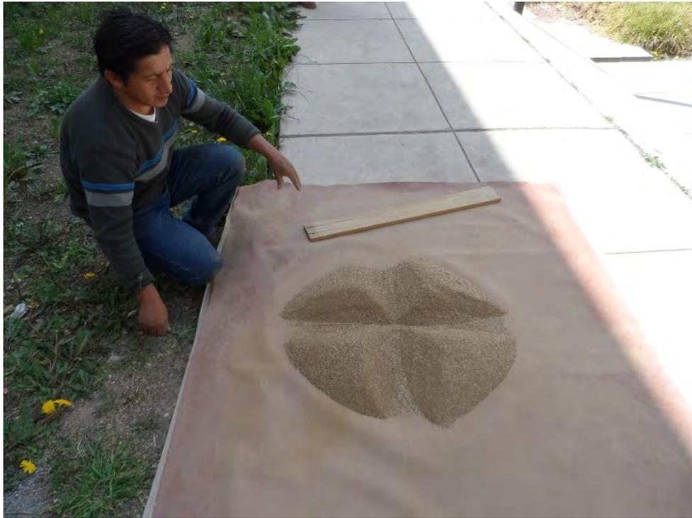
Fotografía 18. Muestras de mineral listas para las pruebas experimentales
