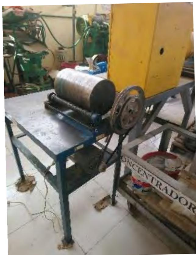
Fotografía 15. Descarga del molino de bolas del laboratorio de procesamiento de minerales de la UNSAAC
