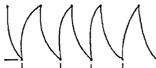
Figura 26.- Movimiento en forma de zig - zag al soldar
